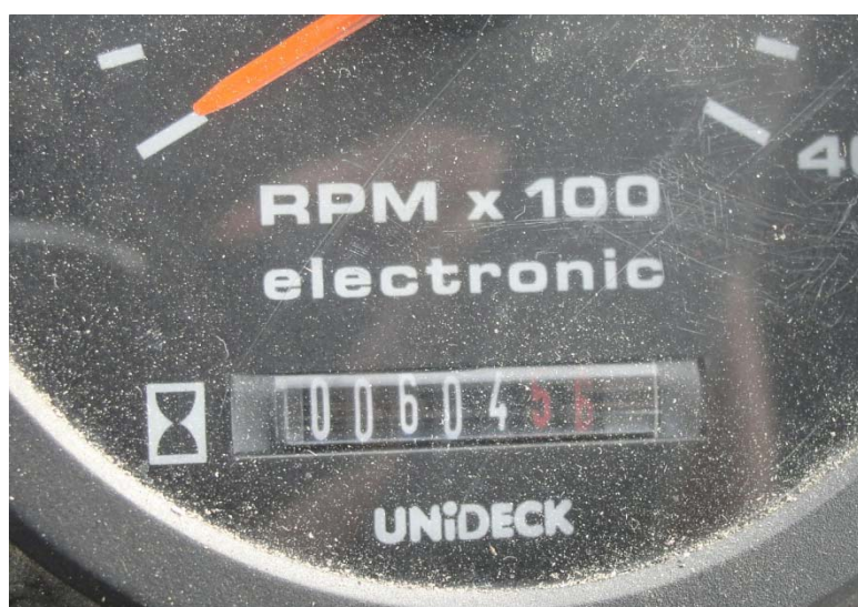
Slika 97: Novorazvijeni traktor EcoTRAC 120MV –pokazivač odrađenog vremena
