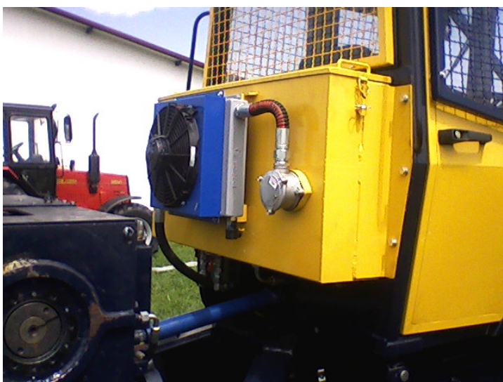
Slika 90: Vitlo – spremnik hidrauličke tekućine s hladnjakom
