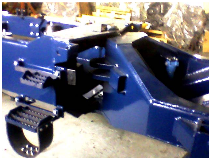
Slika 29: Spoj šasije u vertikalnom zglobu
