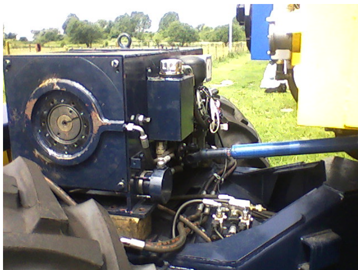
Slika 89: Vitlo – hidraulički sustav i kardansko vratilo
