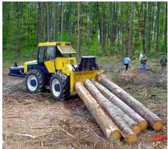
Slika 21: Šumski zglobni traktor EcoTRAC 120V
