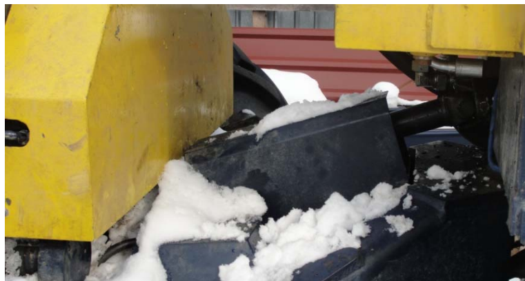
Slika 95: Novorazvijeni traktor EcoTRAC 120MV nakon 605 sati probnog rada – kardansko vratilo za pogon vitla zaštićeno poklopcem (vidljiv zglob vratila ispod rezervoara hidrauličke tekućine)
