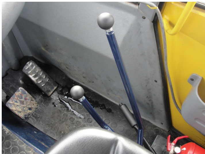
Slika 98: Novorazvijeni traktor EcoTRAC 120MV –poluge za upravljanje radom vitla (manja za odabir brzine ili isključenje pogona za kretanje traktora, veća za uključenje pogona vitla)
