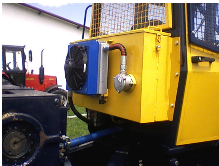
Slika 90: Vitlo – spremnik hidrauličke tekućine s hladnjakom
