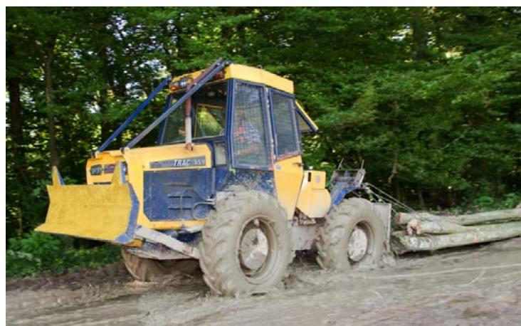
Slika 17: Šumski zglobni traktor s vitlom - Hittner EcoTRAC 55V
