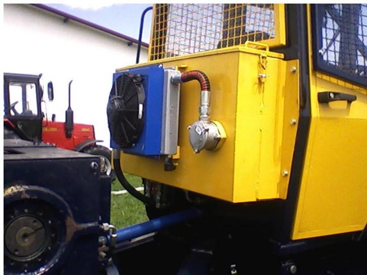
Slika 90: Vitlo – spremnih hidrauličke tekućine s hladnjakom
