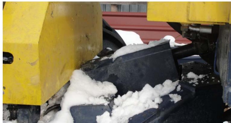
Slika 95: Novorazvijeni traktor EcoTRAC 120MV nakon 605 sati probnog rada – kardansko vratilo za pogon vitla zaštićeno poklopcom (vidljiv zglob vratila ispod rezervoara hidrauličke tekućine)
