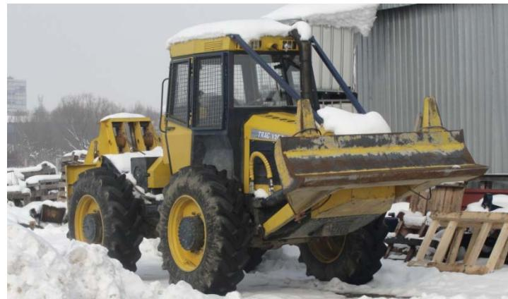
Slika 92: Novorazvijeni traktor EcoTRAC 120MV (mehanički pogon vitla) nakon 605 sati probnog rada
