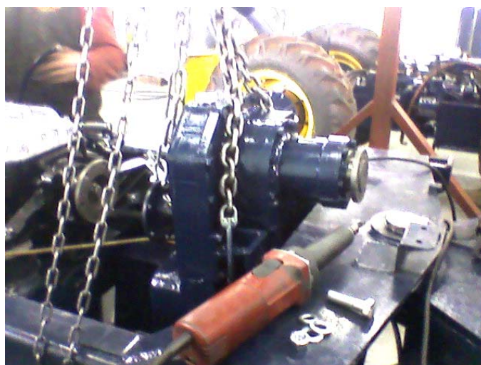
Slika 81: Motaža razvodnika pogona
