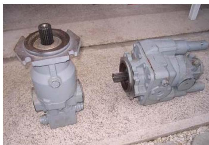
Slika 25: Hidromotor u dosadašnjoj izvedbi traktora
