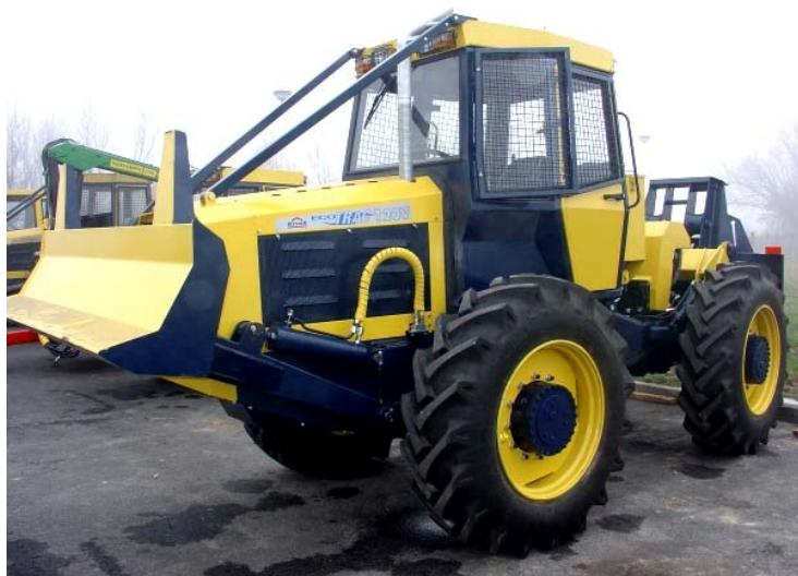
Slika 18 – Šumski zglobni traktor s vitlom – Hittner EcoTRAC 120V
