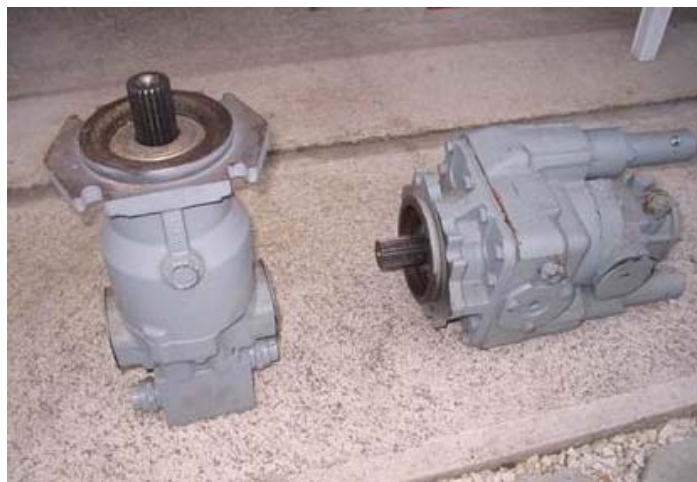
Slika 25: Hidromotor u dosadašnjoj izvedbi traktora
