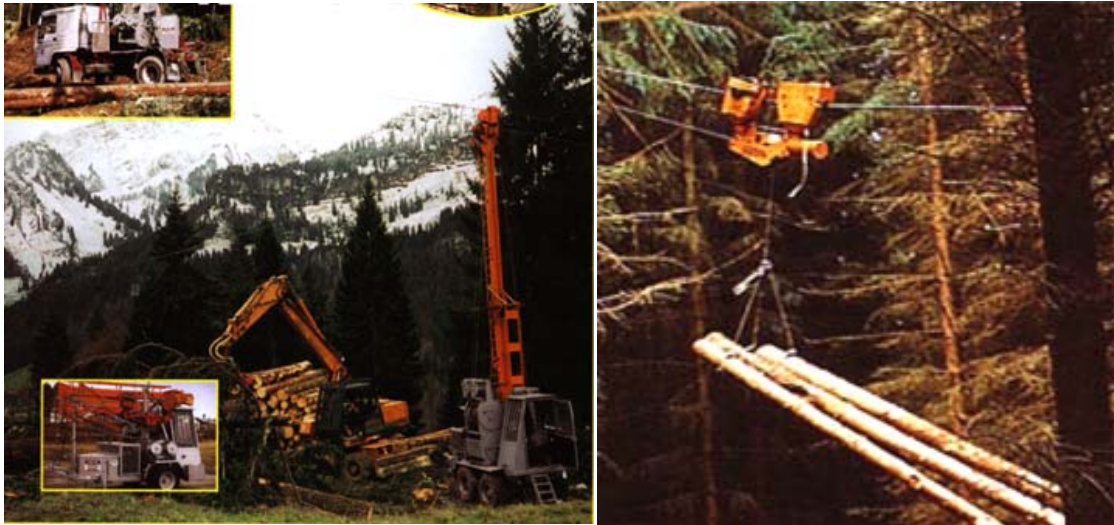
Slika 10: Montažno postrojenje žičare za transport trupaca
