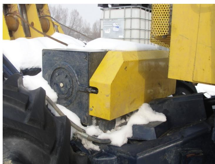
Slika 94: Novorazvijeni traktor EcoTRAC 120MV nakon 605 sati probnog rada – vitlo (žuti zaštitni poklopac hidrauličkog sustava i plavi zaštitni lim kardanskog vratila), užad u vodilicama (gore lijevo), kabina (gore desno)
