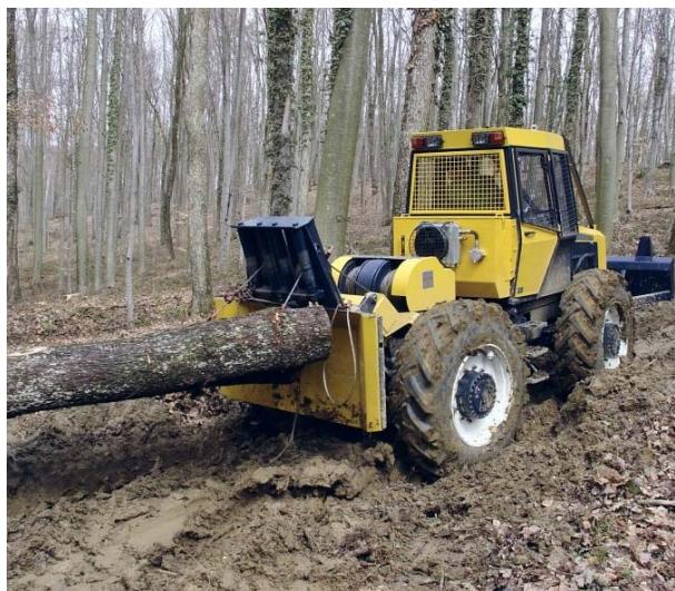
Slika 20: Šumski zglobni traktor EcoTRAC 120V
