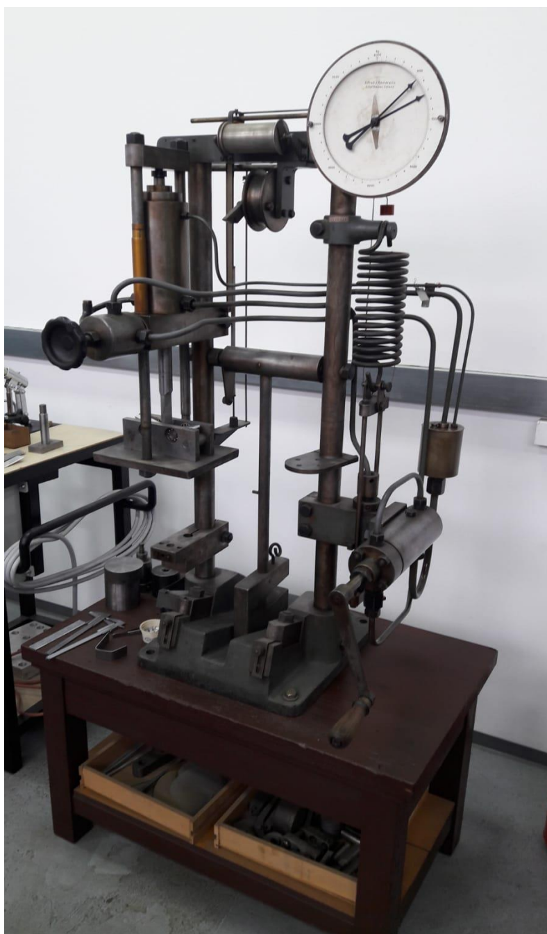
Slika 33. Uređaj za savijanje u prostorijama Laboratorija
