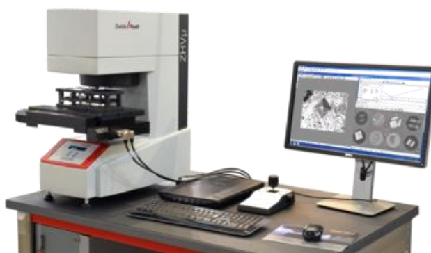
Slika 19. ZHV \mu tvrdomjer postavljen s računalom [16]
