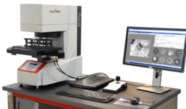
Slika 19. ZHV \mu tvrdomjer postavljen s računalom [16]
