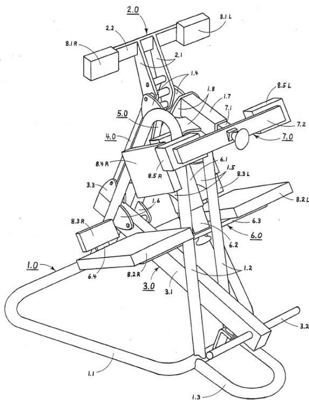
Slika 5.6 US Patent 4,757,991 – izolacijska sprava za jačanje m. latissimus dorsi – nacrt
