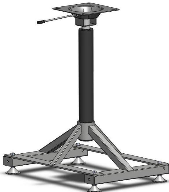
Slika 9.9 Postolje, cilindar i mehanizam sa ručicom
