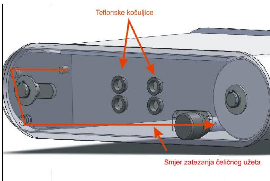
Slika 9.27 Shematski prikaz smjera zatezanja čeličnog užeta
