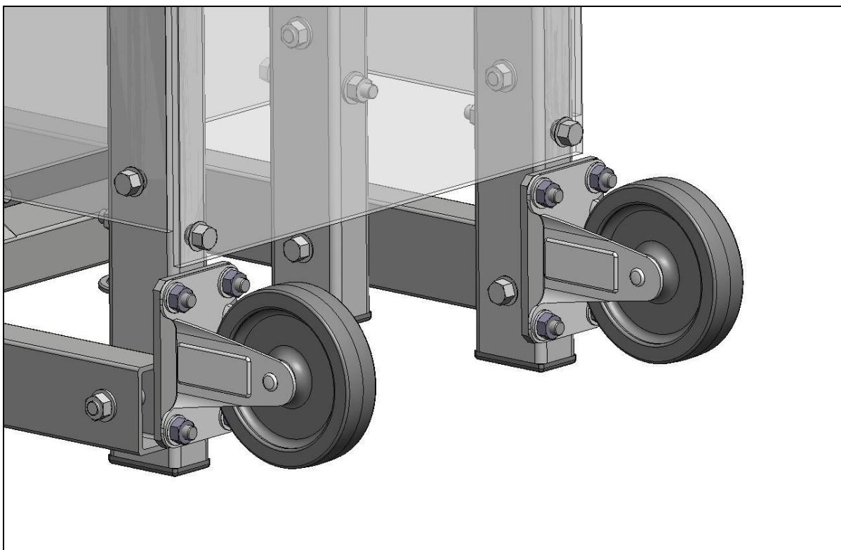
Slika 9.14 Kotači na kaveznoj konstrukciji
