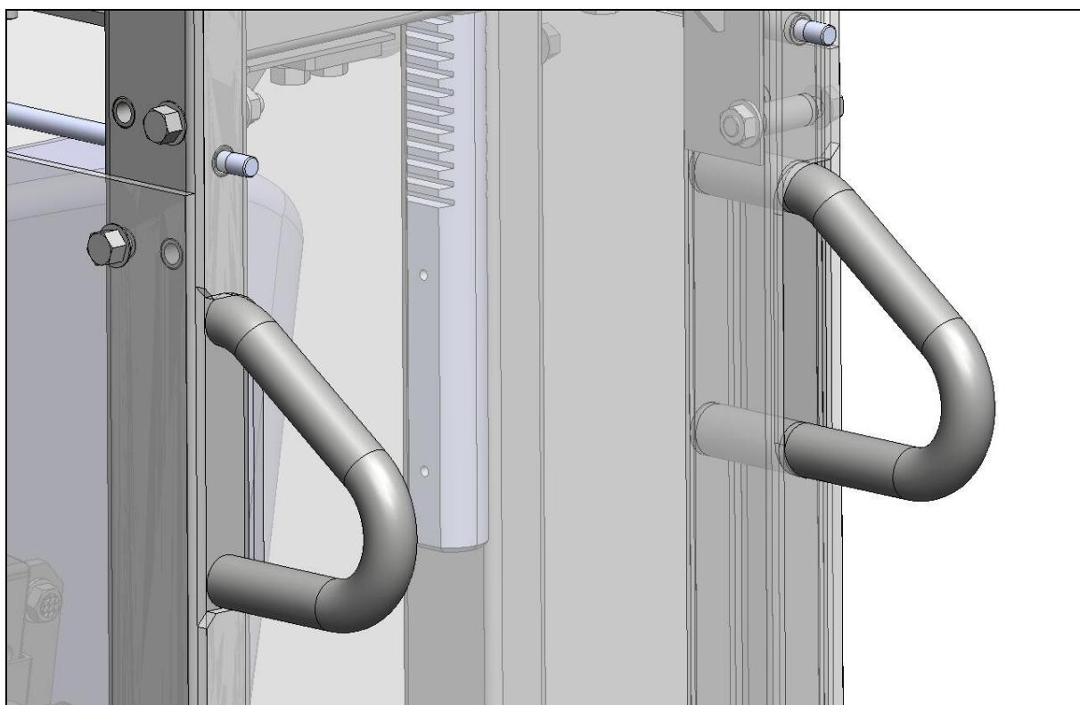
Slika 9.15 Ručke na kaveznoj konstrukciji
