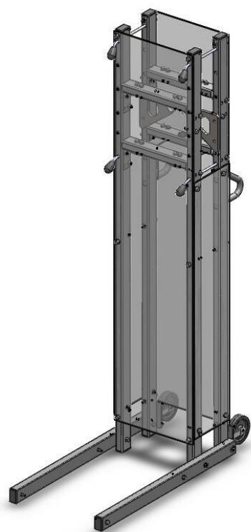
Slika 9.12 Kavezna nosiva konstrukcija
