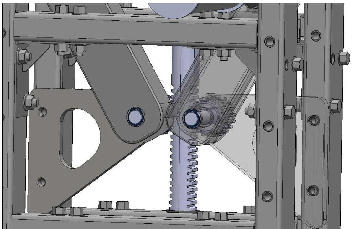
Slika 9.22 Konceptualno rješenje spoja poluge za prijenos opterećenja na zupčanik
