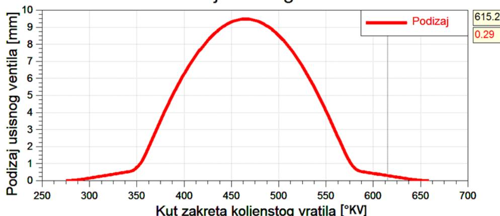
**Slika 7. Profil podizaja usisnog ventila.**
