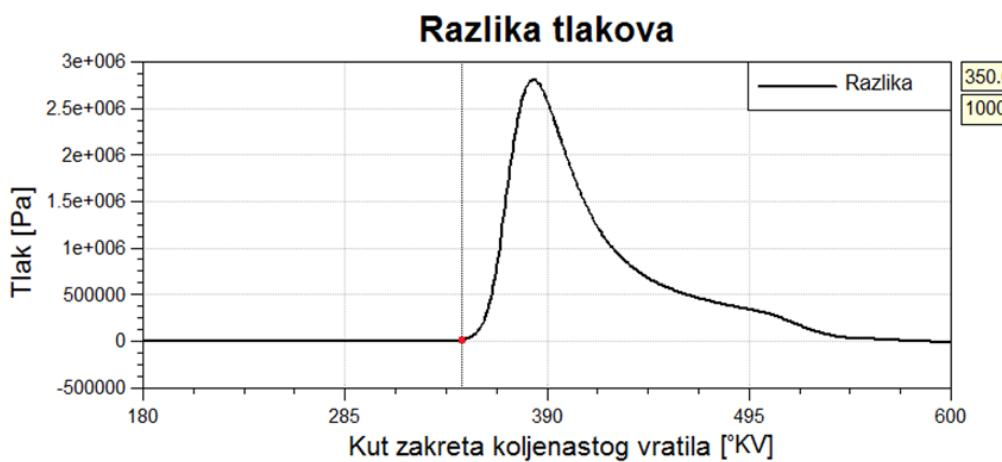
**Slika 18.** Određivanje zakašnjenja paljenja za točku 12.
