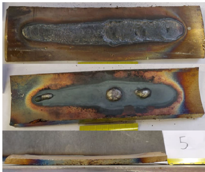
Slika 19. Uzorak 5 ( I = 175 \text{ A} , U = 14,6 \text{ V} )
