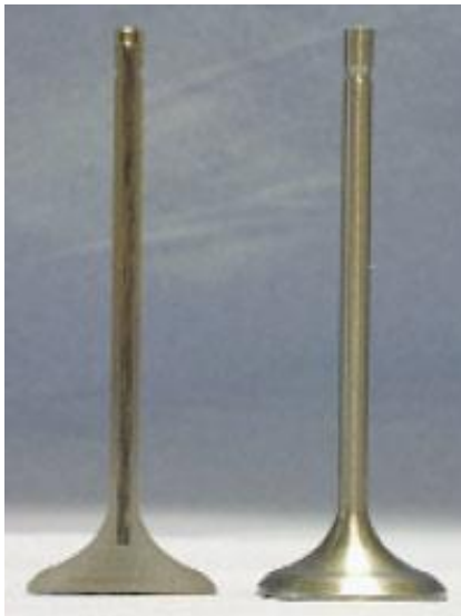
Slika 8. Ventili automobilskog motora od Ti matrice ojačane SiC česticama [9]
