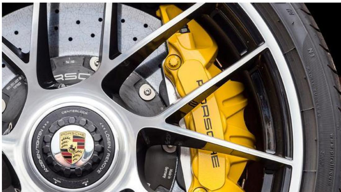
**Slika 7. Kočni diskovi Porsche-a 911 Turbo napravljeni od kompozita sa SiC matricom ojačanom ugljičnim vlaknima [11]**
