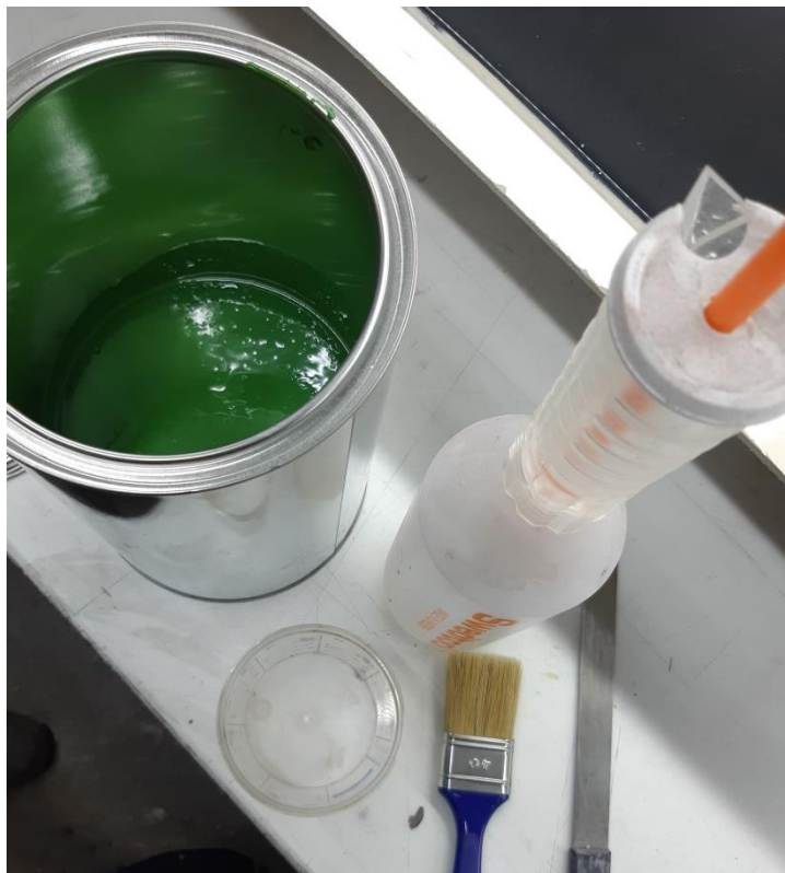
Slika 27. Korišteni materijali i alati za nanošenje gel-premaza
