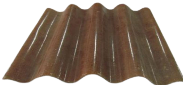
Slika 6. Krov s ojačalom od bambusa [13]
