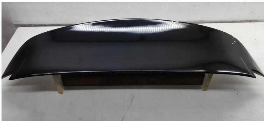
Slika 21. Prototip produženog spojlera za Hondu Civic EG
