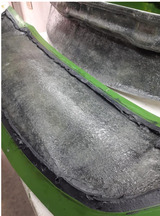
Slika 40. Umetanje otpreska natrag u kalup
