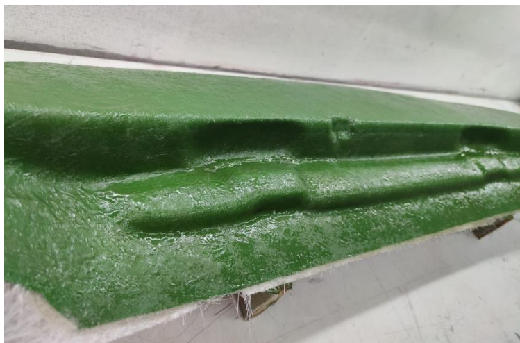
Slika 32. Donja strana prototipa spremna za laminiranje
