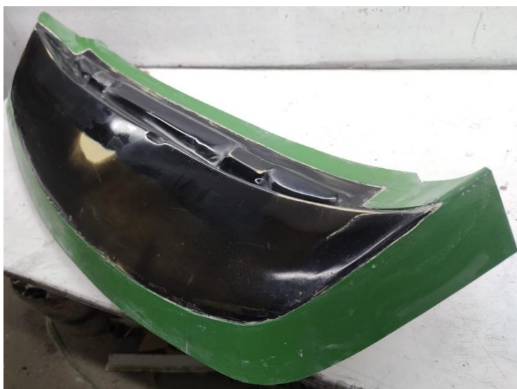
Slika 32. Donja strana prototipa spremna za laminiranje
