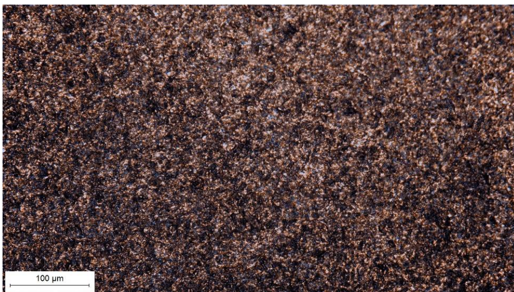
Slika 41. Trošene površine uzoraka C1 od čelika K390 MC snimljene na svjetlosnom mikroskopu
