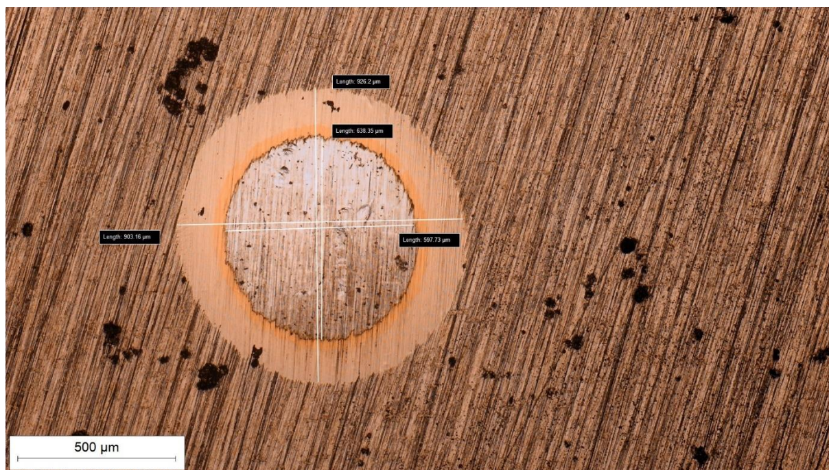
Slika 35. Trag trošenja na čeliku K110 snimljen na svjetlosnom mikroskopu nakon ispitivanja debljine prevlake metodom utiskivanja kuglice na uzorku D3 s TiN/TiBN prevlakom
