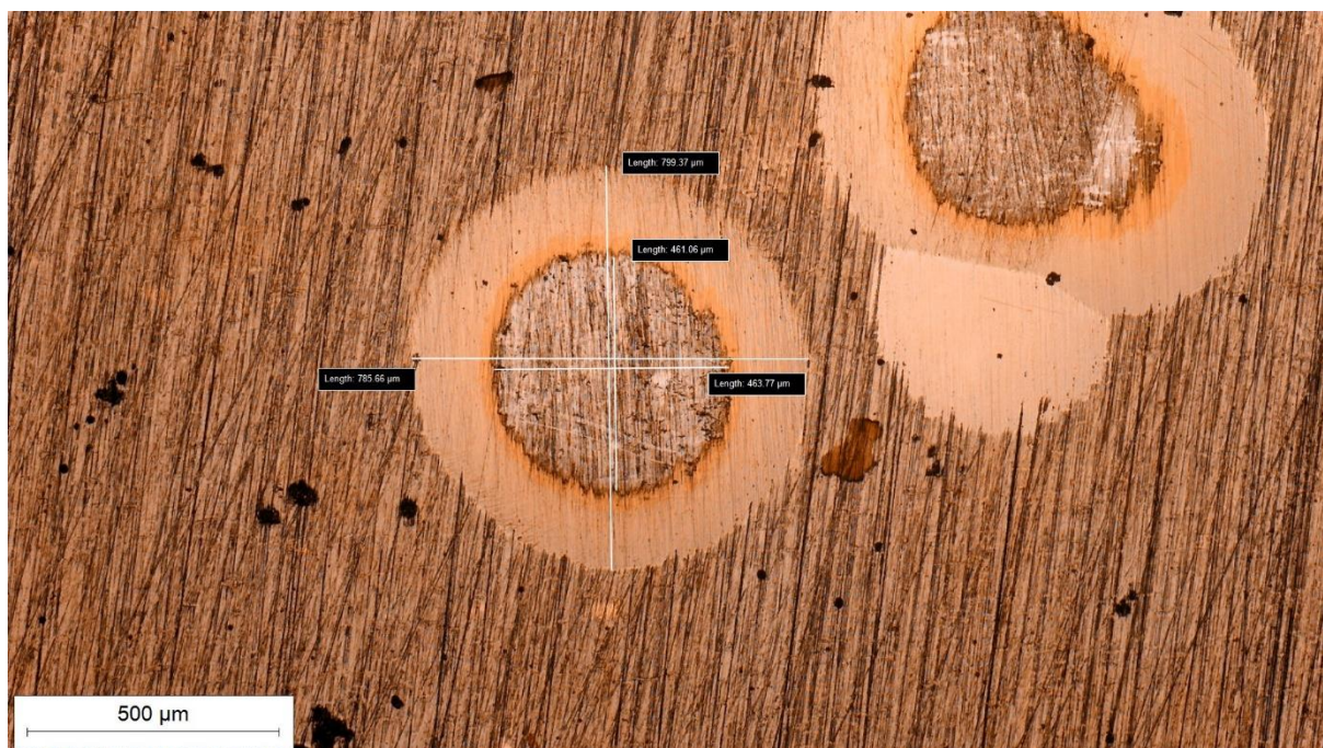
Prilog 2.3. Trag trošenja na čeliku K110 snimljen na svjetlosnom mikroskopu nakon ispitivanja debljine prevlake metodom utiskivanja kuglice na uzorku D3 s TiN/TiBN prevlakom
