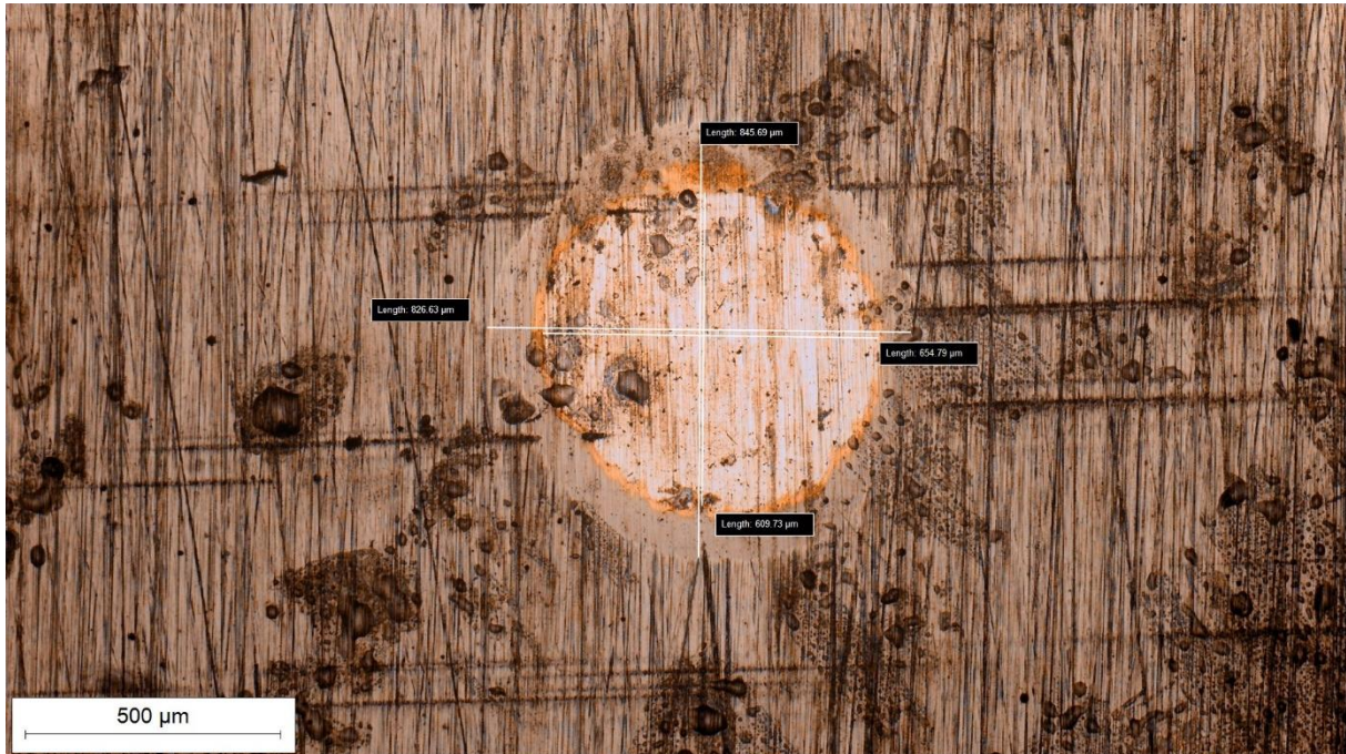
Prilog 2.3. Trag trošenja na čeliku K390 snimljen na svjetlosnom mikroskopu nakon ispitivanja debljine prevlake metodom utiskivanja kuglice na uzorku C2 s TiN/TiCN prevlakom
