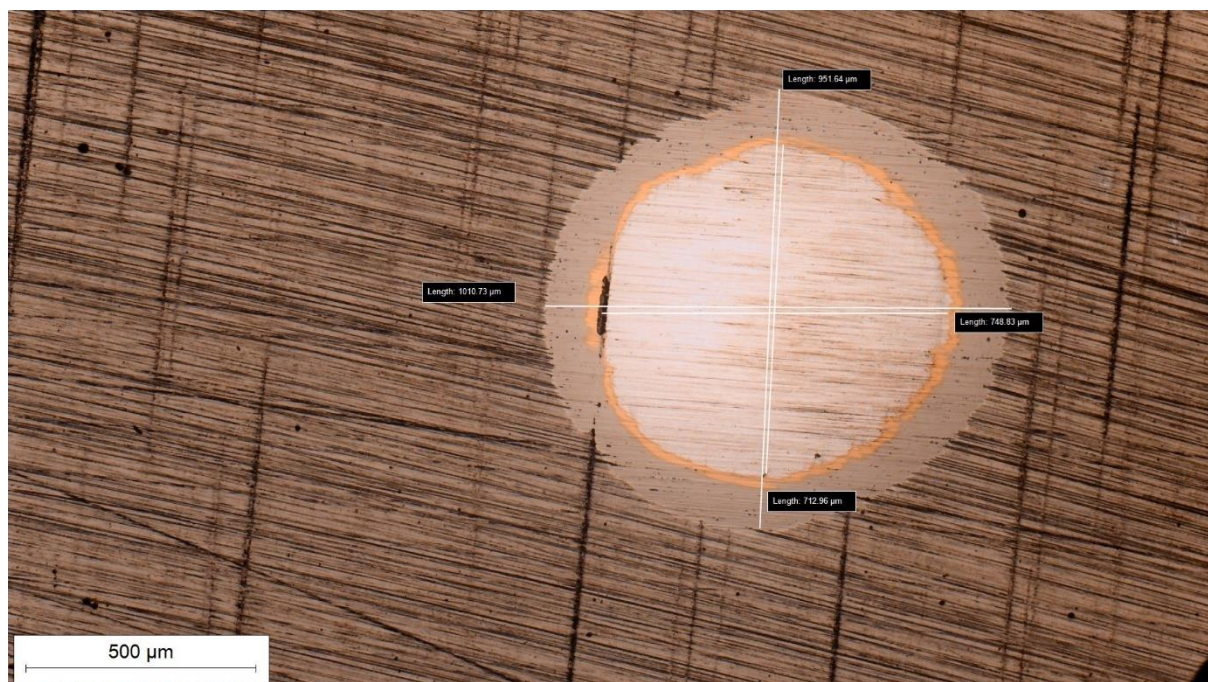
Slika 36. Trag trošenja na čeliku K390 MC snimljen na svjetlosnom mikroskopu nakon ispitivanja debljine prevlake metodom utiskivanja kuglice na uzorku C2 s TiN/TiCN prevlakom
