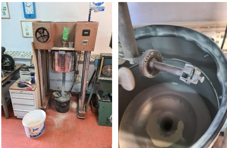
Slika 23. Uređaj za ispitivanje otpornosti na eroziju; a) izgled uređaja, b) uzorak u držaču
