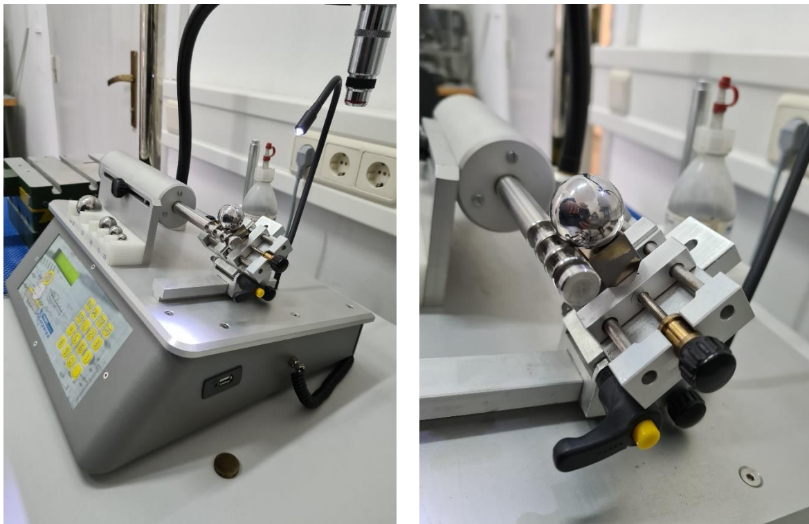
Slika 26. Uređaj TRIBOtechnic Calotester s prikazom kuglice
