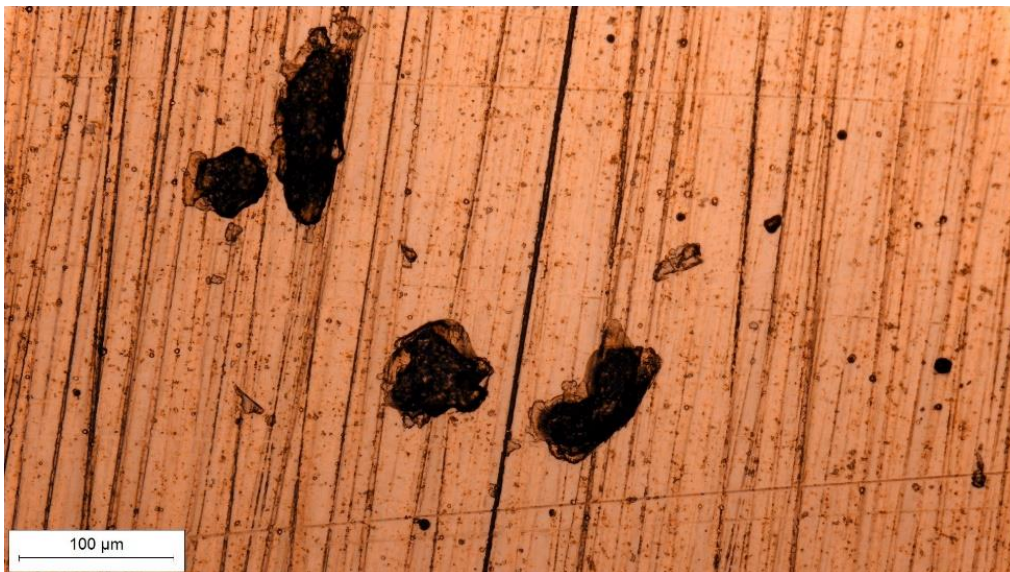
Slika 43. Trošene površine uzoraka C3 od čelika K390 MC snimljene na svjetlosnom mikroskopu
