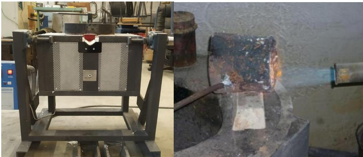
**Slika 42. Elektrootporna peć i zagrijavanje ljevačkog lonca**
