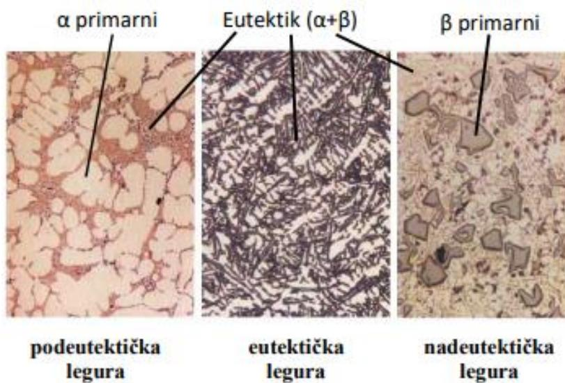
**Slika 14.** Podjela Al-Si legura s pripadajućim mikrostrukturama [7]
