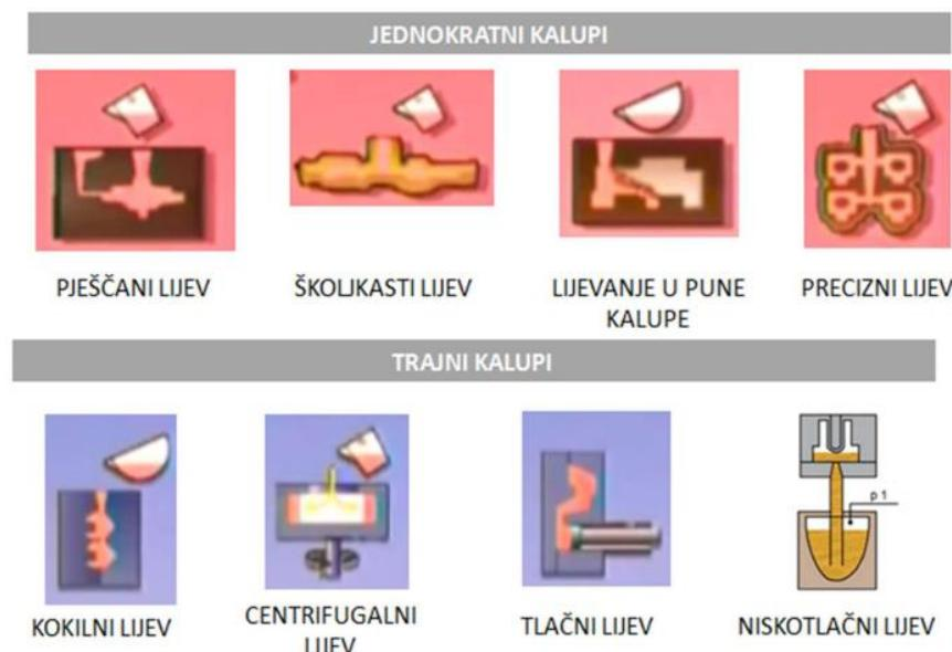
**Slika 2. Podjela postupaka lijevanja prema vrsti kalupa [7]**
