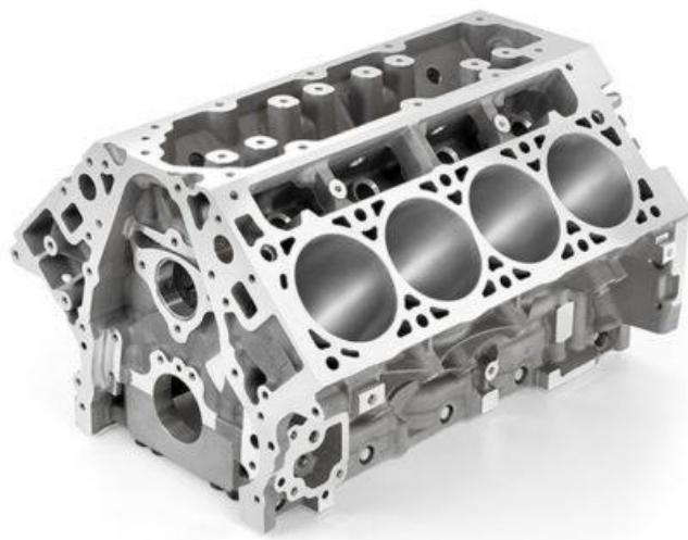
Slika 3. Blok motora [8]
