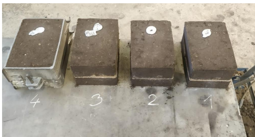
Slika 45. Kalupi nakon skrućivanja odljevka
