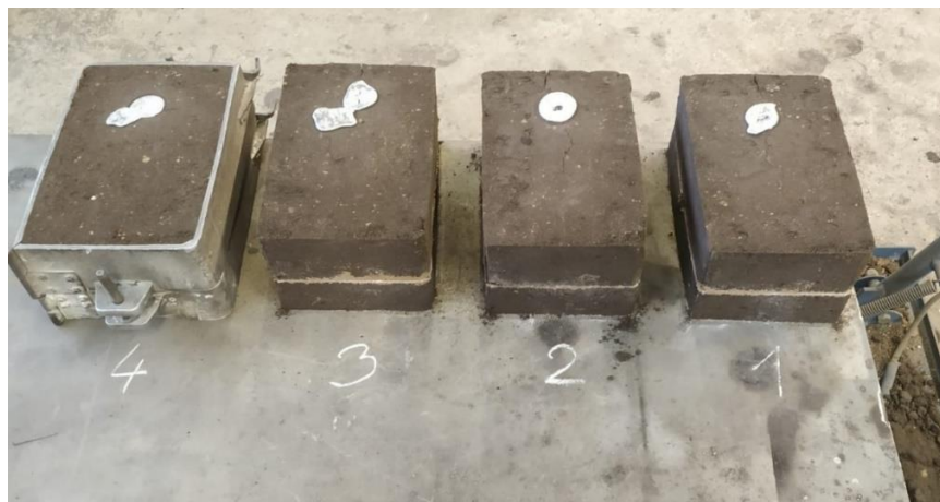
Slika 45. Kalupi nakon skrućivanja odljevka
