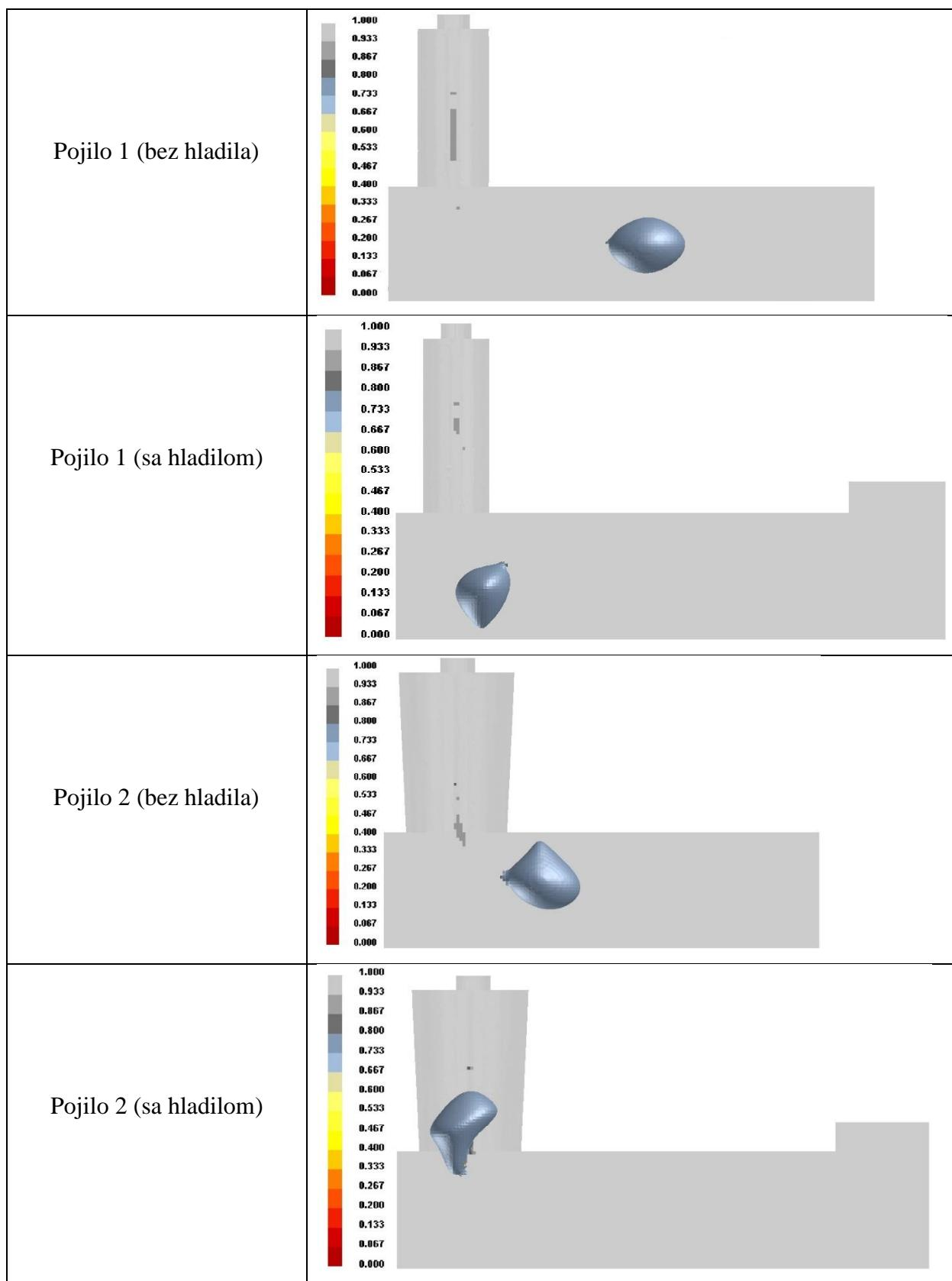
U tablici 7. su prikazani postotci skrućivanja u vremenu 220 sekundi nakon ulijevanja, za pojilo 1 (bez hladila), pojilo 1 (sa hladilom), pojilo 2 (bez hladila) i pojilo 2 (sa hladilom). Vidljivo je kako se dodavanjem hladila znatno ubrzava proces skrućivanja odljevka.
