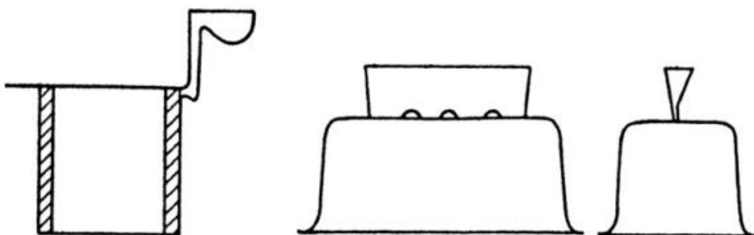
**Slika 9. Direktni uljevni sustav sa ušćem odozgo [4]**
