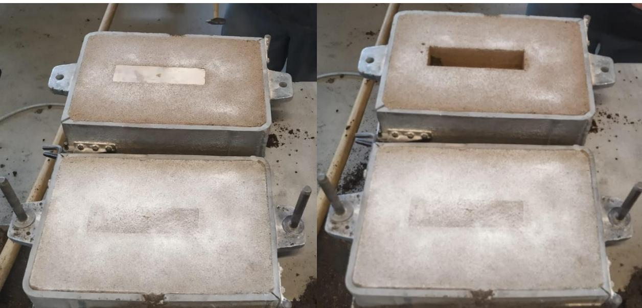
**Slika 40.** Otvaranje kalupa i uklanjanje modela
