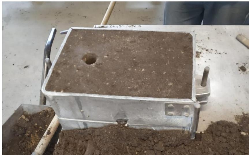
Slika 41. Zatvaranje kalupa
