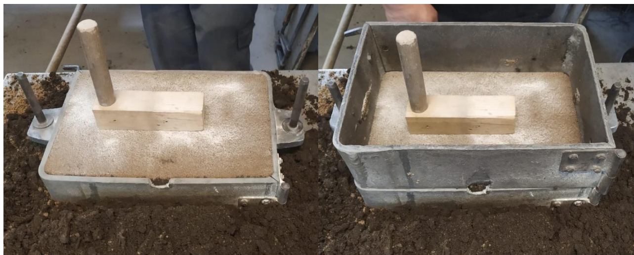
Slika 37. Postavljanje modela u gornjak
