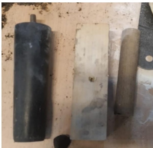
Slika 33. Modeli korišteni za izradu kalupa
