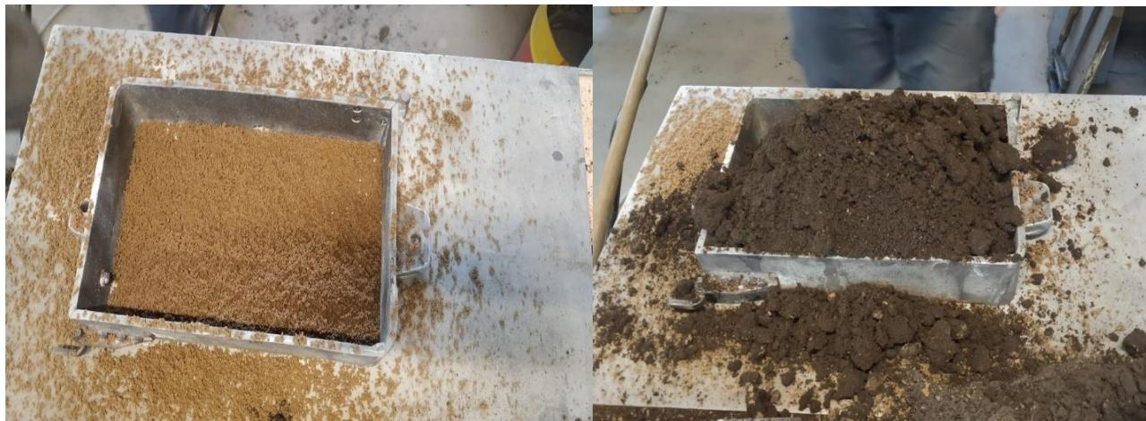
Slika 35. Dodavanje modelne i punidbene kalupne mješavine
