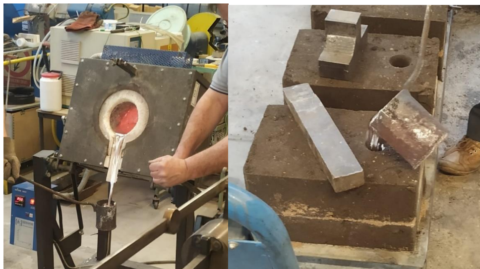
Slika 44. Ulijevanje taljevine u kalup
