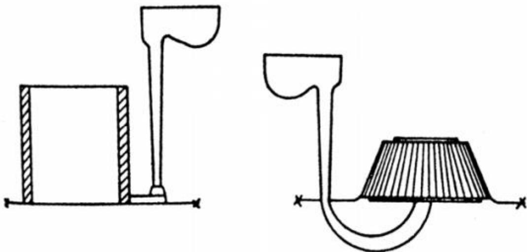
Slika 11. Uljevni sustav sa ušćem odozdo [4]
