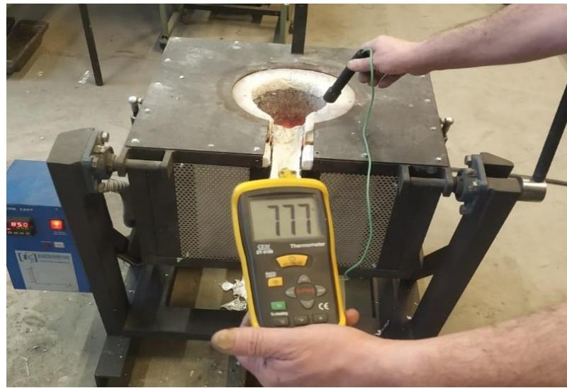
**Slika 43. Mjerenje temperature taljevine pirometrom**
