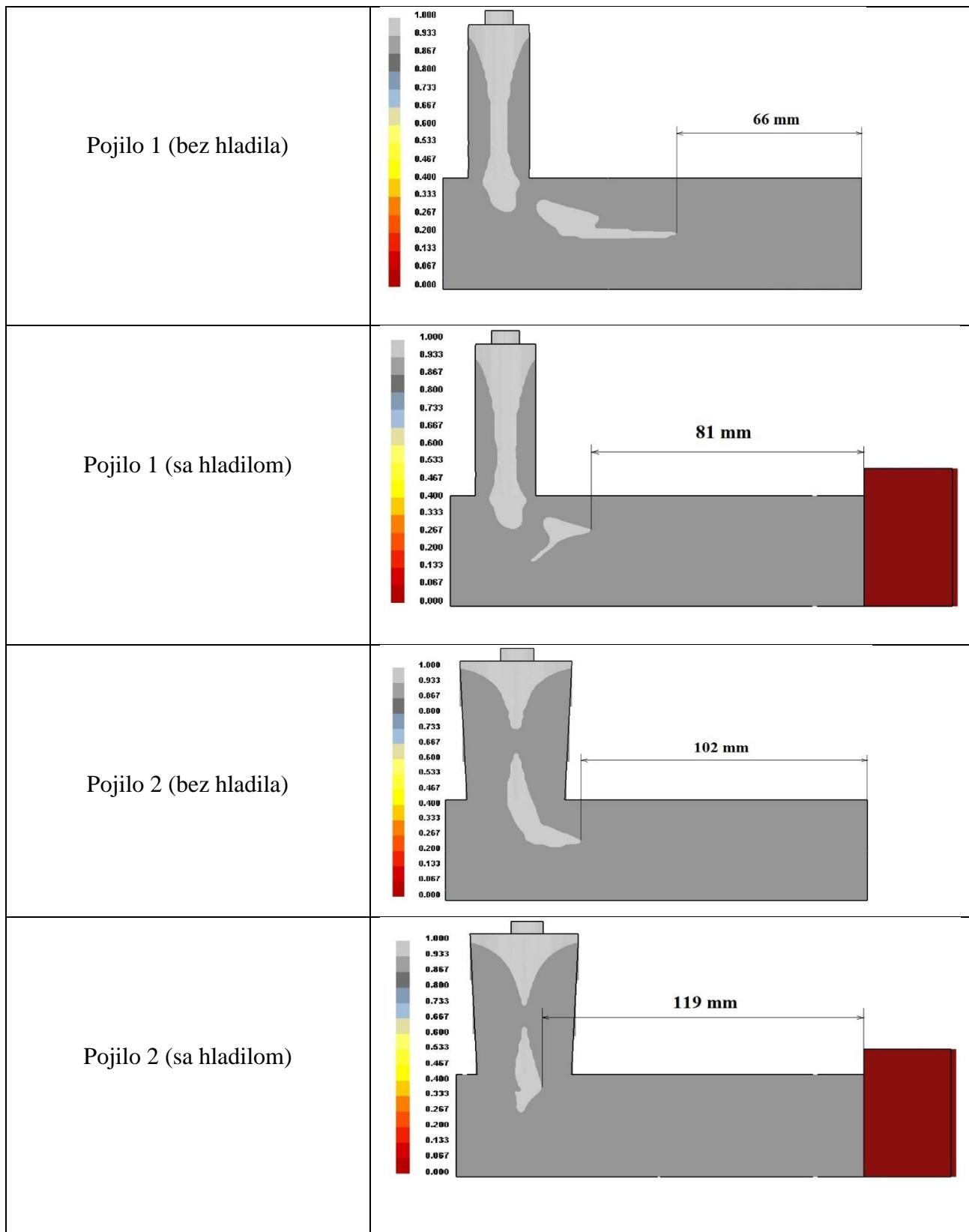
Korištenjem hladila zona napajanja povećala se za 15 mm, korištenjem većeg pojila zona napajanja povećala se za 36 mm, a korištenjem većeg pojila i hladila zona napajanja povećala se za 53 mm.
