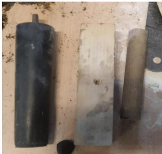
Slika 33. Modeli korišteni za izradu kalupa
