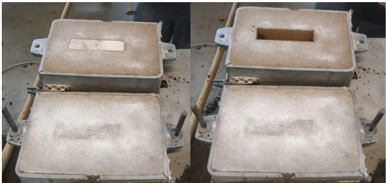
Slika 40. Otvaranje kalupa i uklanjanje modela
