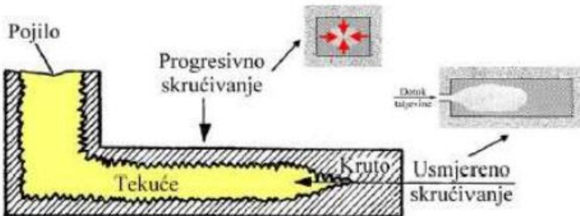
Slika 16. Shematski prikaz usmjerenog i progresivnog skrućivanja [7]
