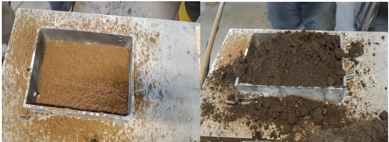
Slika 35. Dodavanje modelne i punidbene kalupne mješavine
