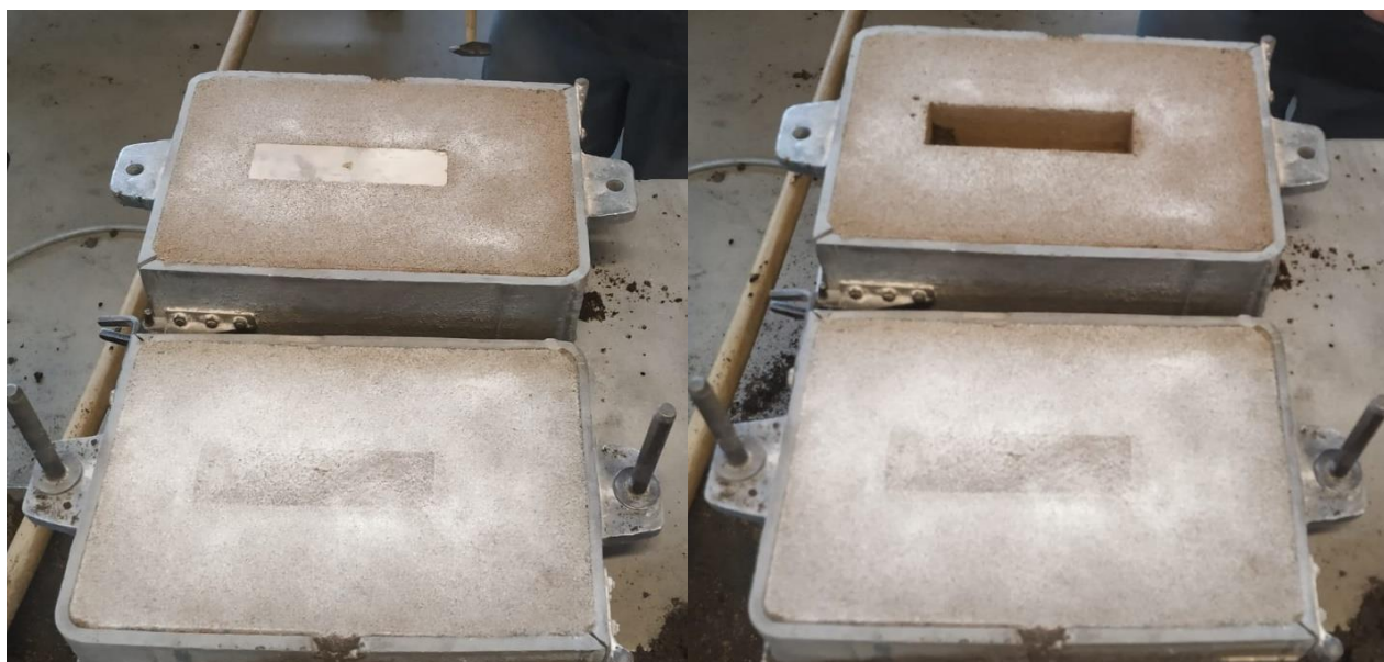
Slika 40. Otvaranje kalupa i uklanjanje modela
