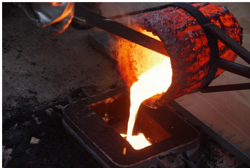
Slika 6. Primjer ulijevanja litine u jednokratni pješčani kalup [10]
