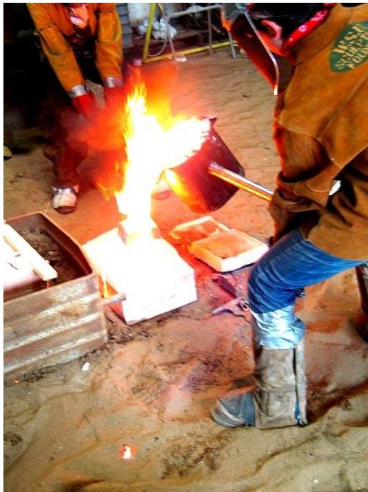
Slika 1. Lijevanje metala u kalup [5]
