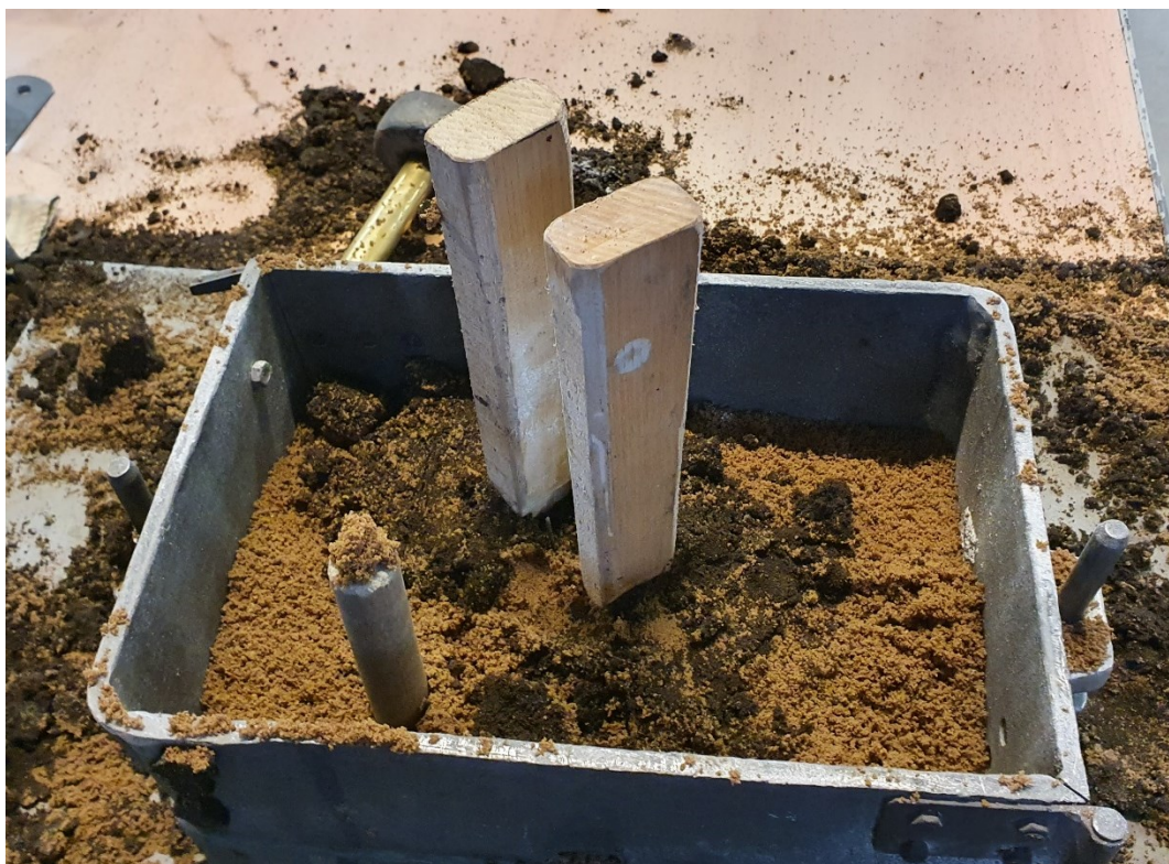
Slika 32. Postavljanje pojila i dodavanje punidbene kalupne mješavine
