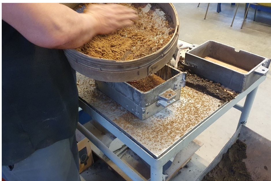
Slika 27. Nasipavanje modelnom kalupnom mješavinom
