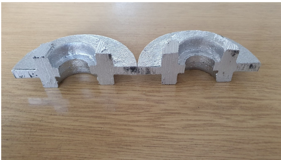
Slika 56. Poprečni presjek odljevka od legure AlSi7Mg
