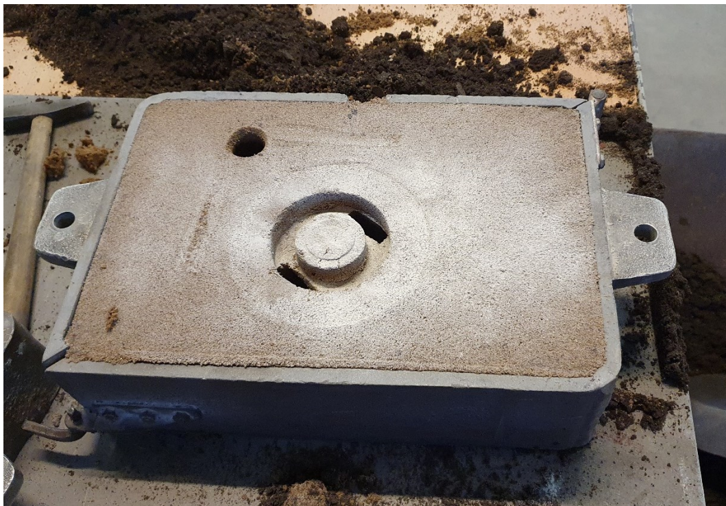
Slika 36. Gornjak nakon otvaranja kalupa
