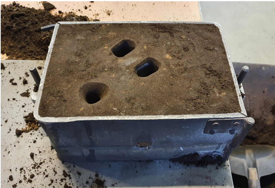
Slika 35. Izrada uljevne čaše i skošavanje rubova pojila
