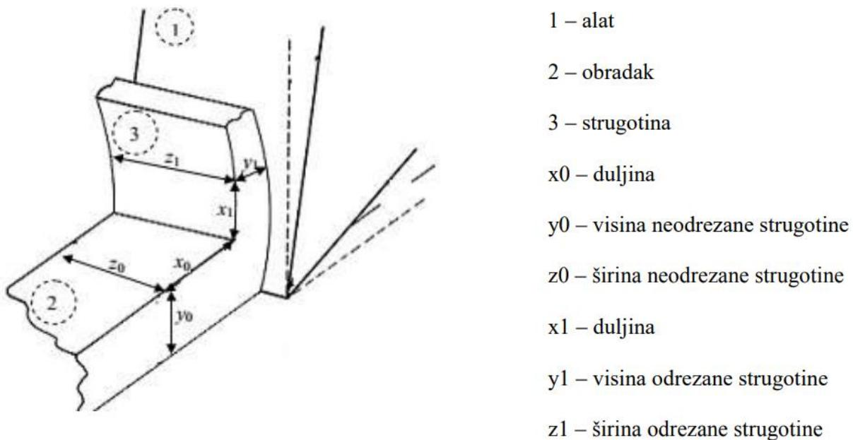
Slika 10. Shematski prikaz ortogonalnog rezanja [14]
