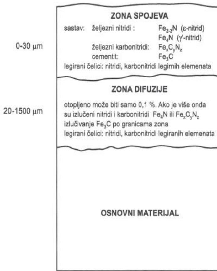
Slika 2. Shematski prikaz površinskog sloja dobivenog nitriranjem [4]
