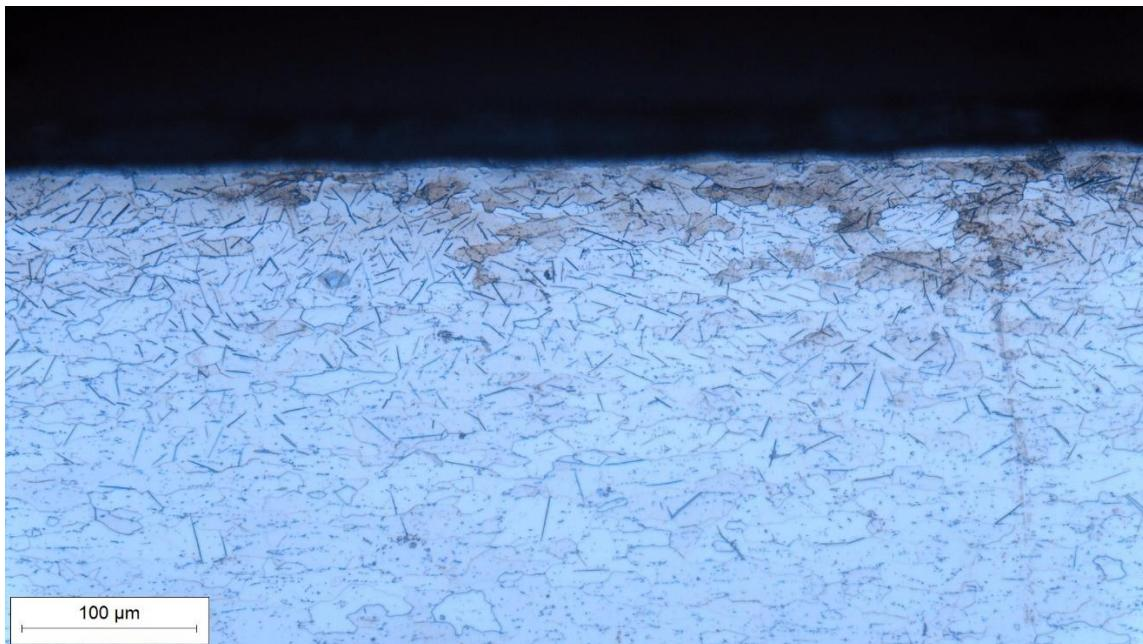
Slika 23. Prikaz QPQ obrade, povećanje 200x
