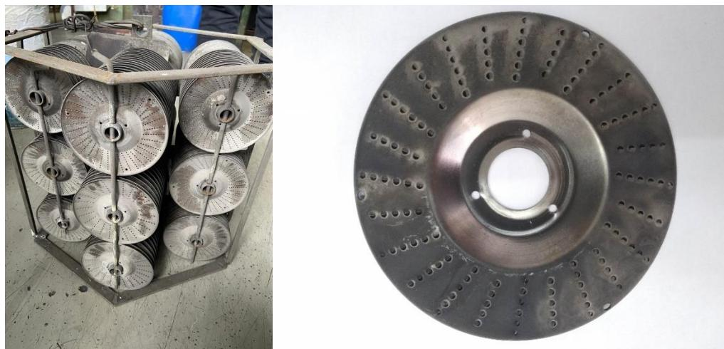
Slika 16. Izgled površine nakon nitriranja
