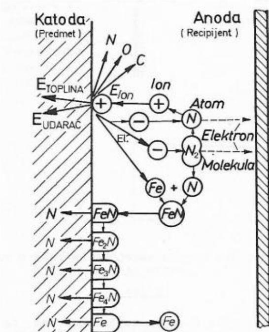
Slika 4. Shematski prikaz nitriranja u plazmii [8]
