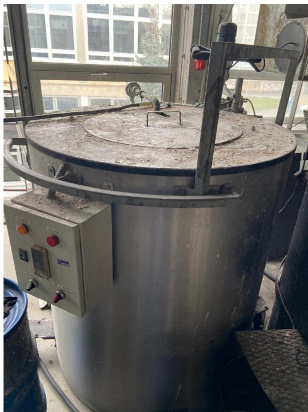
Slika 17. Jamska peć za naknadnu oksidaciju
