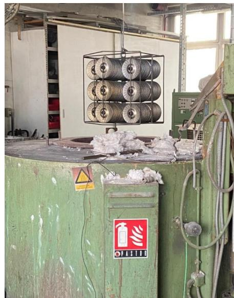
Slika 12. jamske peći „Borel GmbH“
