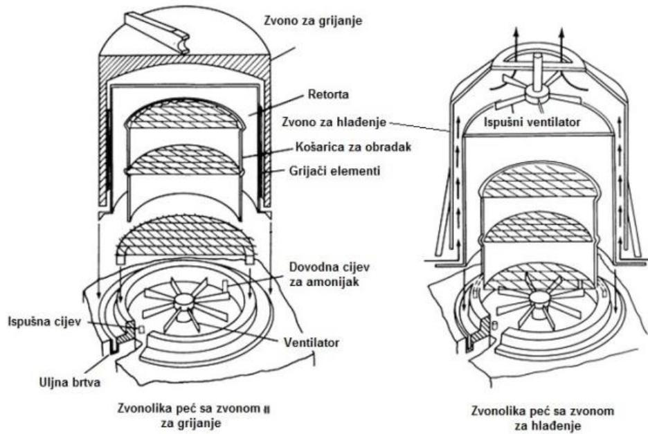
Slika 3. Shema zvonolike peći za plinsko nitriranje [6]
