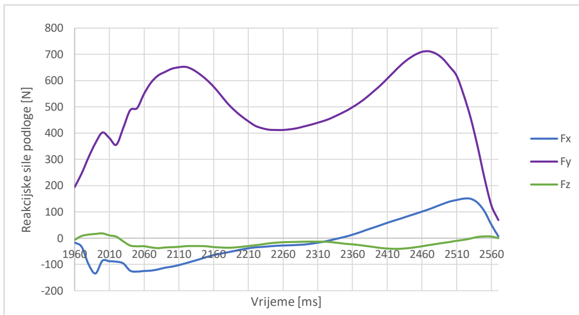
Slika 22. Dijagram ovisnosti komponenta reakcijske sile podloge ( F_x , F_y , F_z ) o vremenu
