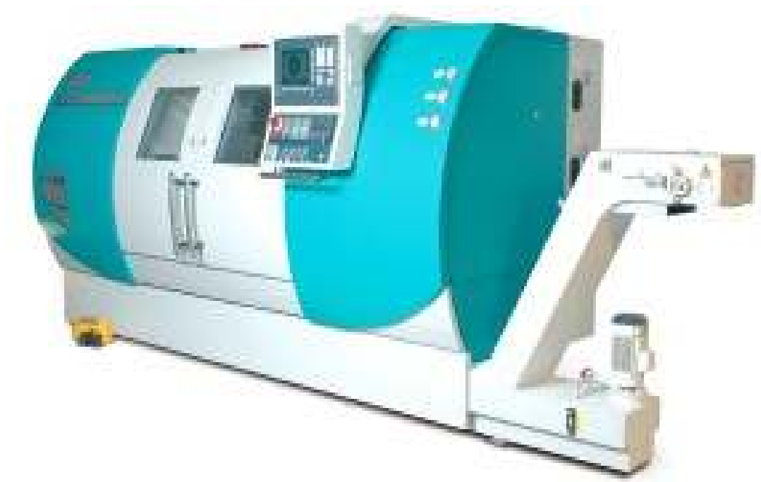
Slika 4.2 tokarski obradni centar Trens SBL-500 [16]
