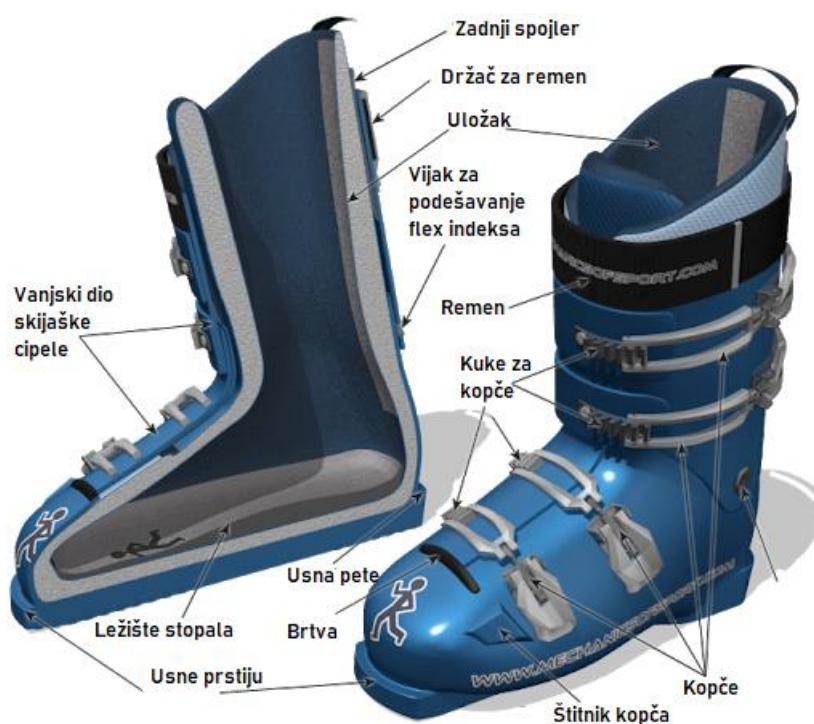
Slika 2.22. Dijelovi skijaške cipele [37]
