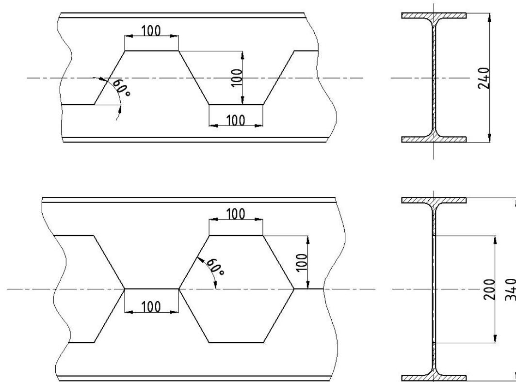
Slika 10. Način dobivanja web-nosača iz IPE profila
