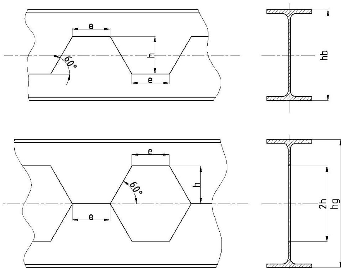
Slika 12. Primjer izrade i dimenzije otvora web-nosača
