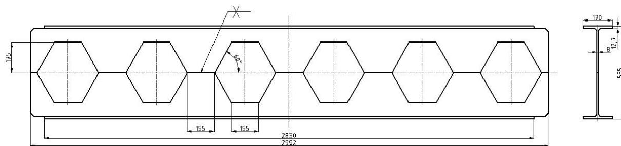
Slika 13. Poprečni nosač sa pripremom za zavarivanje
