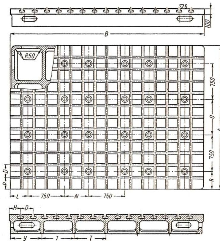
Slika 1. Ploča za radove u sklapanju i zavarivanju
