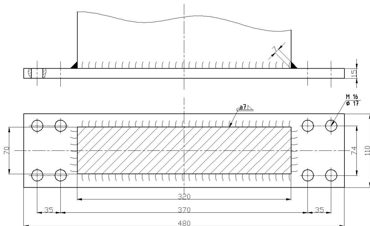
Slika 24. Spoj ležajnog mesta sa temeljnom pločom
