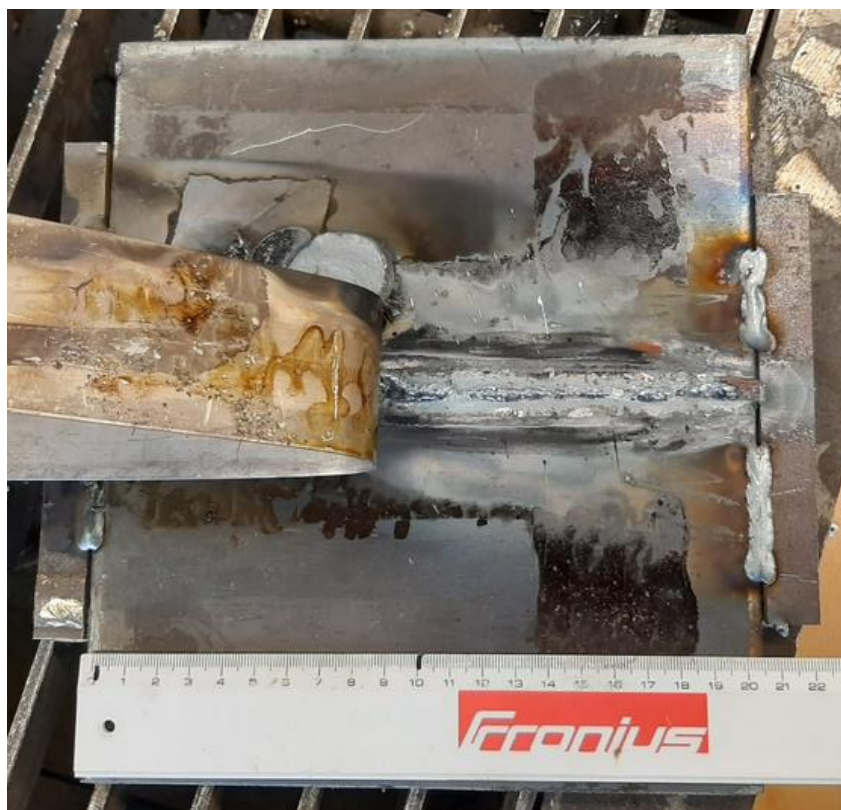
Slika 49. Uzorak B-1, korijen zavora
