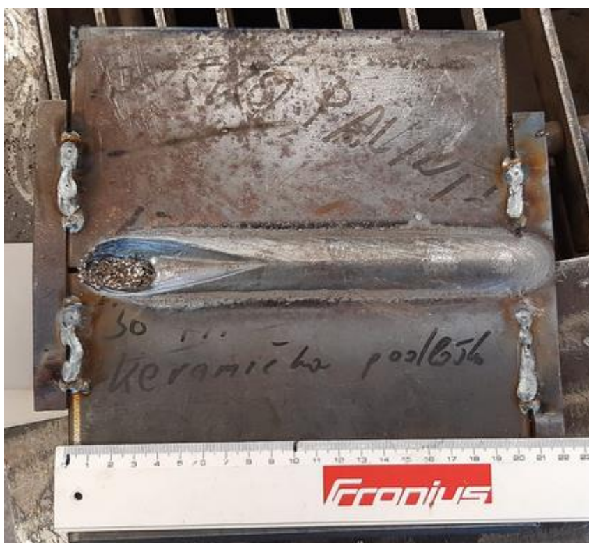
Slika 50. Uzorak B-2, lice zavora
