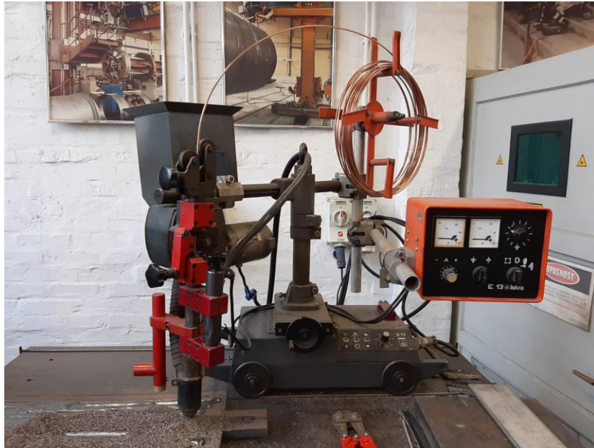
Slika 32. Mehanizam za EPP postupak zavarivanja
