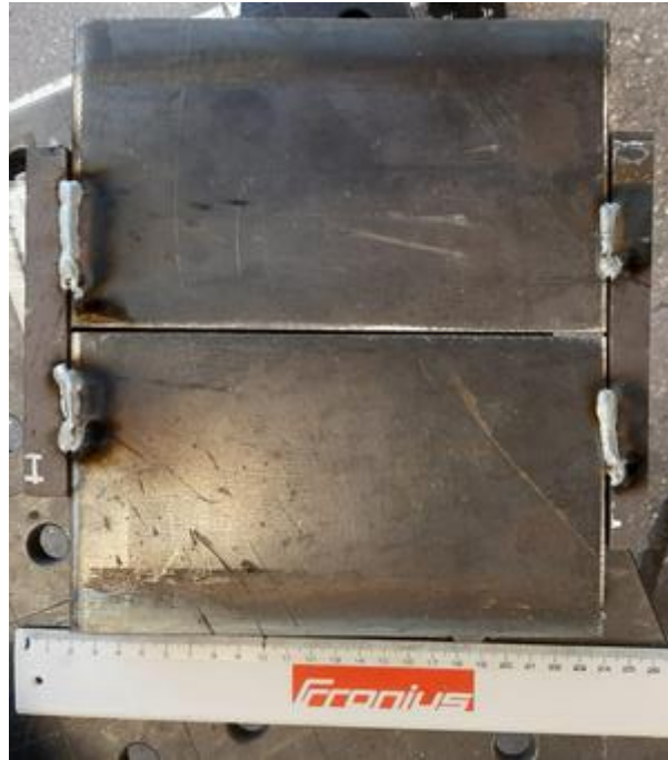
Slika 44. Prikaz priprave spoja sa prednje strane
