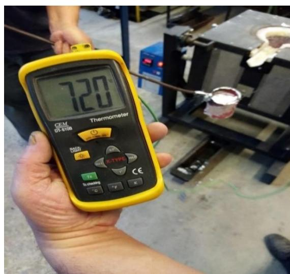
Slika 69. Mjerenje temperature u čaši kontaktnim pirometrom
