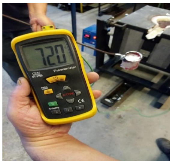
Slika 69. Mjerenje temperature u čaši kontaktnim pirometrom
