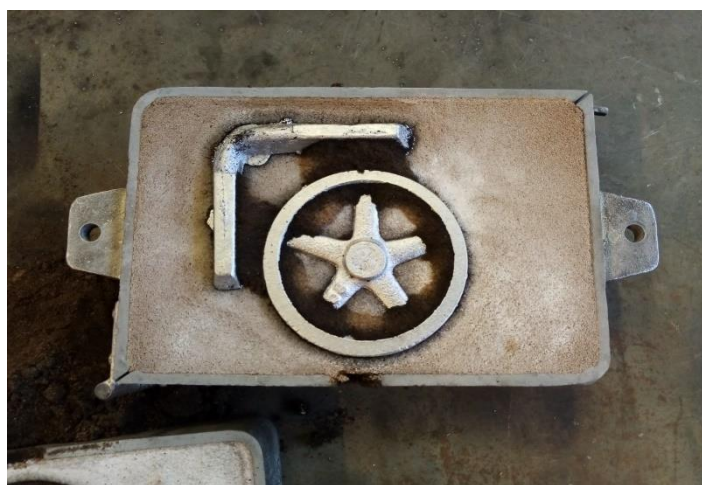
Slika 72. Prikaz odljevka u gornjaku
