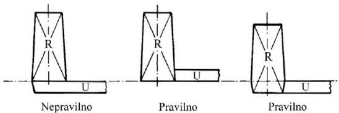
Slika 26. Spajanje razvodnika i ušća kod tlačnog uljevnog sustava[8]
