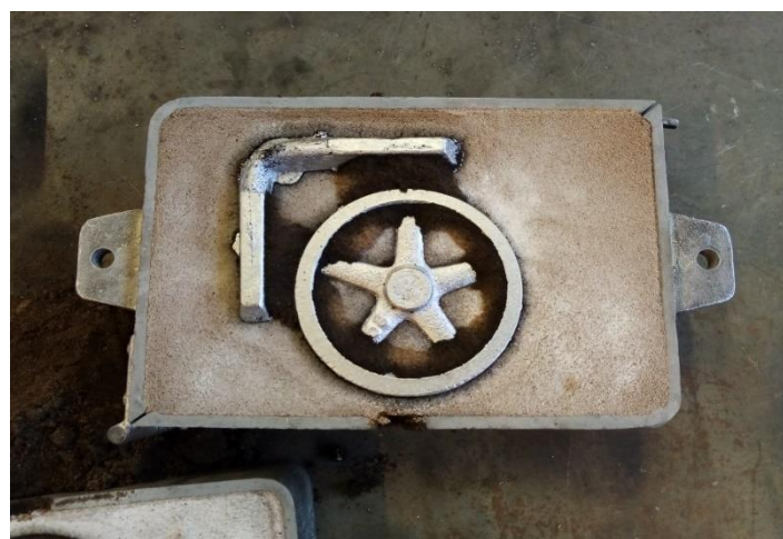
Slika 72. Prikaz odljevka u gornjaku
