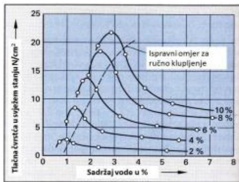
**Slika 11. Tlačna čvrstoća svježe kalupne mješavine u ovisnosti o sadržaju vode i bentonita. Crtkana linija pokazuje optimalnu vlažnost.[1]**
