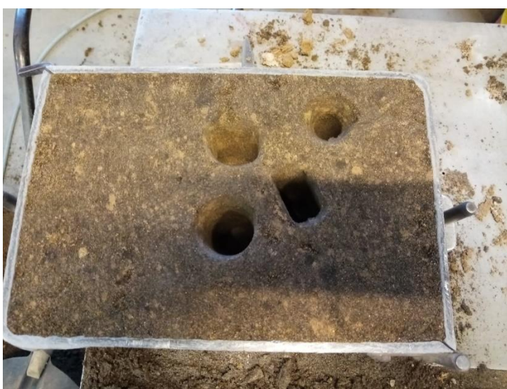
Slika 65. Spojen gornjak i donjak te schošenje rubova lancetom
