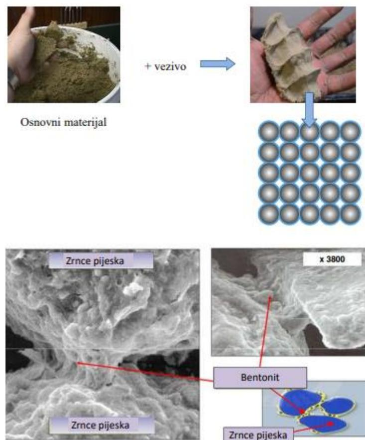
**Slika 10. Povezivanje zrnaca pijeska dodatkom veziva kod svježe kalupne mješavine [1]**
