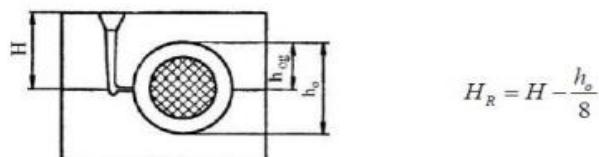
**Slika 32. Izračun računske visine taljevine  $H_R$  u ovisnosti o načinu lijevanja[8]**
