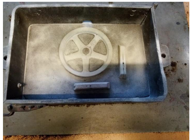
Slika 53. Zasipavanje donjaka prahom radi lakšeg vađenja modela
