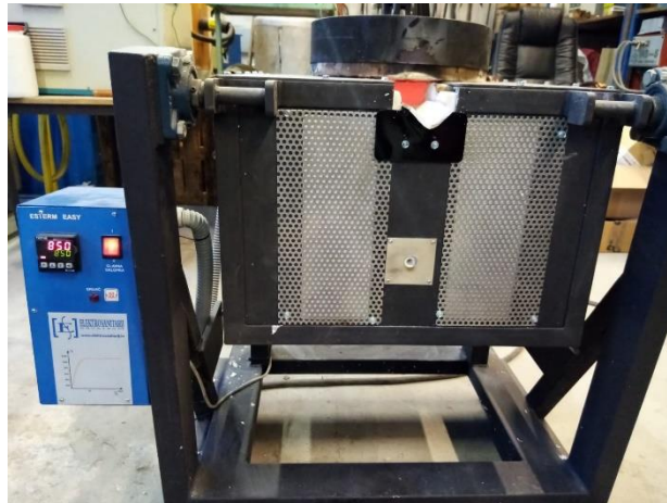
Slika 67. Peć zagrijana na 850 °C
