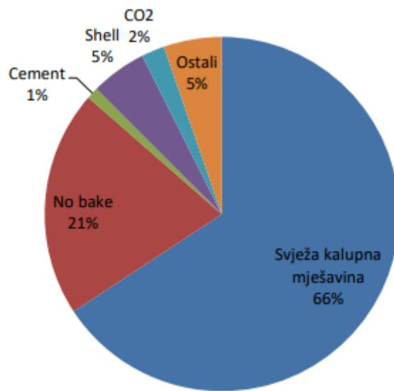
**Slika 9. Zastupljenost pojedinog postupka lijevanja u jednokratne kalupe [1]**
