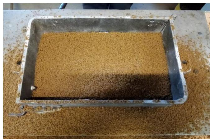
**Slika 54. Zasipavanje donjaka modelnom kalupnom mješavinom**
