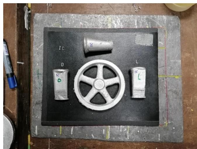
**Slika 77. Odljevak i pojila pripremljeni za radiografsko ispitivanje**
