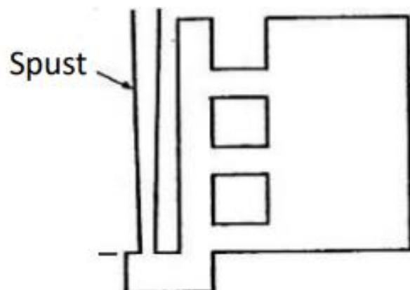
**Slika 30. Vertikalni uljevni sustav [1]**
