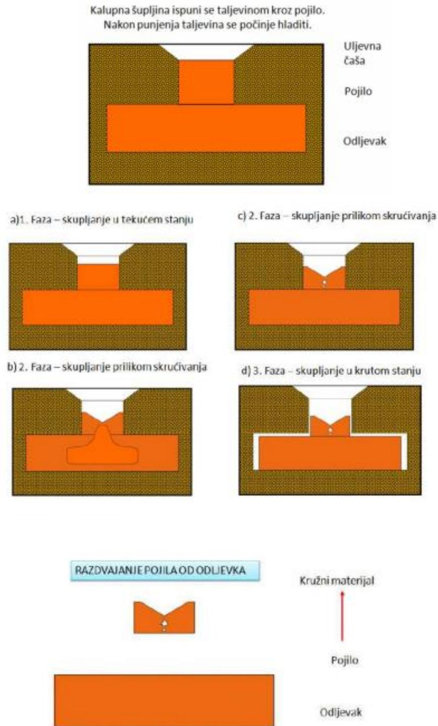
Slika 40. Pojednostavljeni prikaz nastajanja odljevka pri ulijevanju kroz pojilo [3]
