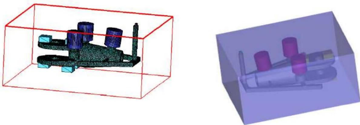
Slika 42. Importiranje elemenata u QuikCAST i konstrukcija kalupa [1]
