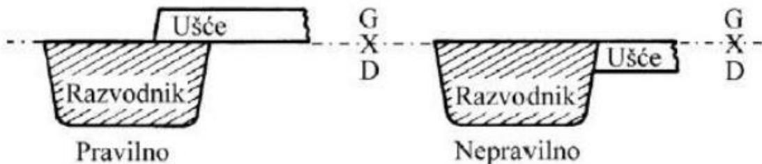
**Slika 28. Spajanje razvodnika i ušća u semitlačnom uljevnom sustavu[8]**
