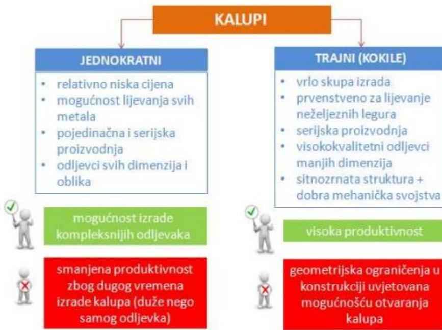
Slika 7. Karakteristike jednokratnih i trajnih kalupa [1]
