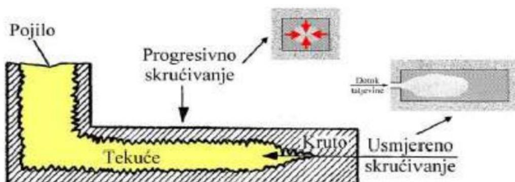
Slika 38. Shematski prikaz usmjerenoga i progresivnog skrućivanja[7]
