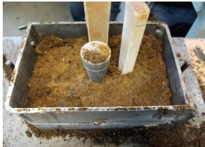
Slika 58. Zasipanje kalupnom mješavinom
