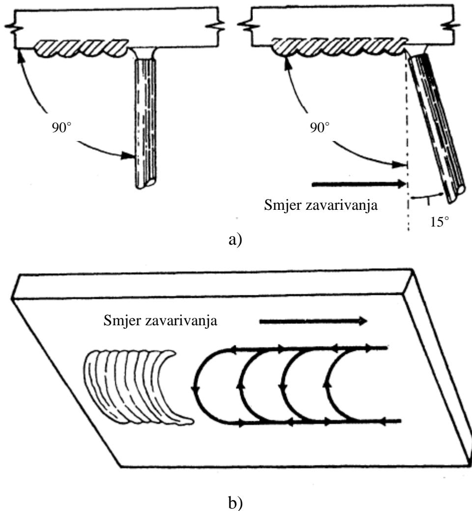
**Slika 36. Shematski prikaz zavarivanja granulastog zavara u nadglavnom položaju:
