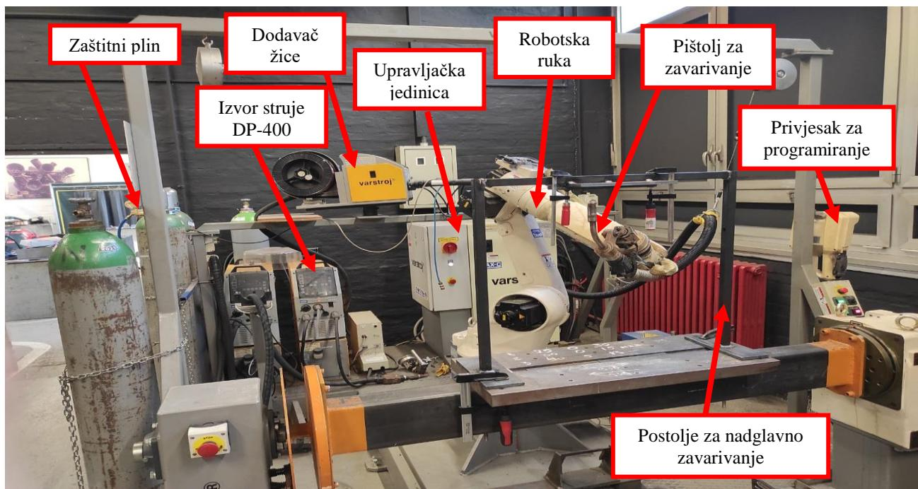
Slika 39. Robotska stanica Almega OTC AX V6
