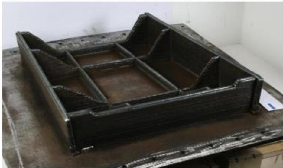
Slika 9. Rebro izrađeno WAAM postupkom [3]
