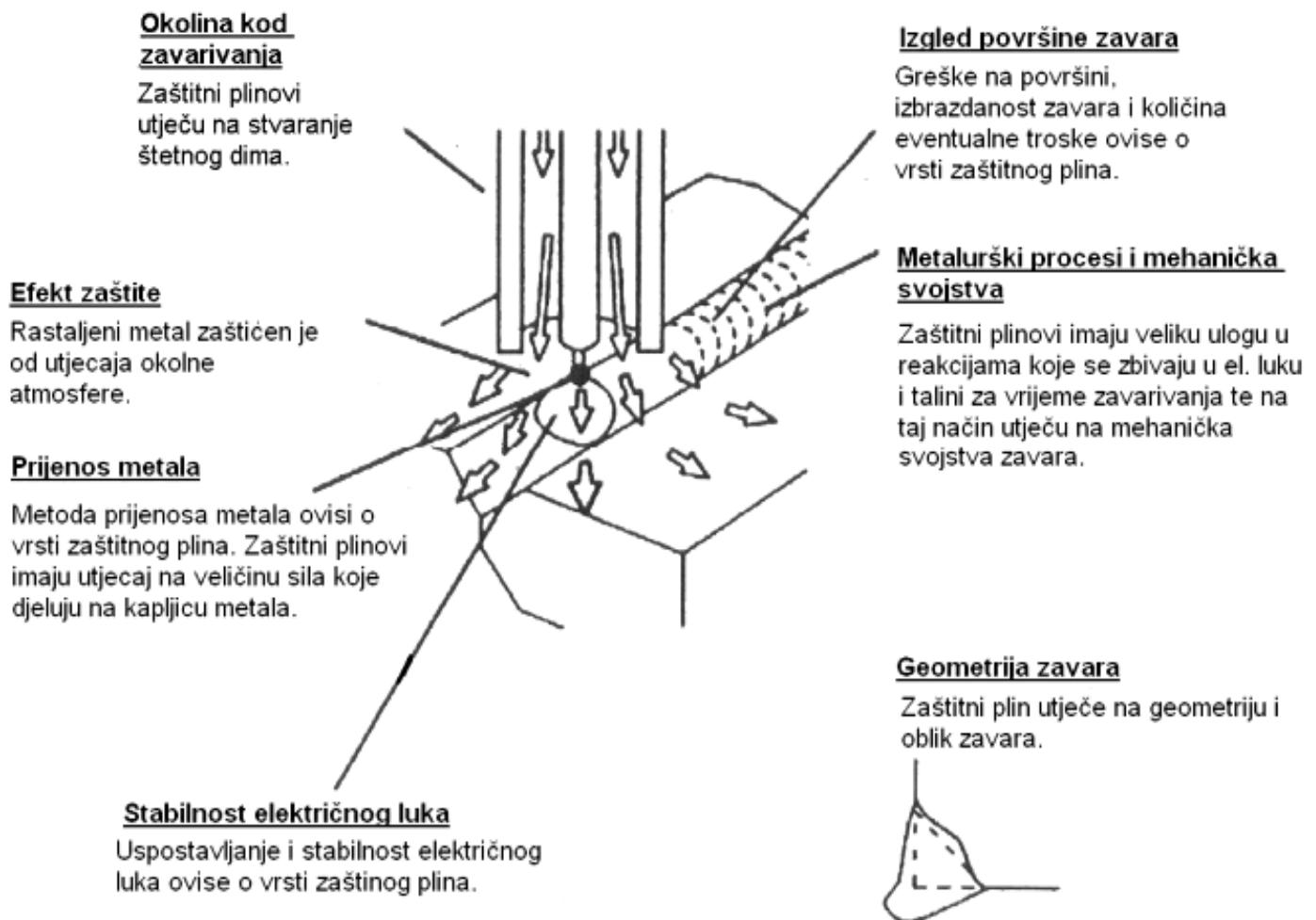
Slika 20. Uloga zaštitnih plinova kod MAG postupka zavarivanja [8]
