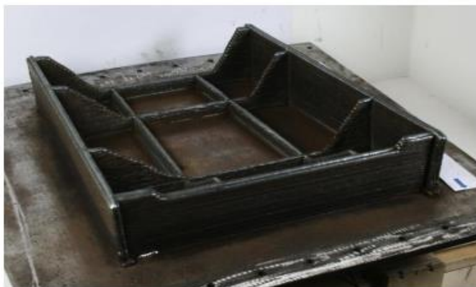
Slika 9. Rebro izrađeno WAAM postupkom [3]
