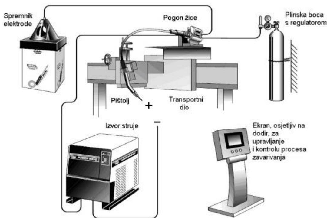
Slika 12. Automatski MAG sustav za zavarivanje [8]
