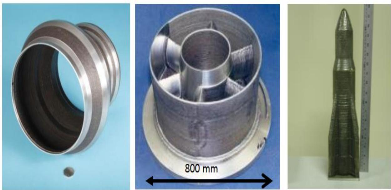
**Slika 4.** Proizvodi proizvedeni na Cranfield-u SDM postupkom [3]
