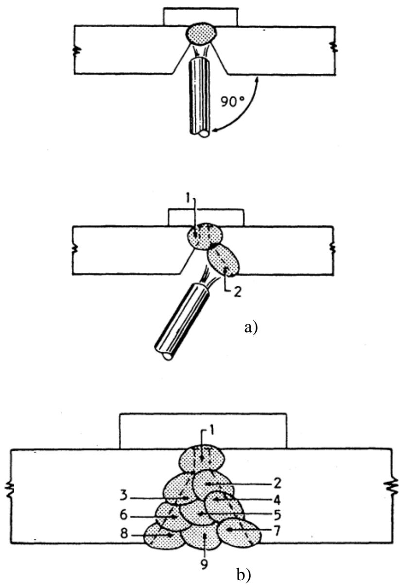
Slika 37. Shematski prikaz: a) položaja elektrode,
