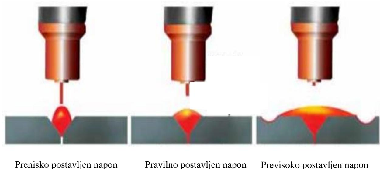
Slika 13. Oblik zavara s obzirom na napon zavarivanja [11]
