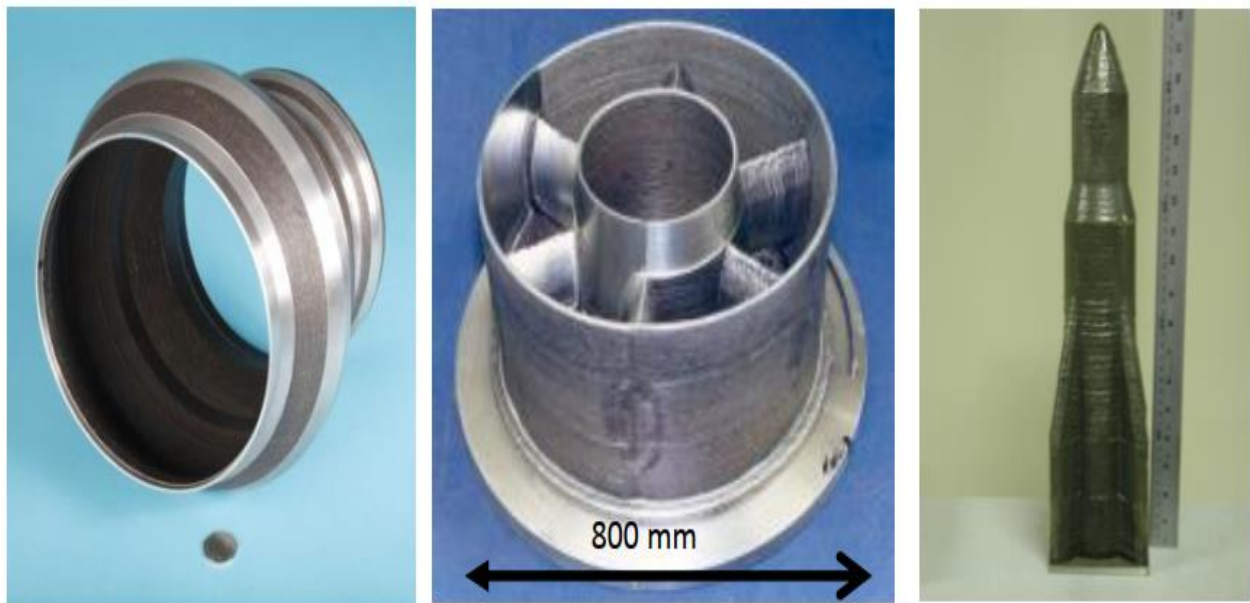
Slika 4. Proizvodi proizvedeni na Cranfield-u SDM postupkom [3]
