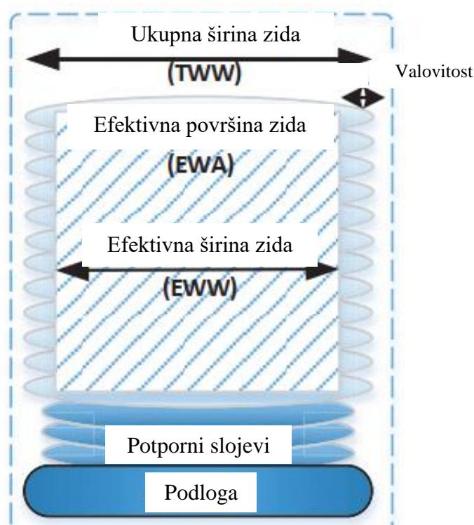
Slika 6. Prikaz ukupne i efektivne površine zida [4]
