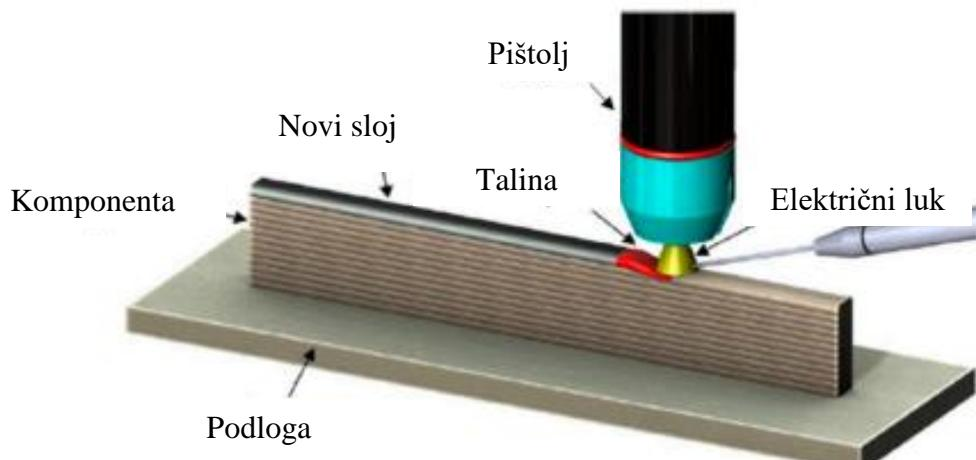
**Slika 5.** Shema izrade zida WAAM postupkom [5]
