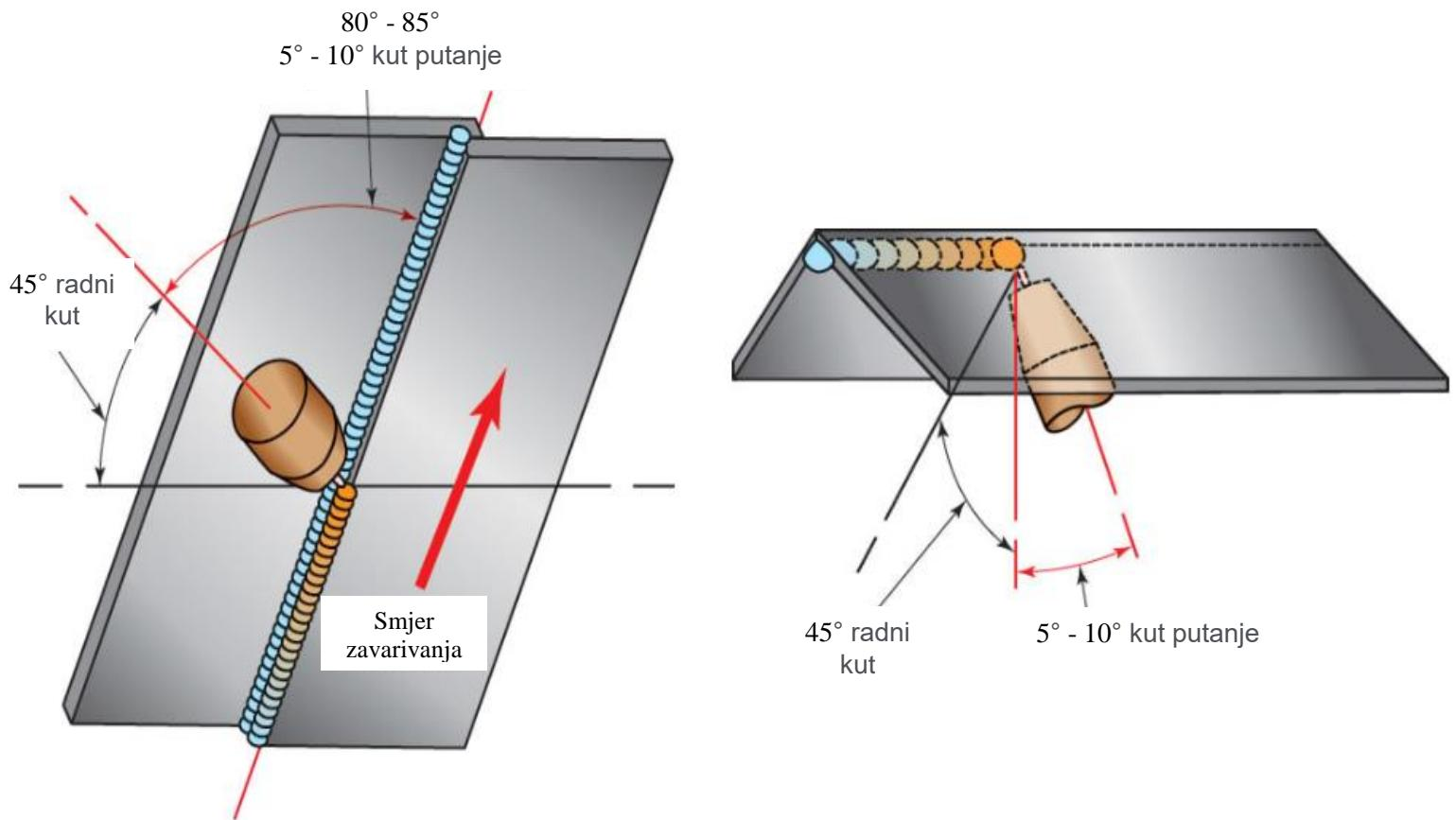
Slika 38. Shematski prikaz kutnih zavara kod nadglavnog položaja zavarivanja [20]
