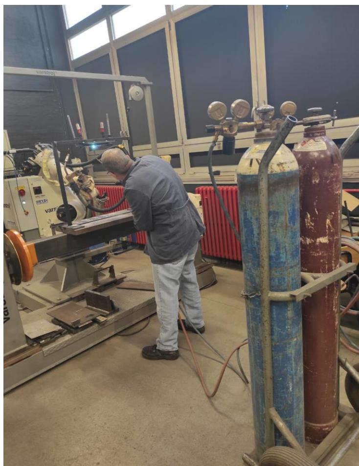
Slika 47. Predgrijavanje podloge i zida
