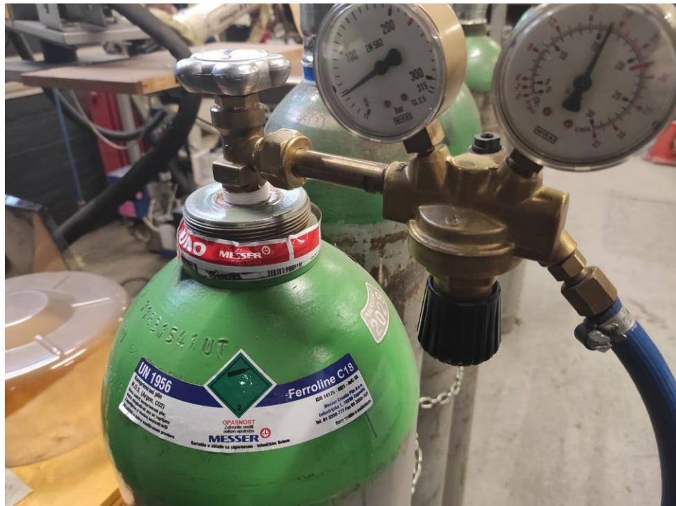
Slika 41. Čelična boca s zaštitnim plinom
