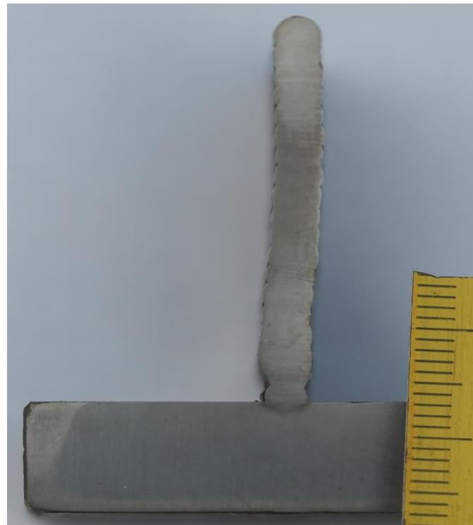
**Slika 51.** Makroizbrusak nakon brušenja i nagrizanja
