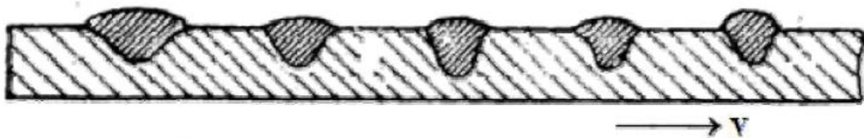
Slika 19. Utjecaj brzine zavarivanja na oblik zavara [11]
