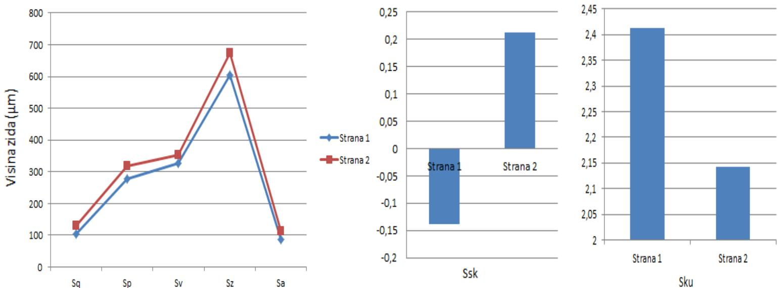
**Slika 58. Usporedba parametara teksture površine obje strane zide**
