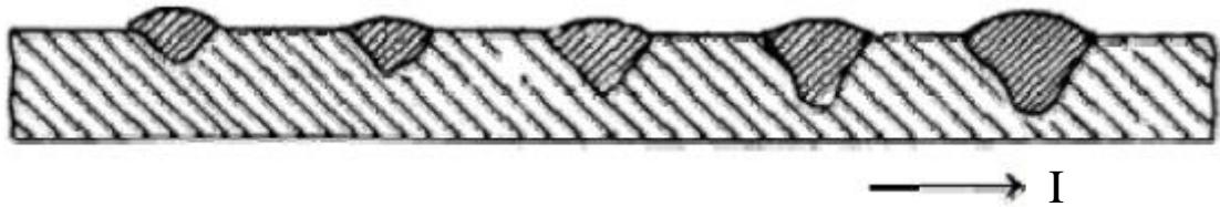
Slika 14. Ovisnost oblika zavara o jakosti struje zavarivanja [11]
