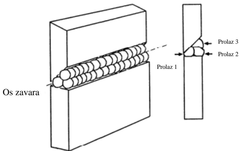
Slika 32. Horizontalni sučeljeni zavar [17]
