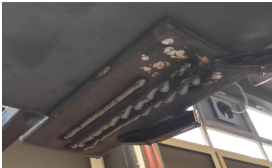
**Slika 45. Zidovi izrađeni s njihanjem pištolja za zavarivanje**
