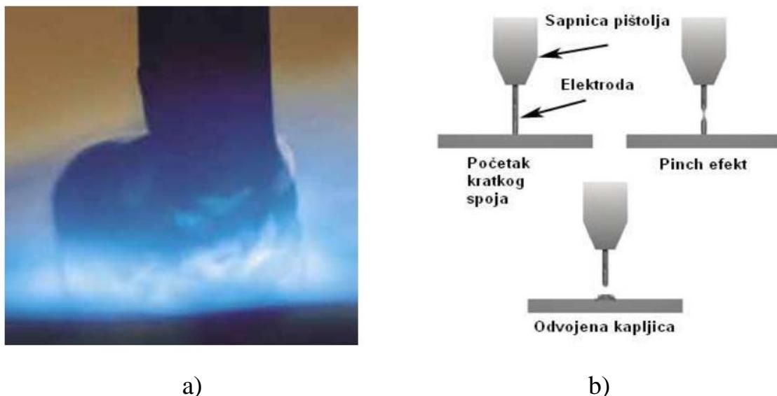
**Slika 25. Prijenos dodatnog metala kratkim spojevima: a) realni prikaz, b) shematski prikaz [8]**
