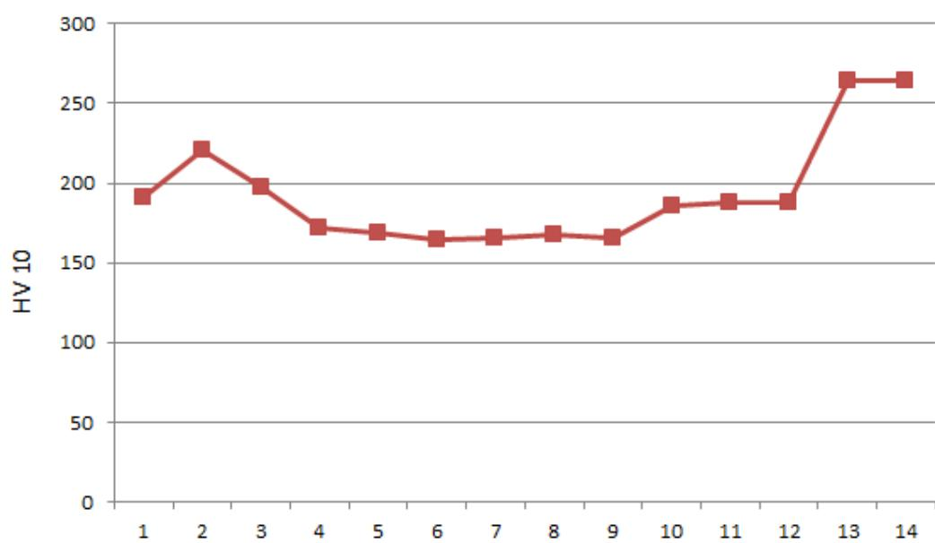
**Slika 60. Prikaz tvrdoće po presjeku zida**
