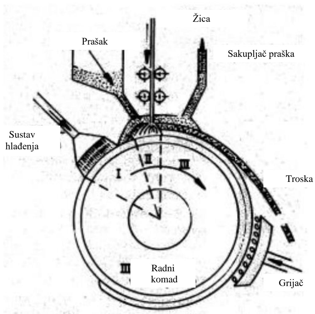
**Slika 3.** Prikaz proizvodnje dijelova za nuklearnu upotrebu [3]
