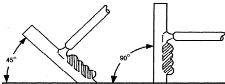
Slika 34. Površine kod vertikalnoj položaja zavarivanja [17]
