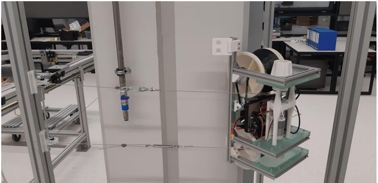
Slika 9.8. Uspinjanje prototipa po stupu uz pomoć testnog postava
