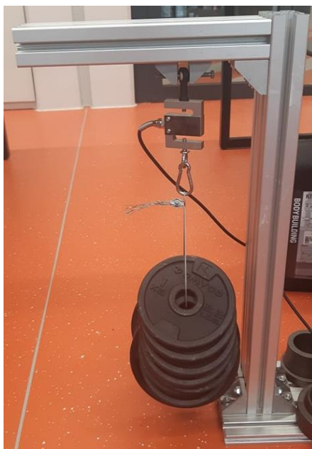
Slika 7.13. Testni postav senzora sile sa senzorom sile
