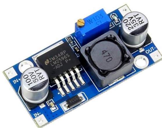
Slika 4.20. Regulator napona LM2596S[27]
