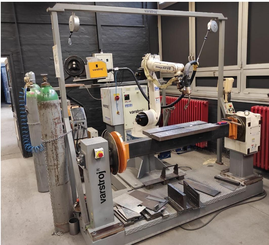
Slika 11. Robotska stanica Almega OTC AX V6
