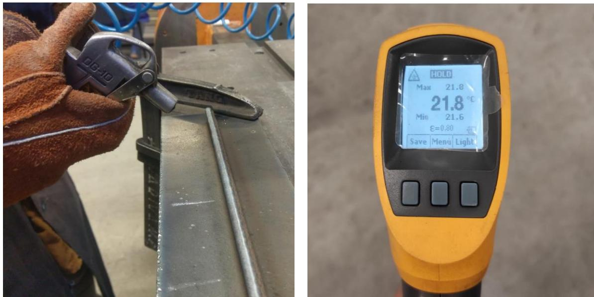
**Slika 18. Hlađenje zida komprimiranim zrakom (lijevo) i uređaj za beskontaktno mjerjenje temperature**
