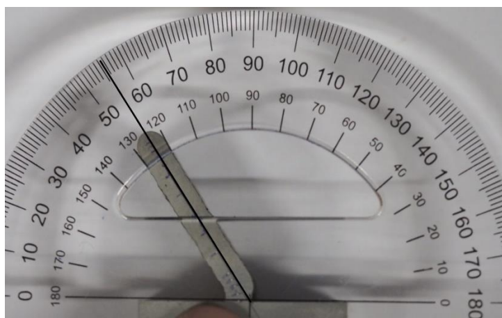
Slika 21. Očitavanje kuta drugog zida nazivnog kuta 45^\circ
