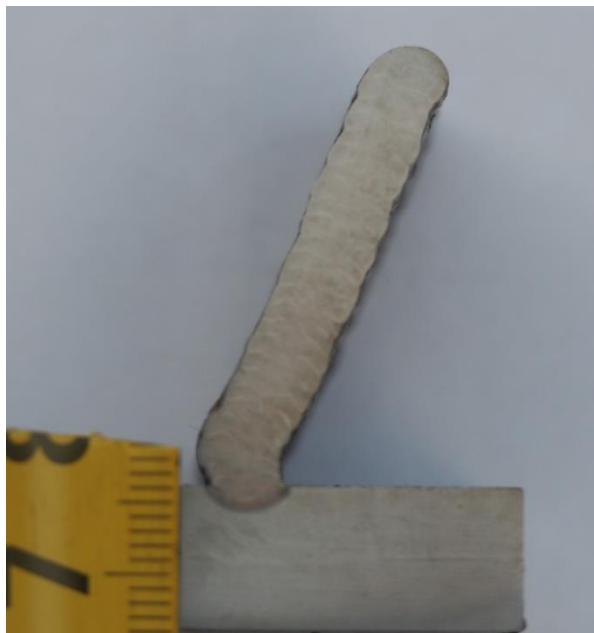
Slika 24. Makroizbrusak prvog zida nazivnog kuta od 60°
