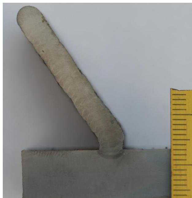
Slika 25. Makroizbrusak drugog zida nazivnog kuta od  $45^\circ$
