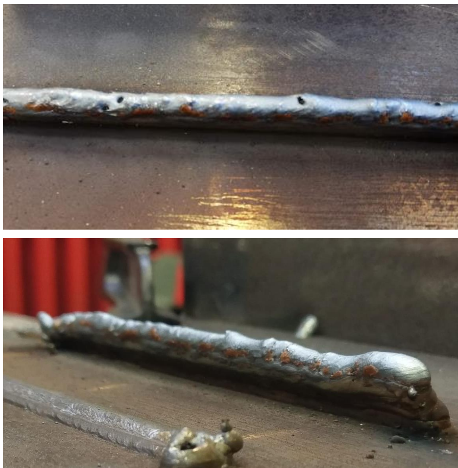
Slika 14. Gore – poroznost, dolje – nadvišenje na početku zavarivanja
