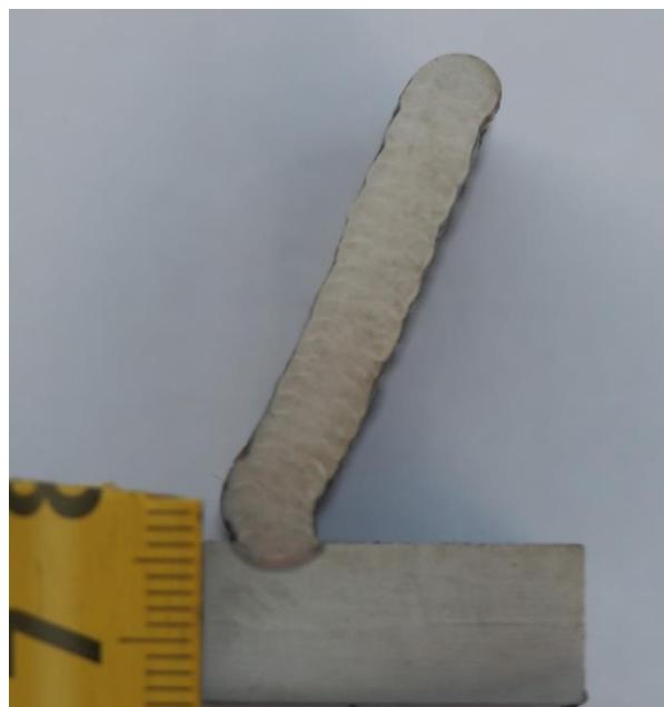
Slika 24. Makroizbrusak prvog zida nazivnog kuta od  $60^\circ$
