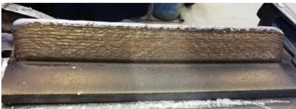
Slika 19. Konačan izgled zida nazivnog kuta 45°
