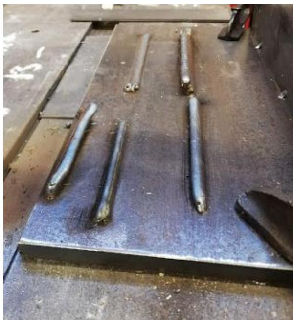
Slika 13. Probe izrade kosih zidova različitim parametrima zavarivanja
