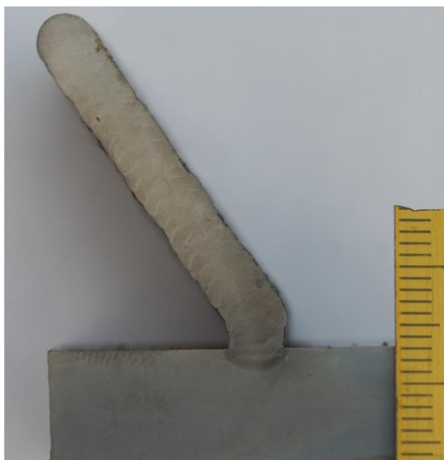
Slika 25. Makroizbrusak drugog zida nazivnog kuta od 45°
