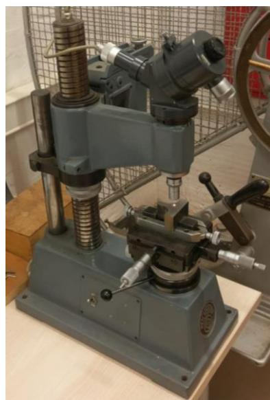
Slika 27. Uređaj za mjerjenje tvrdoće
