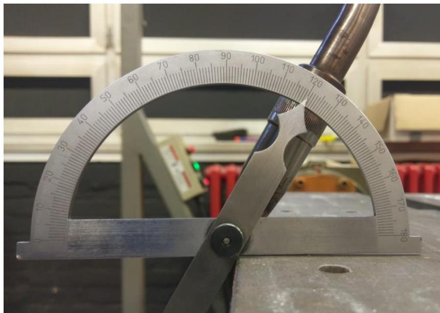
Slika 15. Određivanje kuta nagiba pištolja za zavarivanje
