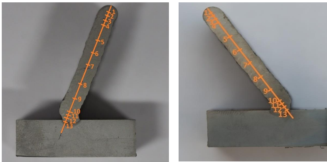
Slika 28. Raspored mjernih točaka tvrdoće za prvi zid (lijevo) i drugi zid (desno)
