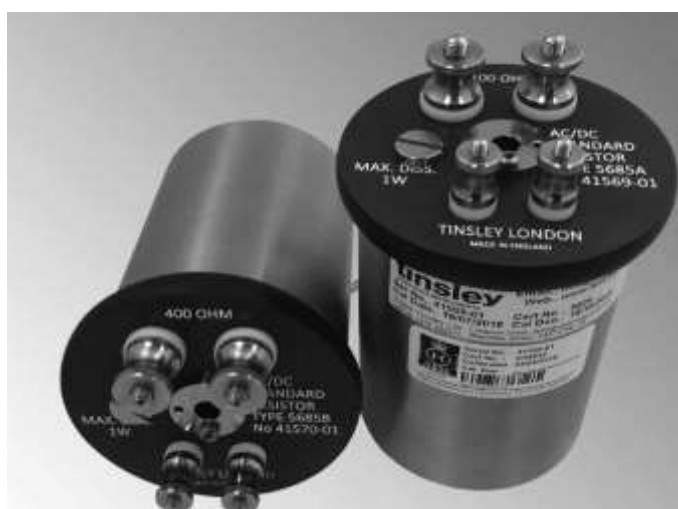
Slika 10. Fiksni otpornik Tinsley 5685 A, 100\ \Omega
