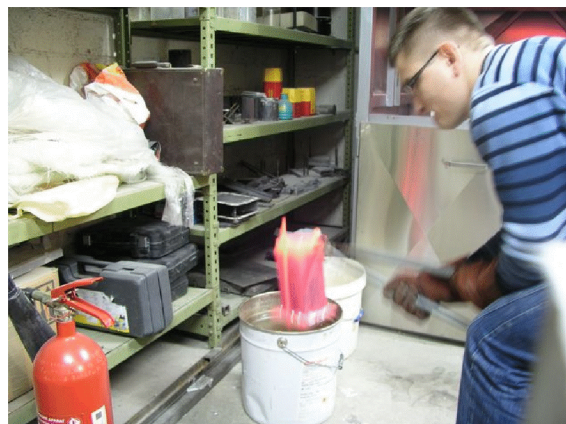
Slika 6.9. Prikaz gašenja kalupa u vodi.
