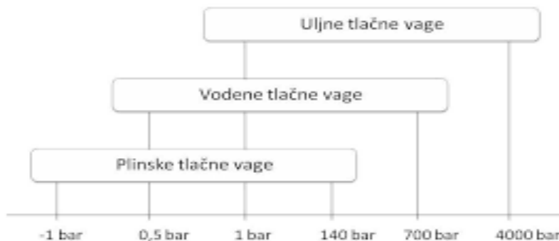
Slika 10. Podjela tlačnih vaga
