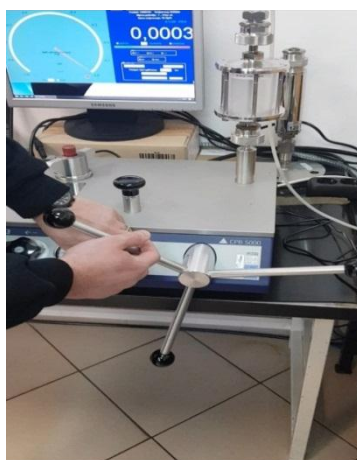
Slika 25. Ručno namještanje mjerne točke
