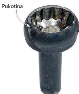
Slika 45. Površinska pukotina nastala tijekom hladnog kovanja [21]
