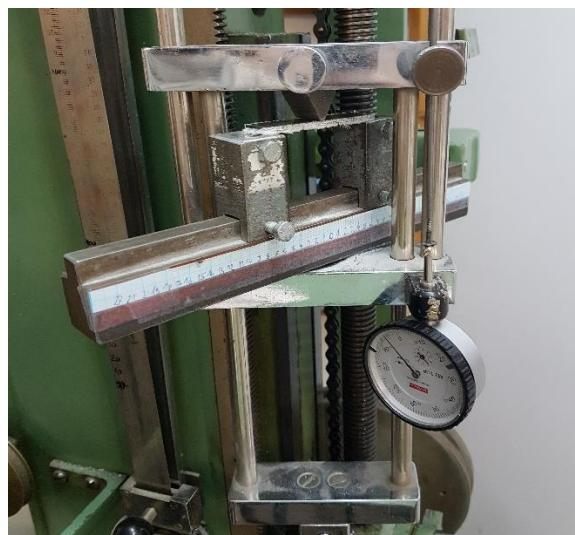
**Slika 25. Ispitivanje savojne čvrstoće**
