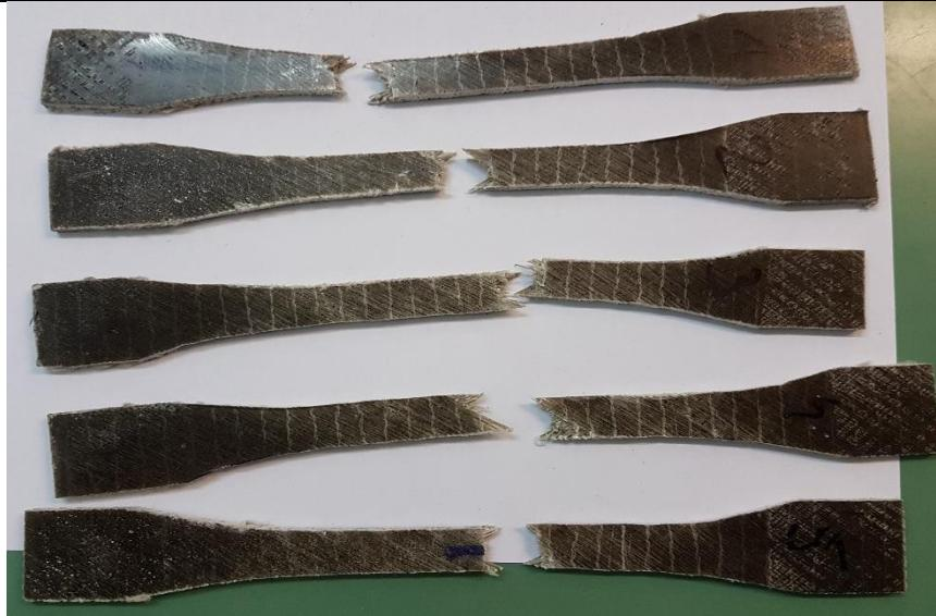
**Slika 27. Uzorci ispitani statičkim rasteznim pokusom**
