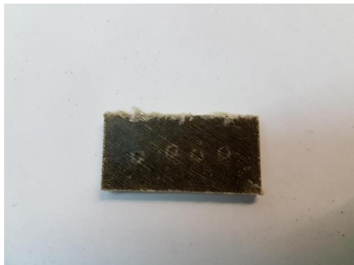
**Slika 17. Ispitna pločica nakon provedenog ispitivanja tvrdoće**
