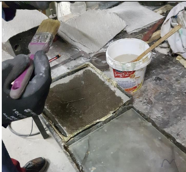
Slika 14. Ručno polaganje u kalup
