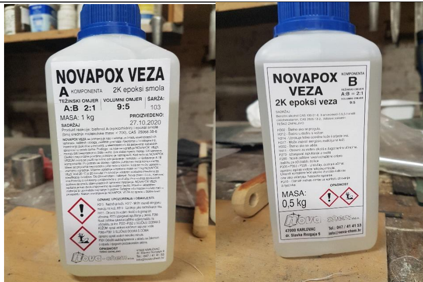
Slika 12. A i B komponente za izradu matrice
