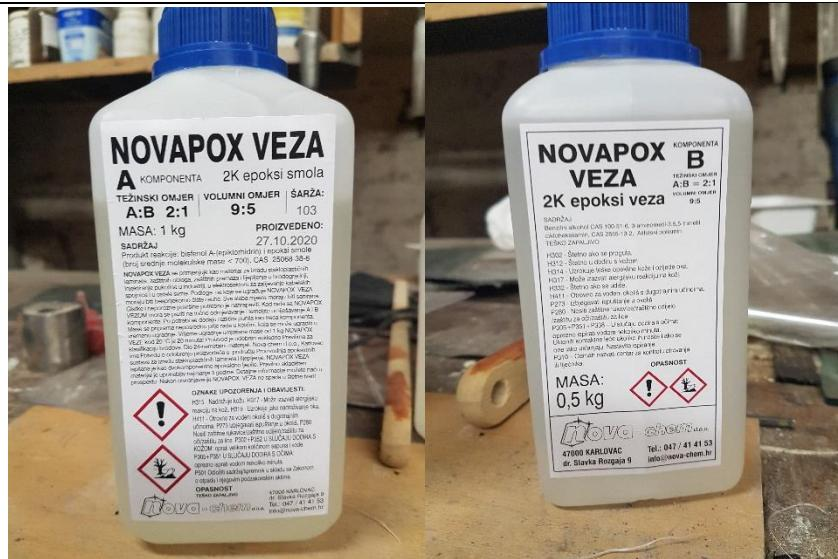
**Slika 12. A i B komponente za izradu matrice**
