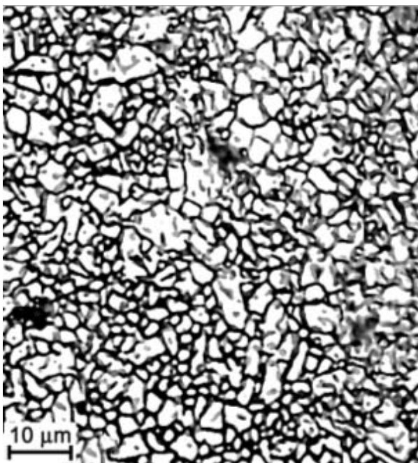
Slika 1. Mikrostruktura sitnozrnate aluminij oksidne keramike [2]
