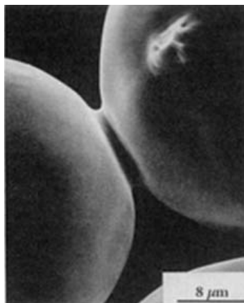
Slika 13. Stvaranje "vrata" na mjestu kontakta između čestica [5]
