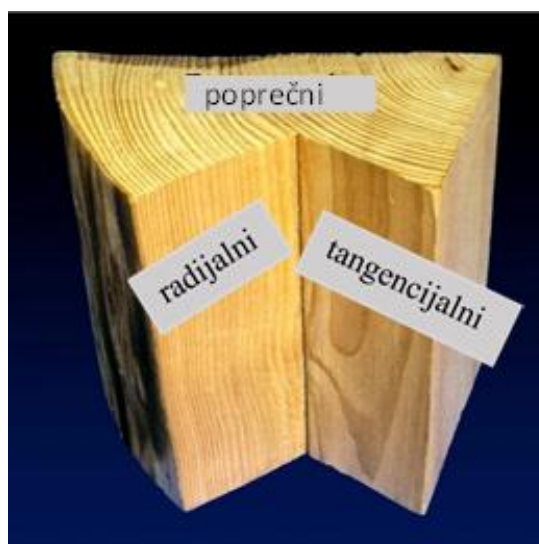
Slika 2 Karakteristični presjeci drva [7]
