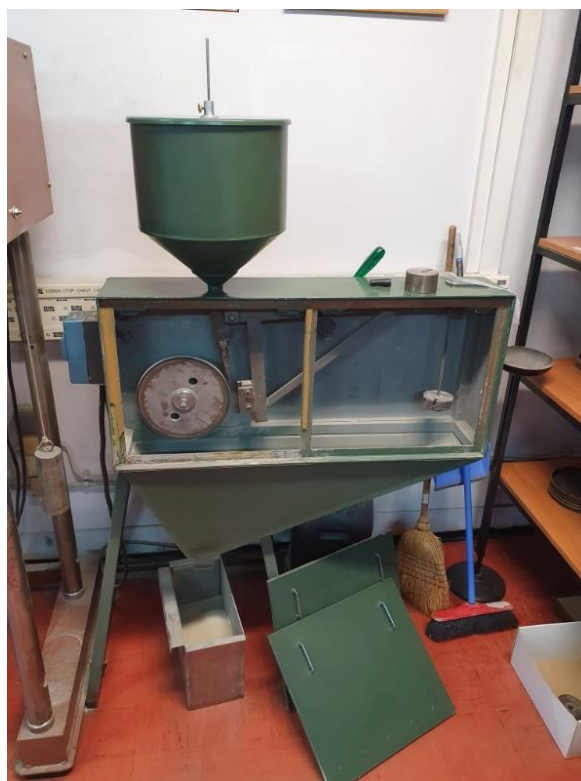
Slika 30 Uređaj za ispitivanje abrazijskog trošenja metodom „suhi pijesak – gumeni kotač
