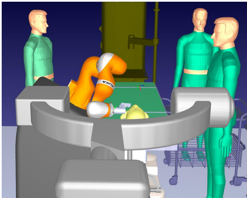
Slika 20. Neispravna orijentacija zglobova u točki operacije
