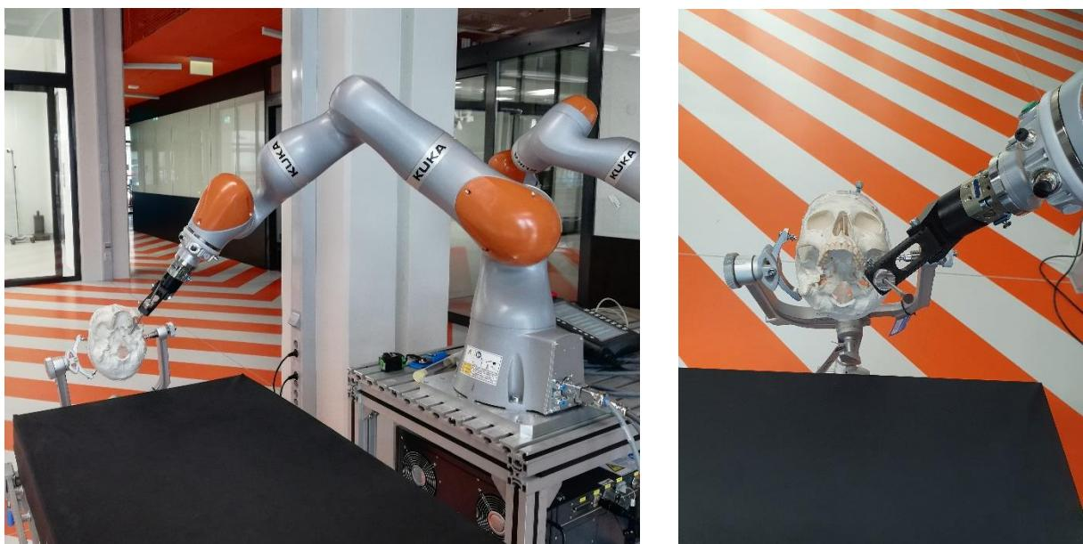
Slika 33. Prikaz kuta i pozicije robota potrebnog pri operaciji lijevog trigeminalnog ganglija
