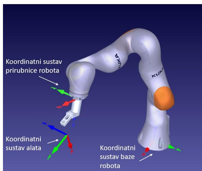
**Slika 30.** Prikaz relevantnih koordinatnih sustava robota potrebnih za simulaciju
