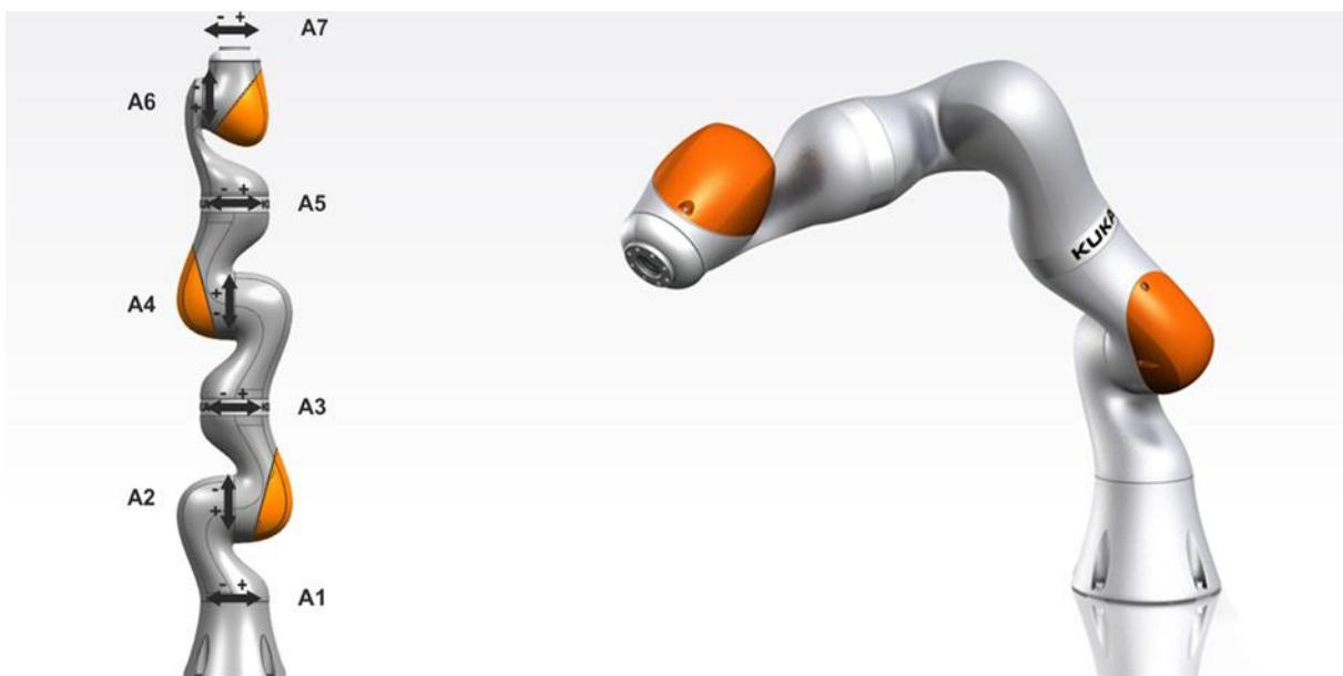
**Slika 16.** Serija robota KUKA LBR Med sa prikazom rotacije svakog zgoba [21]
