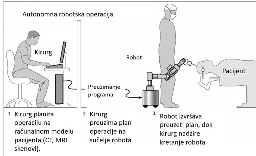
**Slika 12. Ilustrativni prikaz autonomne robotske operacije [18]**
