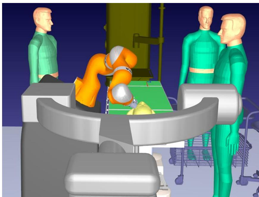
Slika 21. Ispravna pozicija robota u točki operacije
