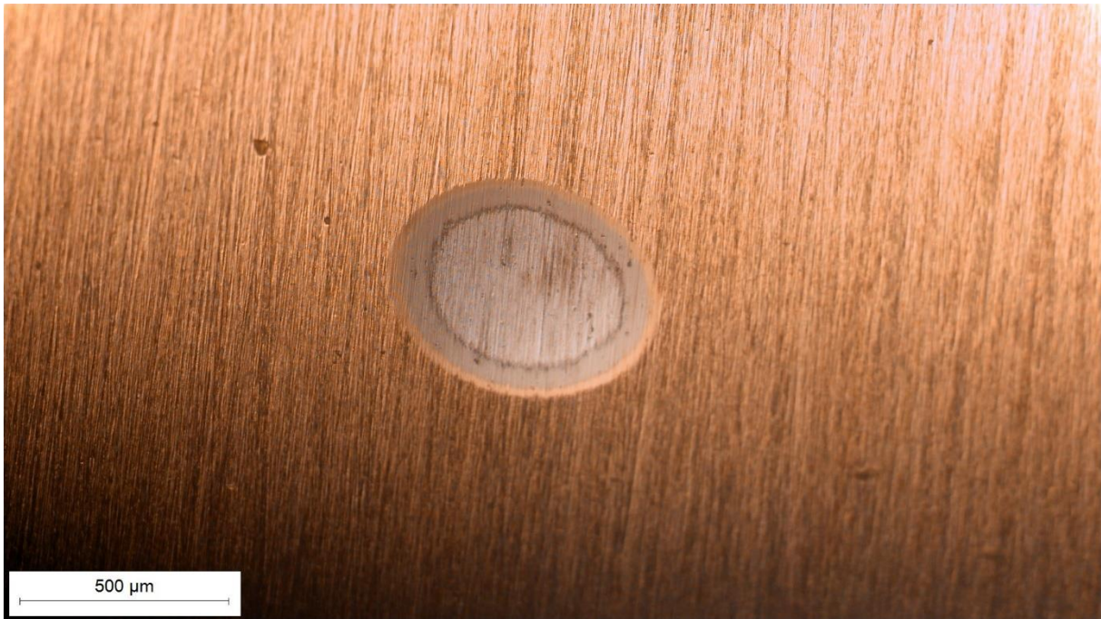
Slika 7.12 Otisak nakon ispitivanja TiCN/TiN prevlake
