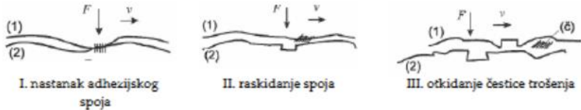
Slika 2.8 Faze adhezijskog trošenja [3]
