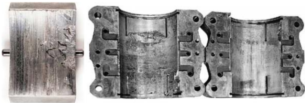
Slika 2.9 Oštećenja kliznog ležaja uslijed umora materijala [4]
