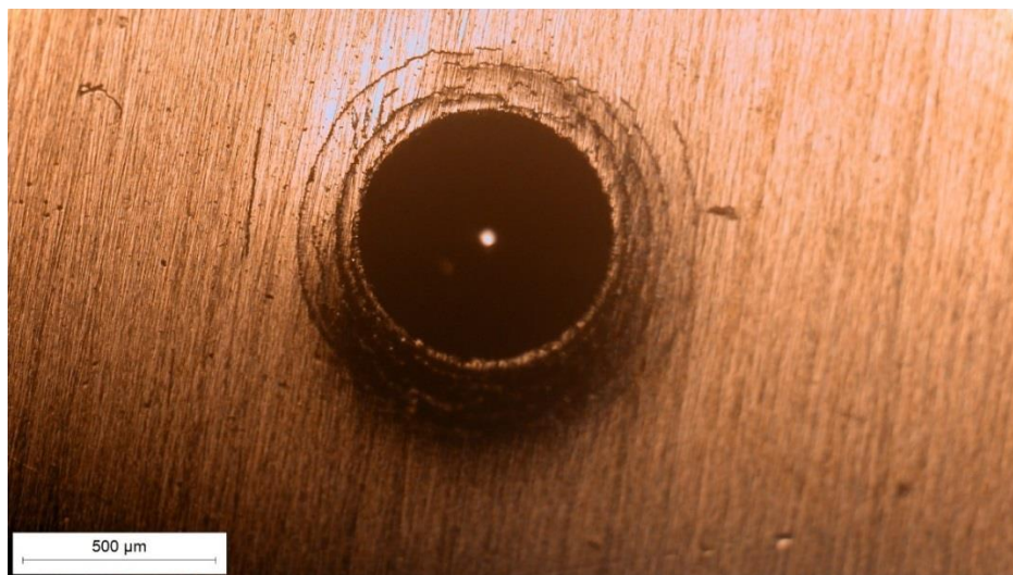
Slika 7.6 Ispitivanje 1, mjesto utiskivanja indentora u TiCN/TiN prevlaku
