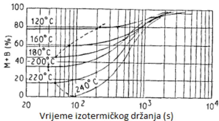
Slika 3.8 Utjecaj trajanja izotermičkog držanja na omjer udjela martenzita i bainita [13]
