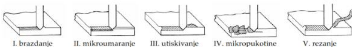
Slika 2.7 Načini abrazijskog trošenja [3]
