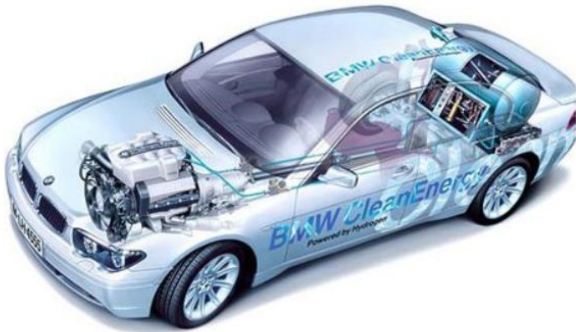
Slika 8. Shema unutarnjih dijelova Hydrogen 7 automobila [9]
