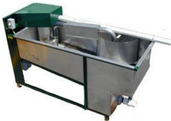
Slika 7. RM-102 Ultimate Ball Washer
