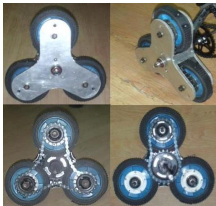
Slika 3.4. Sklop i pogon kotača u trokutnoj konfiguraciji[13]
