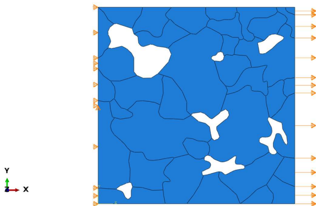
Slika 5.20 Prikaz zadanih rubnih uvjeta i rubnih pomaka heterogenog modela 500x
