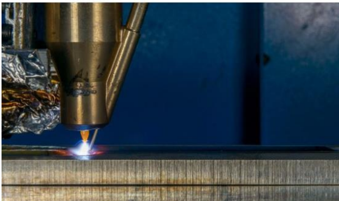
Slika 8. Prikaz WAAM tehnologije koristeći TIG postupak zavarivanja [5]
