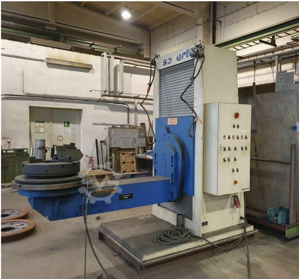
Slika 4. Manipulator SEVERT S-10.1 – 1HHF [4]
