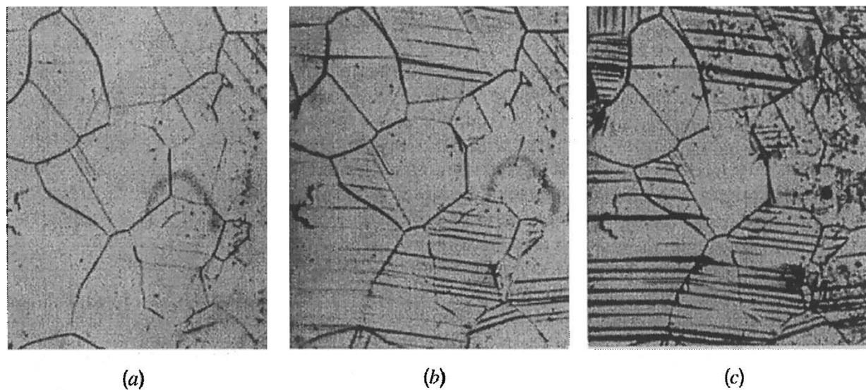
Slika 1. Propagacija mikropukotine preko kristalnih zrna [3]
