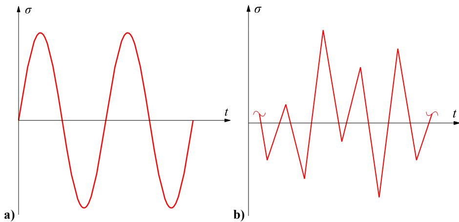
Slika 5. Dinamičko opterećenje: a) harmoničko, b) nepravilne amplitude [1]
