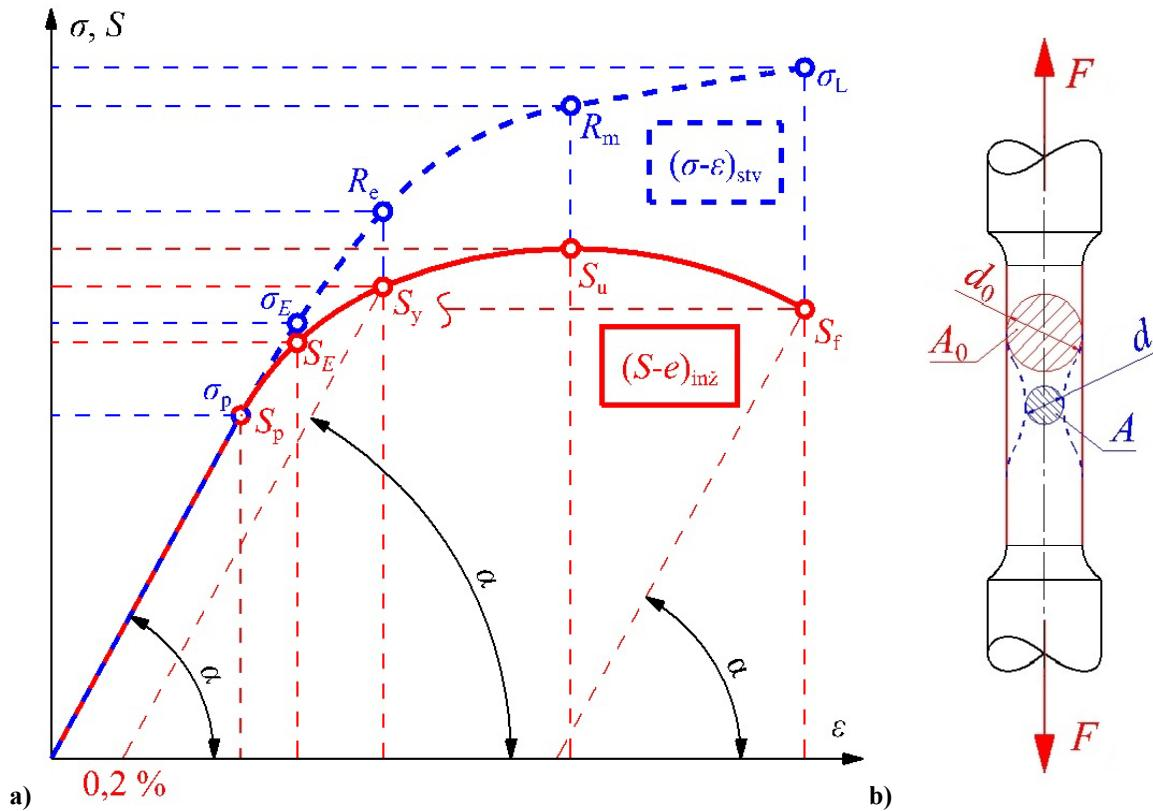
Slika 4. Statički vlačni pokus: a)  $\sigma$ ,  $S$ - $e$  dijagram, b) korelacija  $A_0/A$  sa uzorkom (prilagođeno iz [1])
