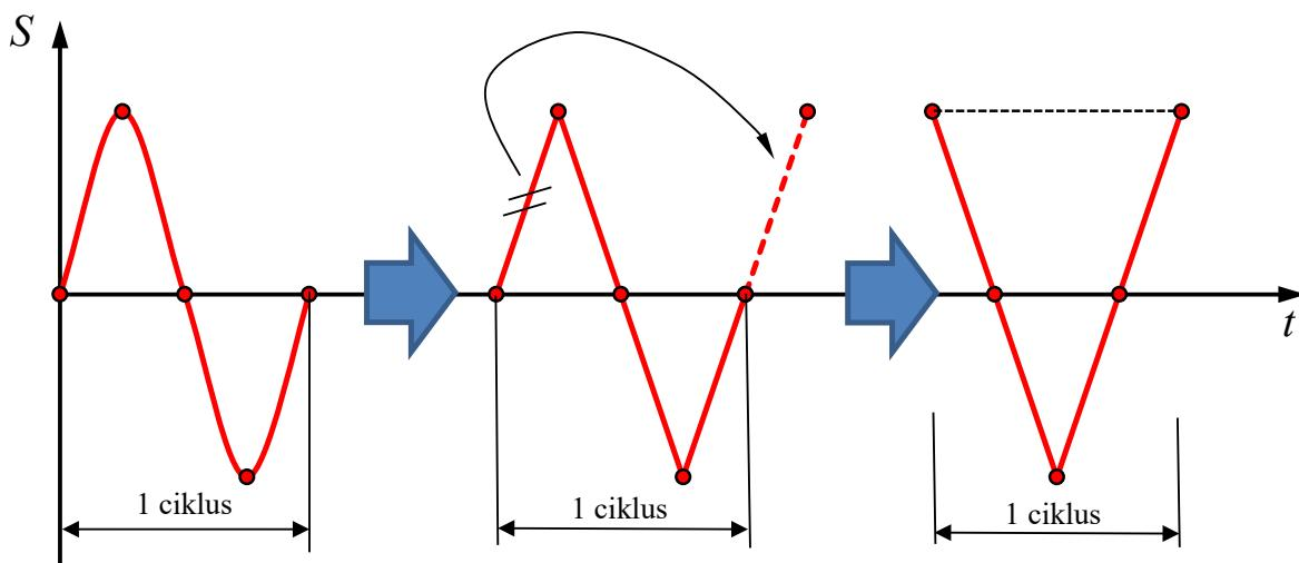
Slika 11. Prikaz pojednostavljenja sinusoidne u pravce i “zatvorenog” trokuta kao cijelog ciklusa
