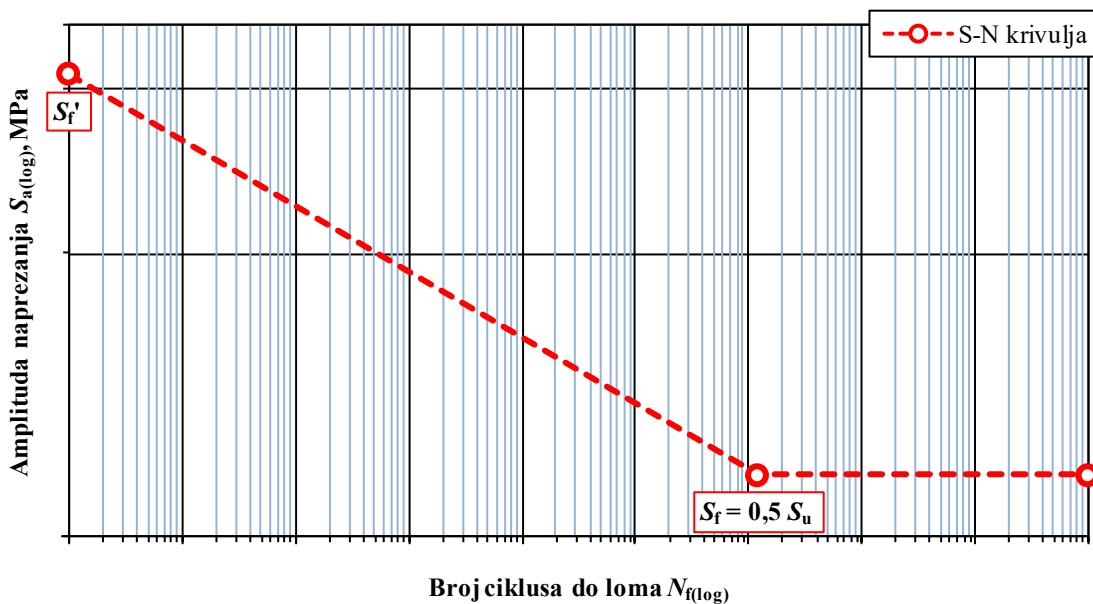
Slika 8.  $S\text{-}N$  krivulja za čelični materijal [1]
