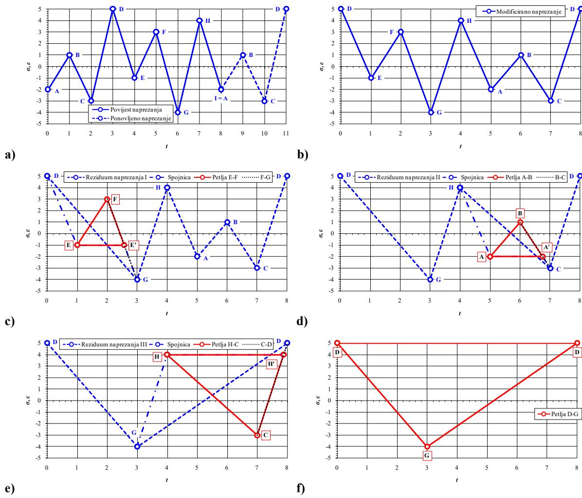
Slika 16. Primjer pojednostavljenje Rainflow metode [1]
