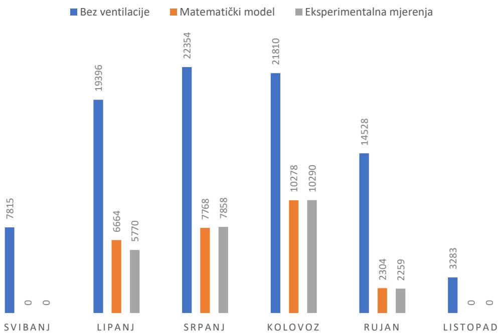
Slika 31. Usporedba rezultata matematičkog modela i eksperimentalnih mjerena pri izračunu potrebne energije za hlađenje [kWh], zaklonjena zgrada
