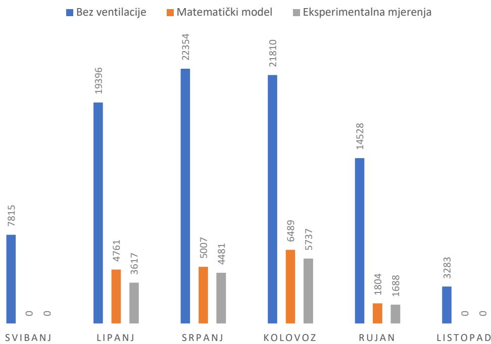
*Slika 30. Usporedba rezultata matematičkog modela i eksperimentalnih mjerena pri izračunu potrebne energije za hlađenje [kWh], izložena zgrada*
