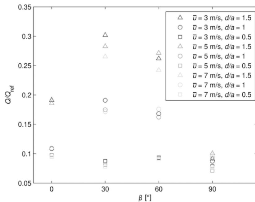
Slika 11.  $Q/Q_{ref}$  u ovisnosti o kutu nastrujavanja s brzinom i udaljenosti kao parametrima, zaklonjena zgrada [4]
