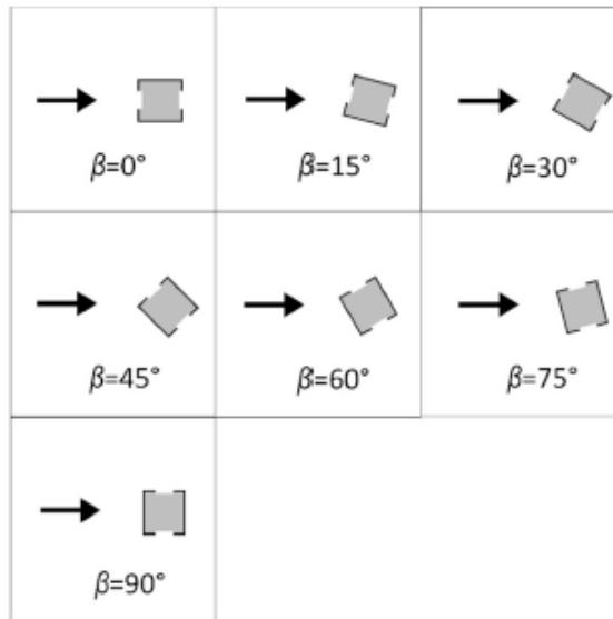
Slika 8. Kutevi nastrujavanja zraka pri eksperimentalnom mjerenu [4]
