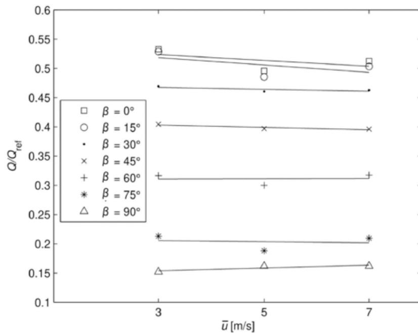
Slika 10.  $Q/Q_{ref}$  u ovisnosti o brzini i kutu za izloženu zgradu [4]
