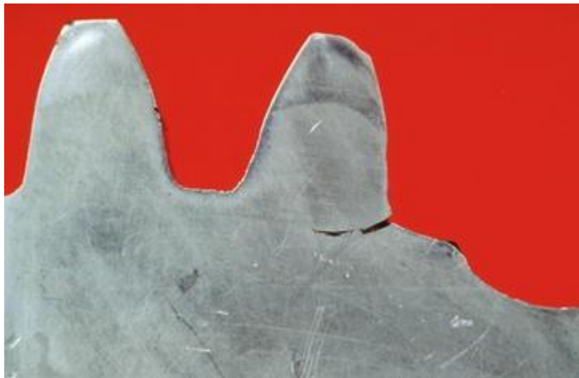
Slika 3. Lom zuba uslijed savojnog opterećenja [3]
