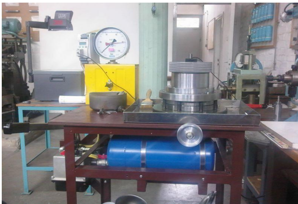
Slika 6.3. Naprava za modificirano hidraulično udubljivanje
