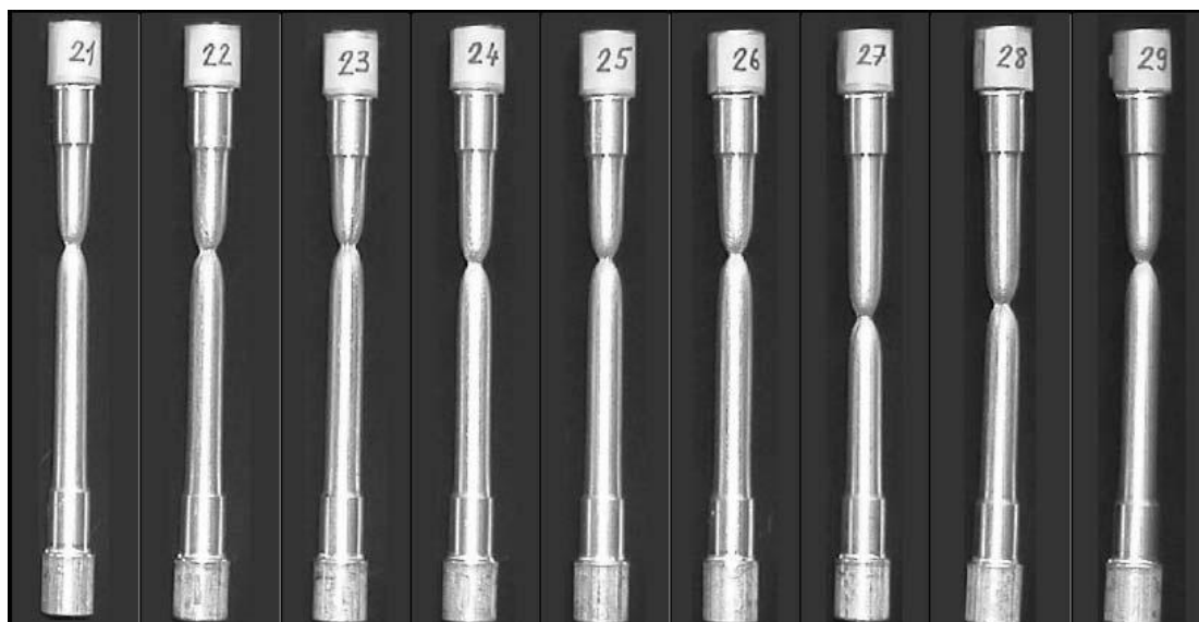
Slika 4.5. Eksperimentalni uzorci najvećih stupnjeva deformacija uključujući onaj s lomom (29) [13]
