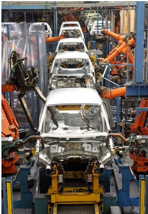
Slika 3.11. Proizvodna linija gdje se obavlja točkasto zavarivanje dijelova šasije Forda [22]
