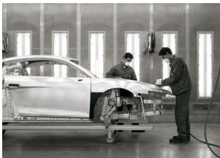
Slika 3.9. Montaža karoserije i priprema za lakiranje
