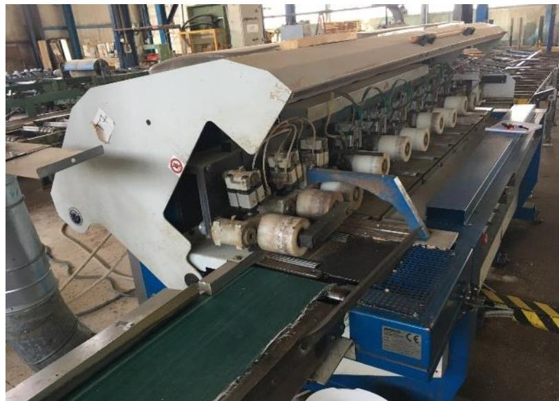
Slika 5.4. Višelisna kružna pila za uzdužno raspiljivanje
