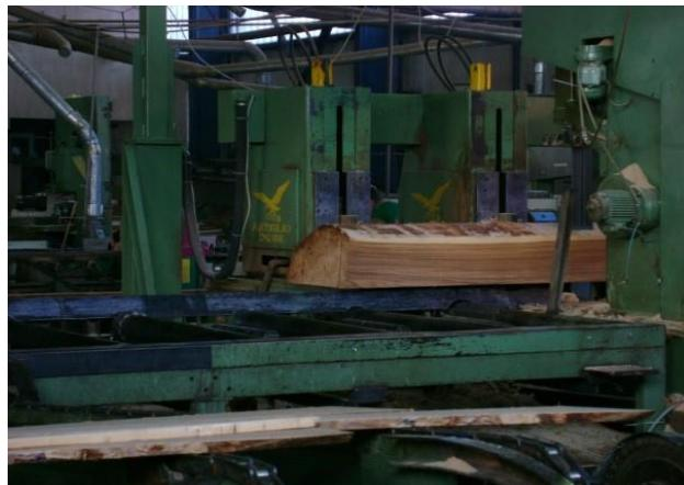
**Slika 6.1. Obrada na tračnoj pili trupčari [11]**
