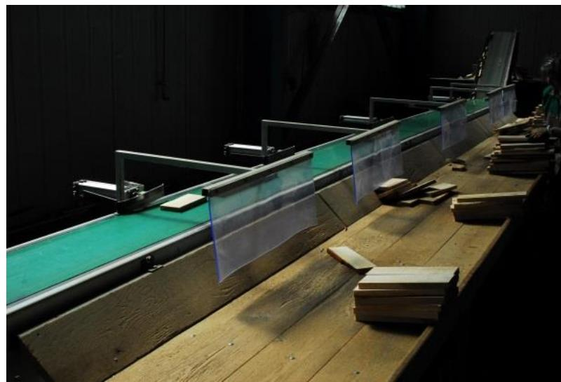
**Slika 5.6. Sortirna traka s automatskim izbacivačima (Sortirnica)**
