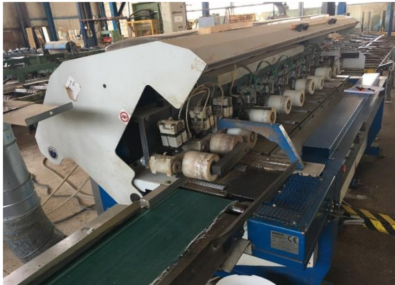
Slika 5.4. Višelisna kružna pila za uzdužno raspiljivanje
