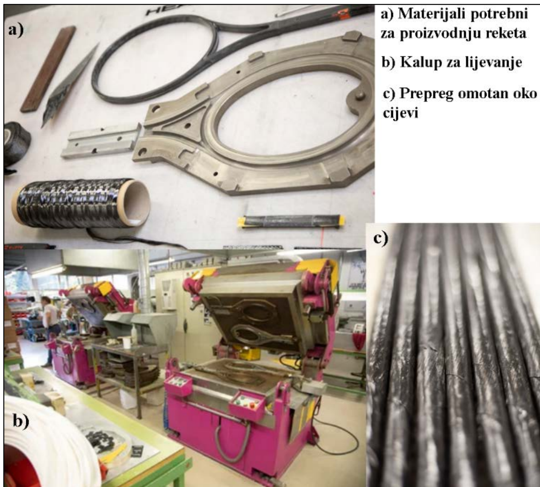
Slika 31. Proizvodnja teniskog reketa [48]
