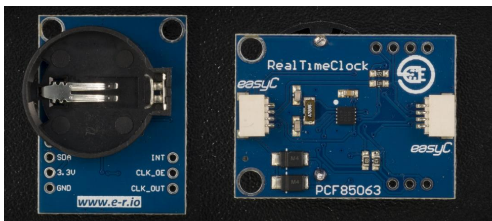
Slika 9. Prednja strana (lijevo) i stražnja strana (desno) RTC modula [3]
