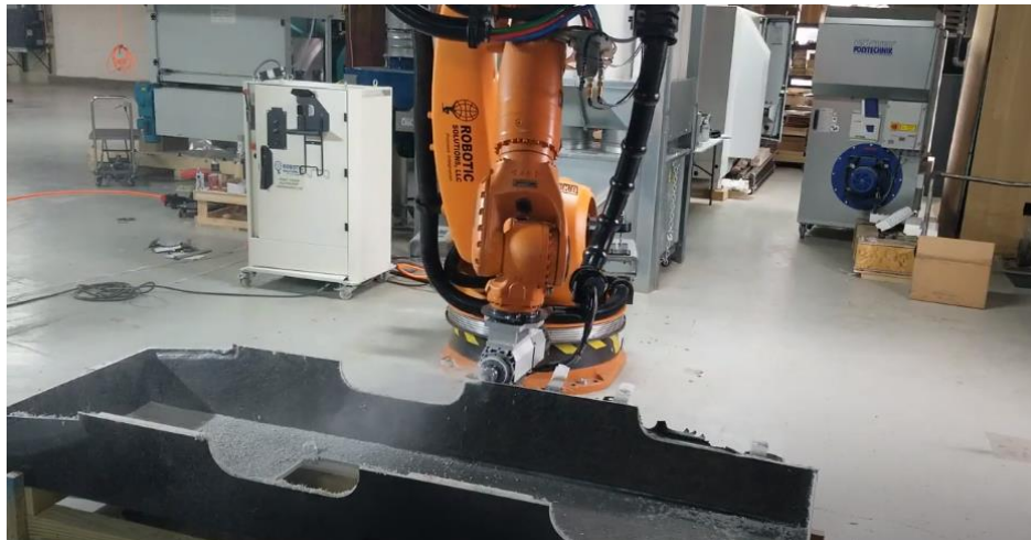
Slika 1.1 Obrada kompozitnog materijala 6 osnim robotom [2]
