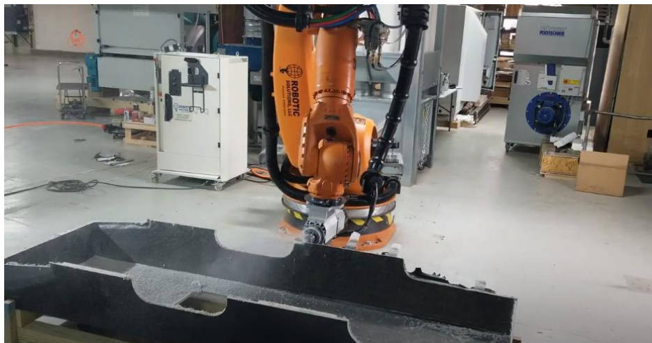
Slika 1.1 Obrada kompozitnog materijala 6 osnim robotom [2]
