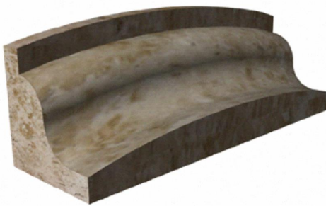
Slika 8. Primjer izratka obrađenog na troosnom CNC stroju [12]
