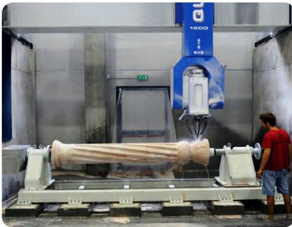
Slika 11. Okretno glodanje kamena [15]
