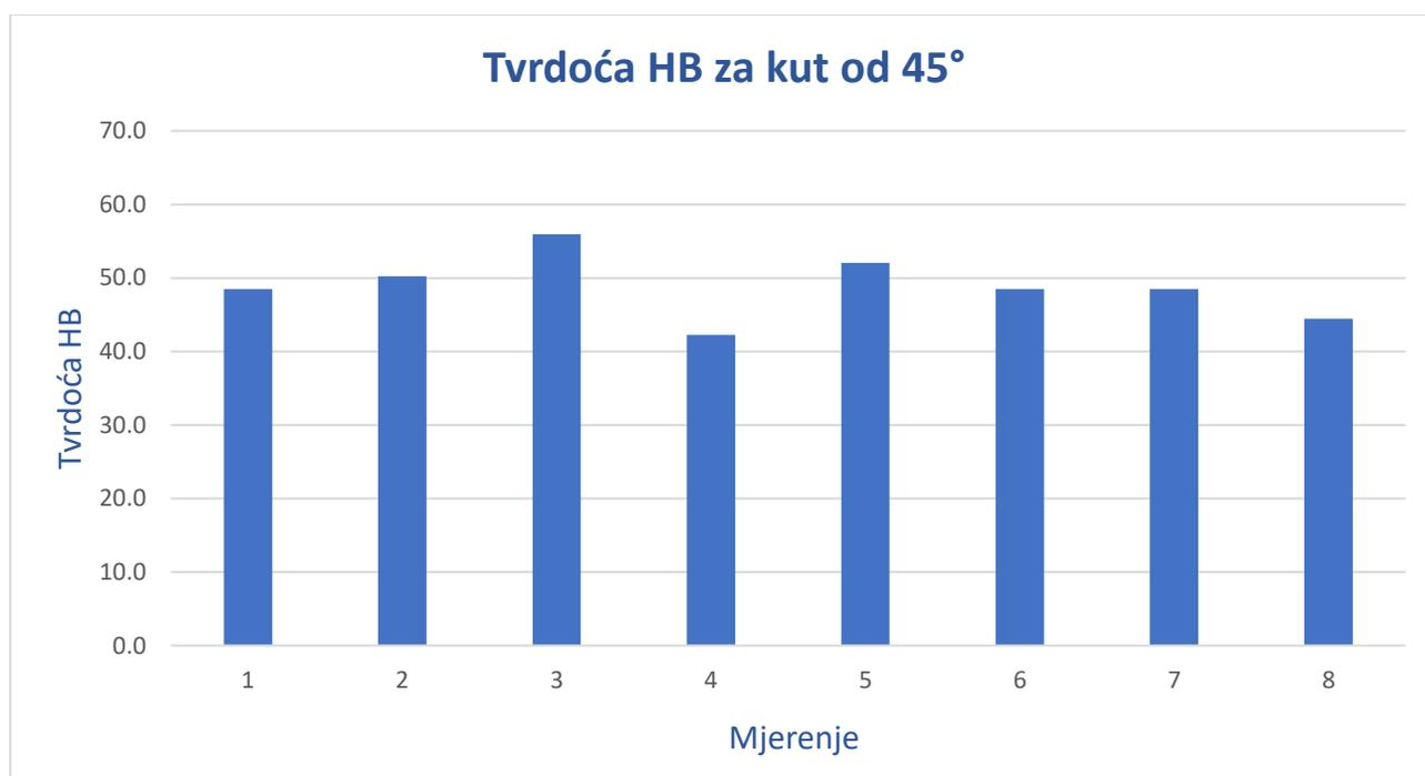
Slika 39. Rasipanje vrijednosti tvrdoće za kut 45°
