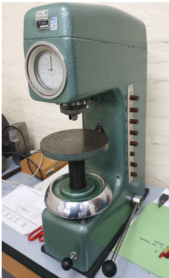
Slika 29. Uređaj za mjerenje tvrdoće Brinellovom metodom
