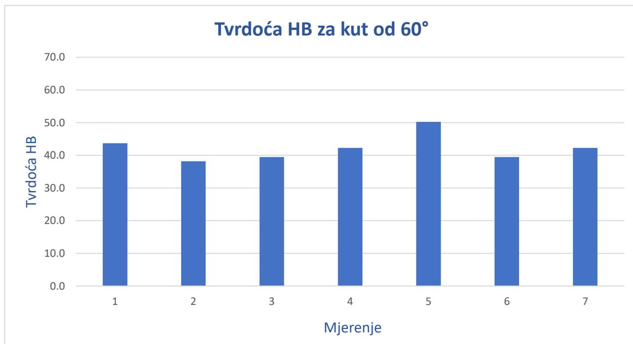
Slika 40. Rasipanje vrijednosti tvrdoće za kut 60°
