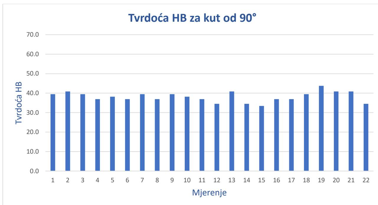
Slika 41. Rasipanje vrijednosti tvrdoće za kut 90°
