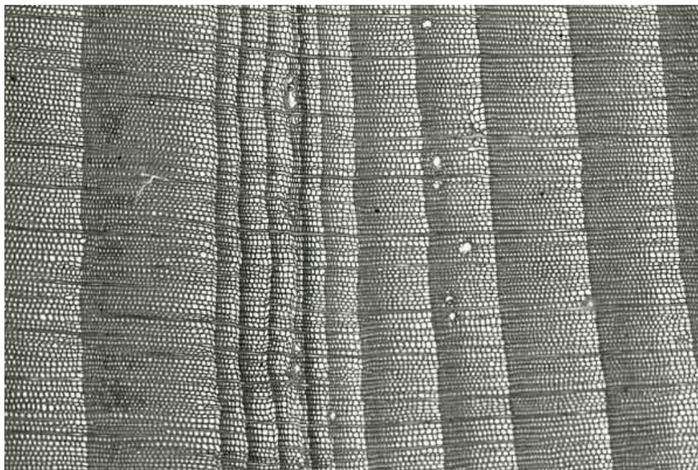
**Slika 22. Mikrostruktura drva smreke u poprečnom presjeku [28]**
