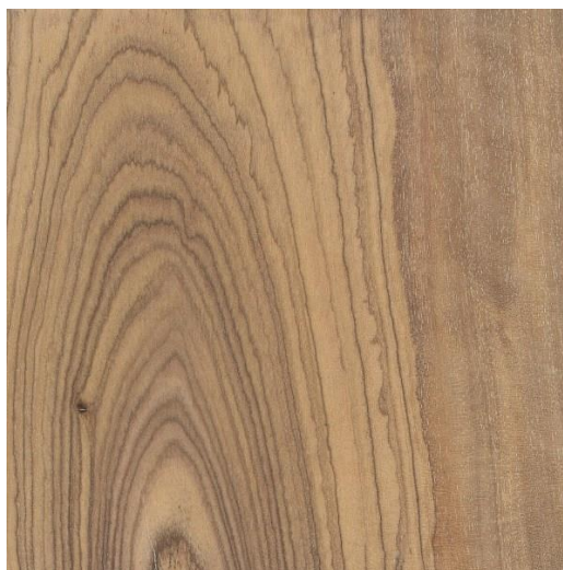
Slika 19. Mikrostruktura drva masline, tangencijalni presjek [23]
