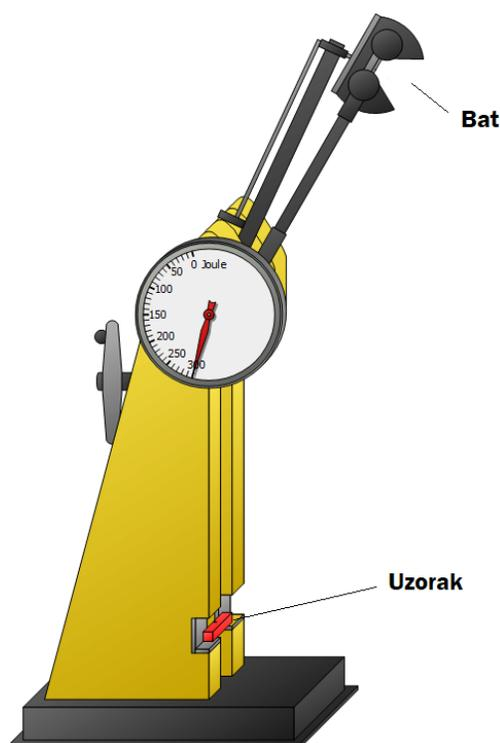
Slika 15. Metoda ispitivanja žilavosti Charpyjevim batom [17]
