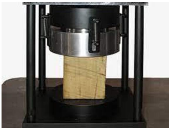
**Slika 12. Ispitivanje tlačne čvrstoće [15]**
