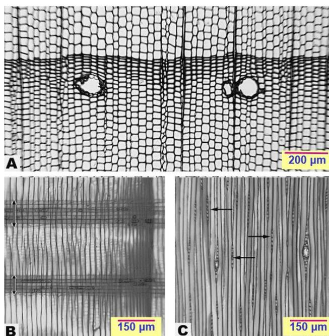
Slika 3. Karakteristični presjeci kroz četinjaču: A-poprečni, B-radijalni, C-tangencijalni [3]
