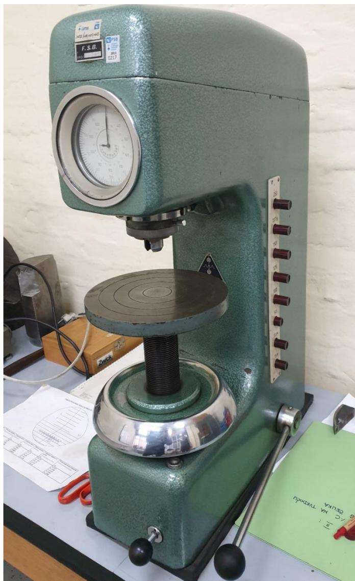
Slika 29. Uređaj za mjerenje tvrdoće Brinellovom metodom
