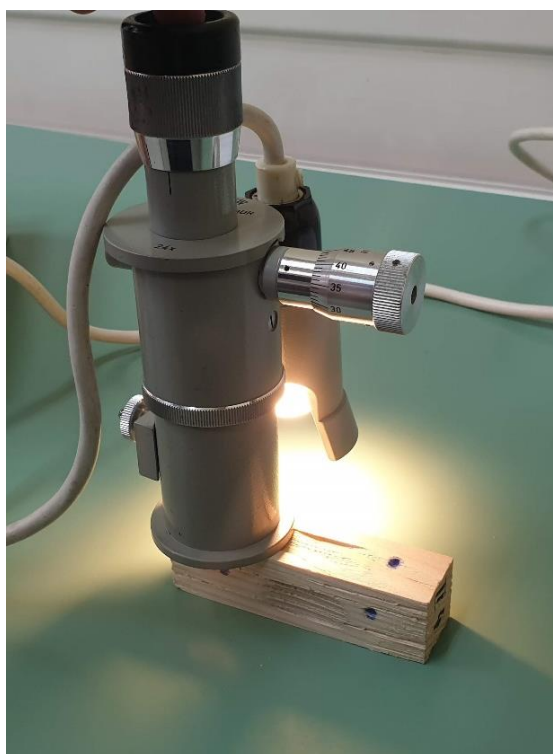
Slika 31. Mjerenje otisaka na uzorku
