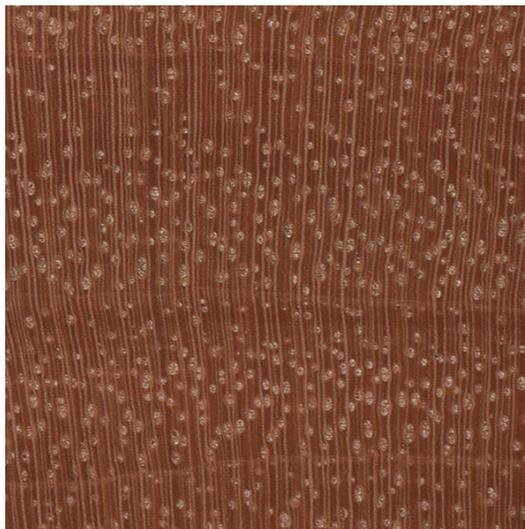
**Slika 18. Mikrostruktura najtvrdje vrste drva, poprečni presjek [22]**
