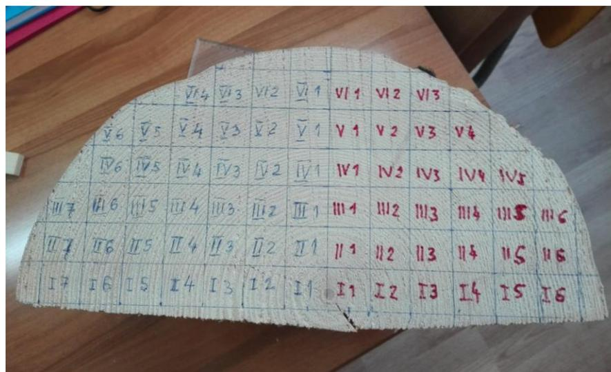
Slika 24. Raspored uzoraka na poprečnom presjeku debla
