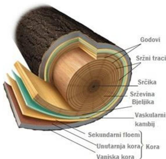
**Slika 7. Poprečni presjek debla [6]**
