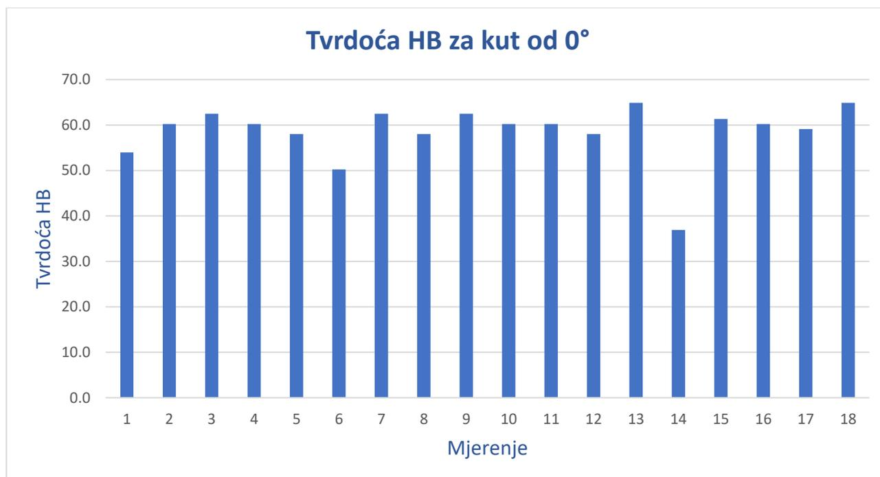
Slika 37. Rasipanje vrijednosti tvrdoće za kut 0°
