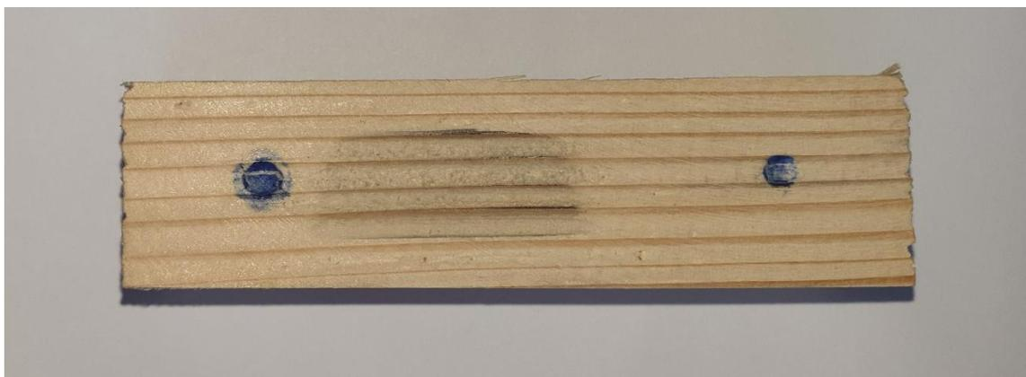
**Slika 32. Otisci na uzorku nakon mjerenja tvrdoće**
