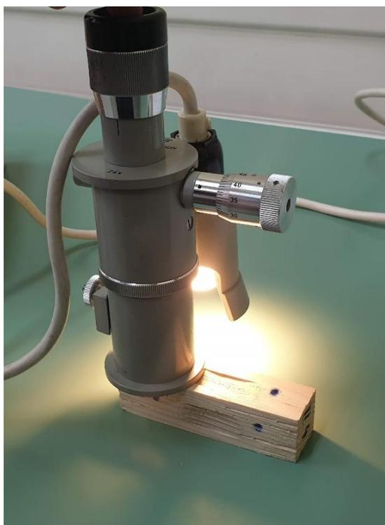
**Slika 31. Mjerenje otisaka na uzorku**
