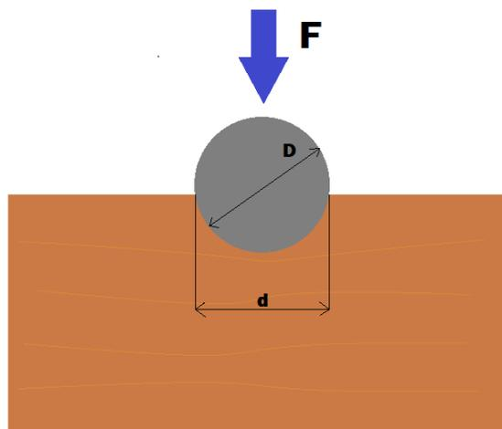
Slika 20. Shematski prikaz ispitivanja tvrdoće Brinellovom metodom
