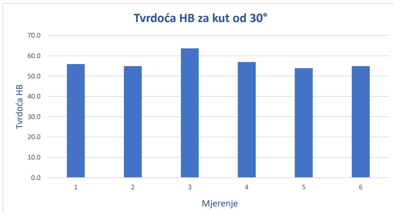
Slika 38. Rasipanje vrijednosti tvrdoće za kut 30°
