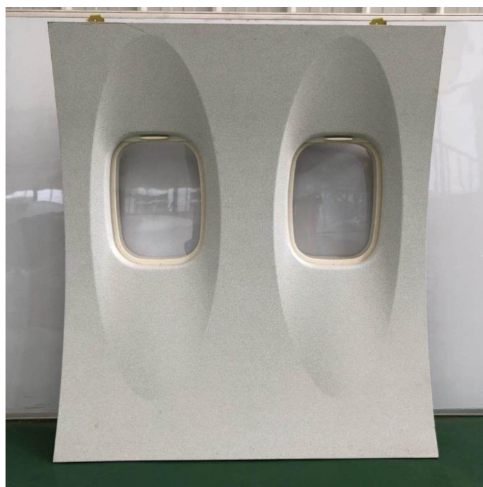
Slika 12. Unutarnja ploča zrakoplova MA600 [35]
