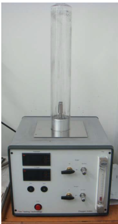
Slika 19. Uređaj za ispitivanje graničnog indeksa kisika [17]
