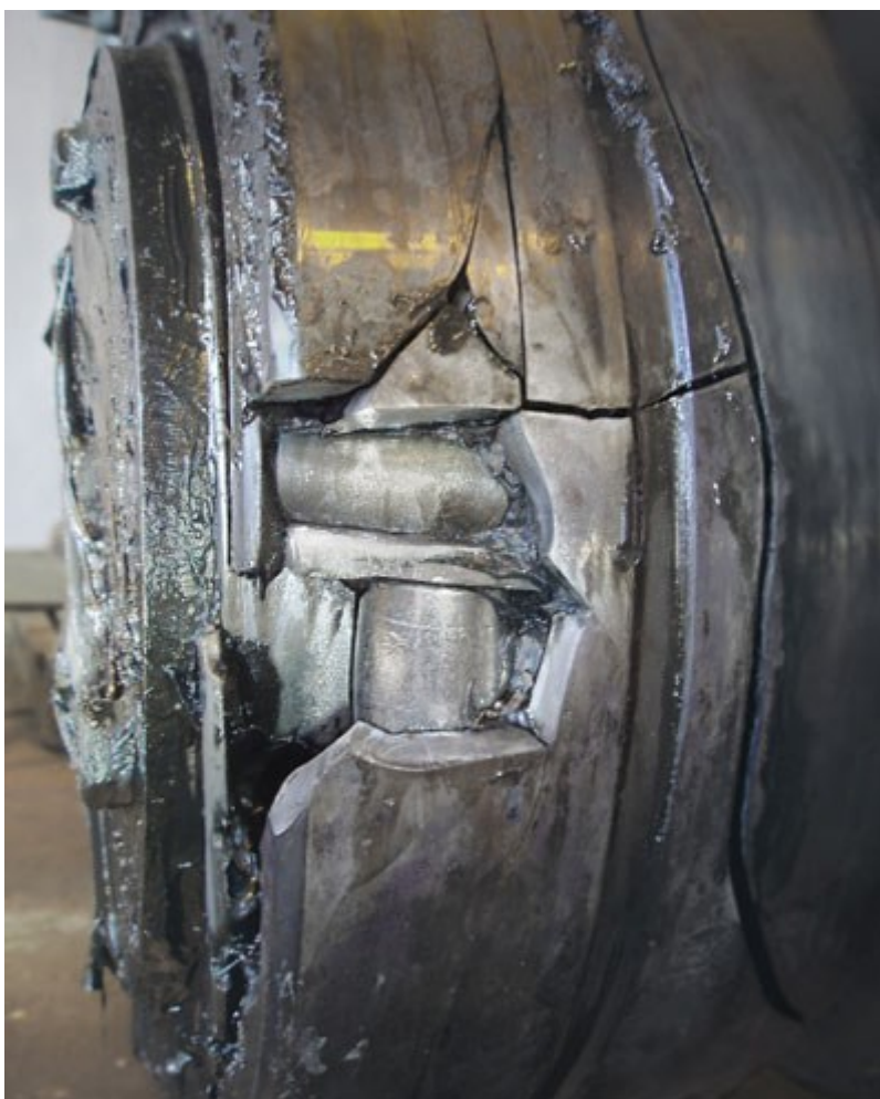
Slika 4. Pokvaren ležaj koji više nije u funkciji [7]
