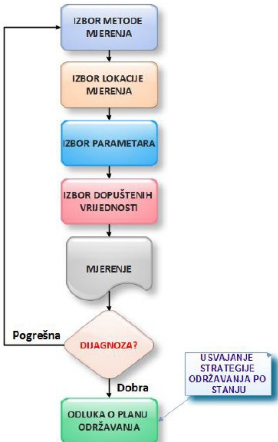
Slika 8. Postupak uvođenja održavanja po stanju kontrolom parametara [1]
