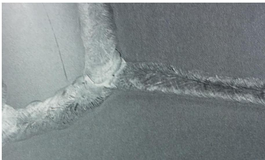
Slika 29: Izgled zavarenog spoja nakon kemijske obrade površine [29]
