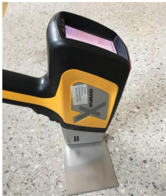
Slika 33: Ispitivanje kemijskog sastava uzorka XRF metodom
