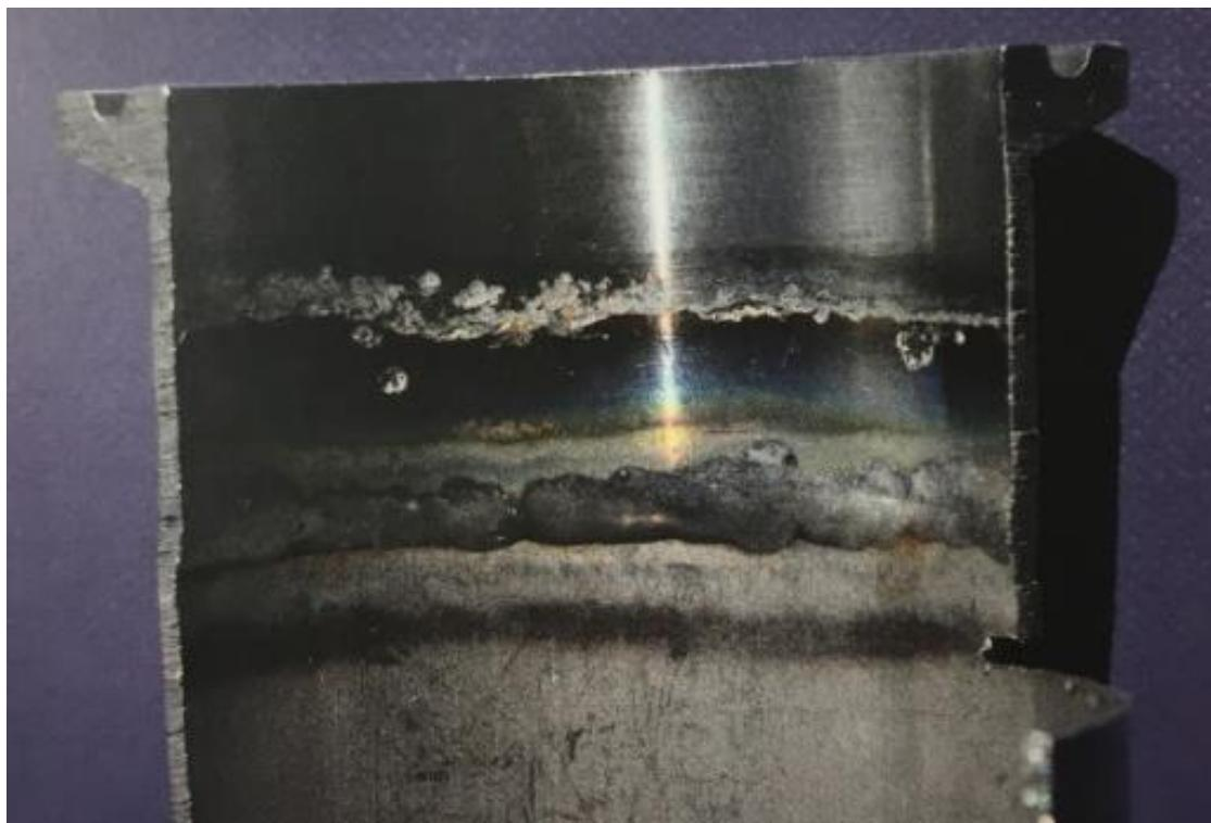
Slika 17: Rupičasta korozija na pobojenoj površini cijevi [29]
