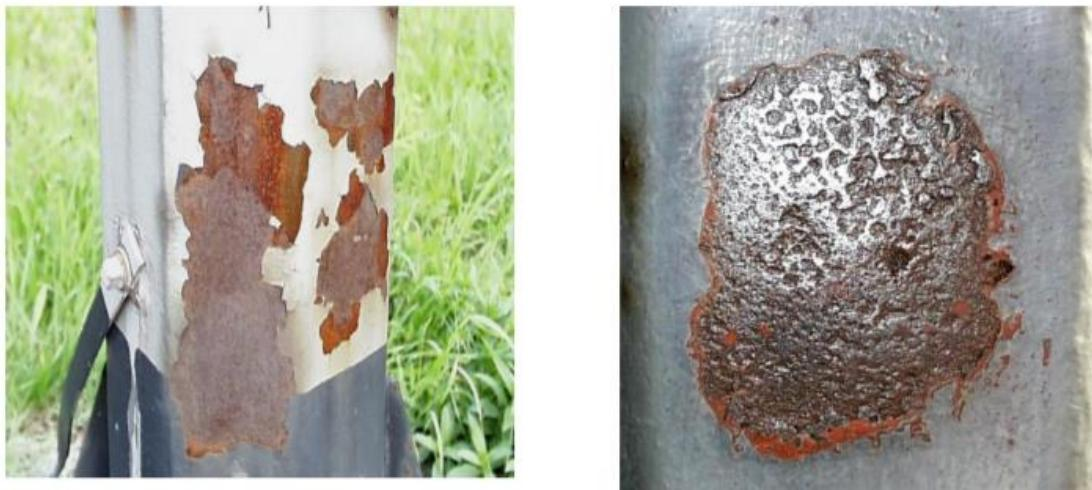
Slika 3: Prikaz ravnomjerne i neravnomjerne opće korozije [5]
