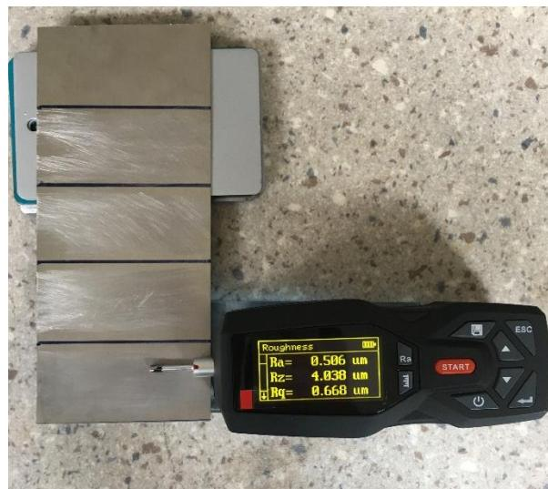
**Slika 36: Mjerenje hrapavosti površine**
