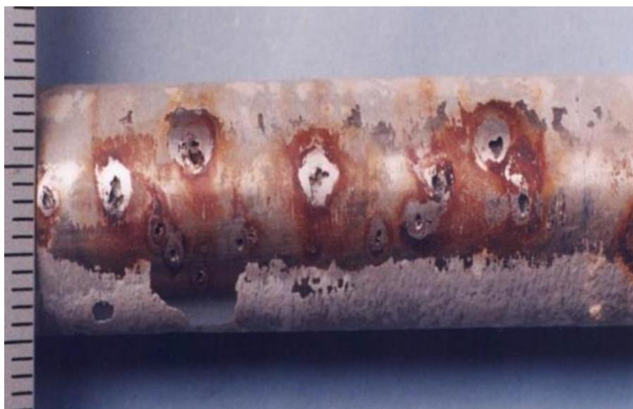
Slika 4: Zaštitna cijev grijачa bojlera AISI 304 [3]
