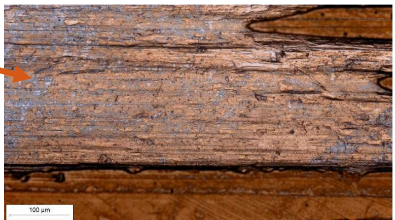
Slika 10.23. Alatni čelik K110 oznake D2 (TiN/TiCN prevlaka) na povećanju 100 puta
