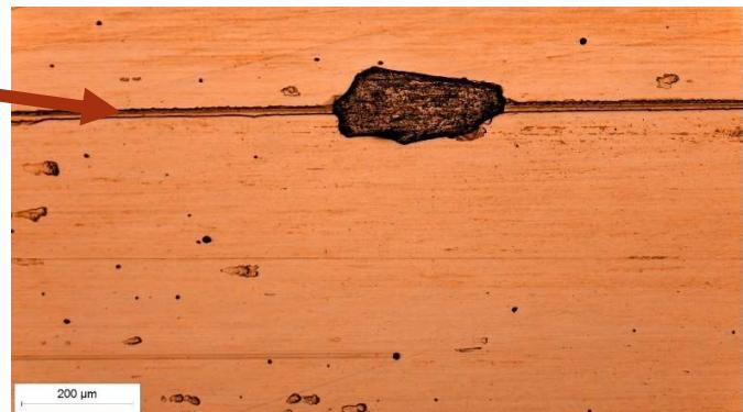
**Slika 10.17.** Alatni čelik K390 MC oznake C3 (TiN/TiBN prevlaka) na povećanju 100 puta
