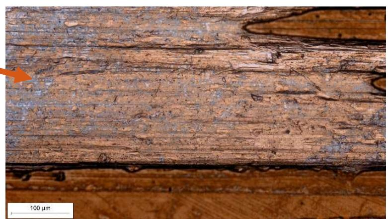
**Slika 10.24.** Alatni čelik K110 oznake D2 (TiN/TiCN prevlaka) na povećanju 200 puta
