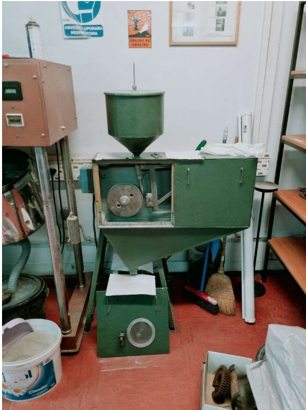
Slika 10.1. Uređaj za abrazijsko trošenje
