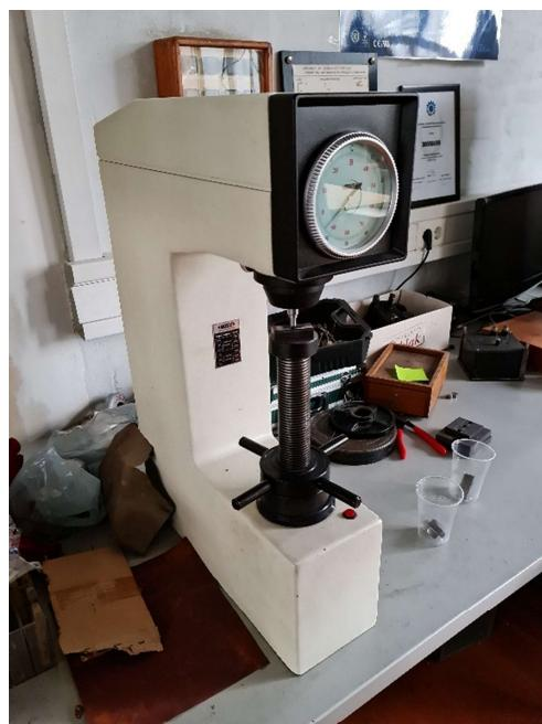
**Slika 9.1. Uredaj za ispitivanje tvrdoće Rockwell C metodom**
