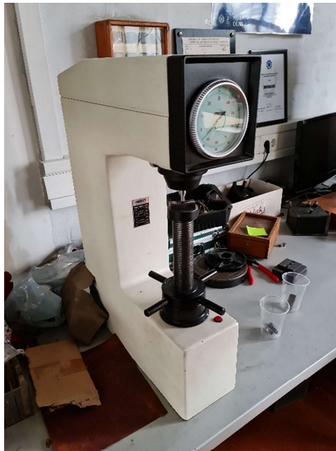
Slika 9.1. Uređaj za ispitivanje tvrdoće Rockwell C metodom
