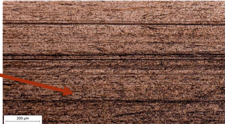
Slika 10.11. Alatni čelik K390 MC oznake C1 (plazma nitriranje) na povećanju 100 puta
