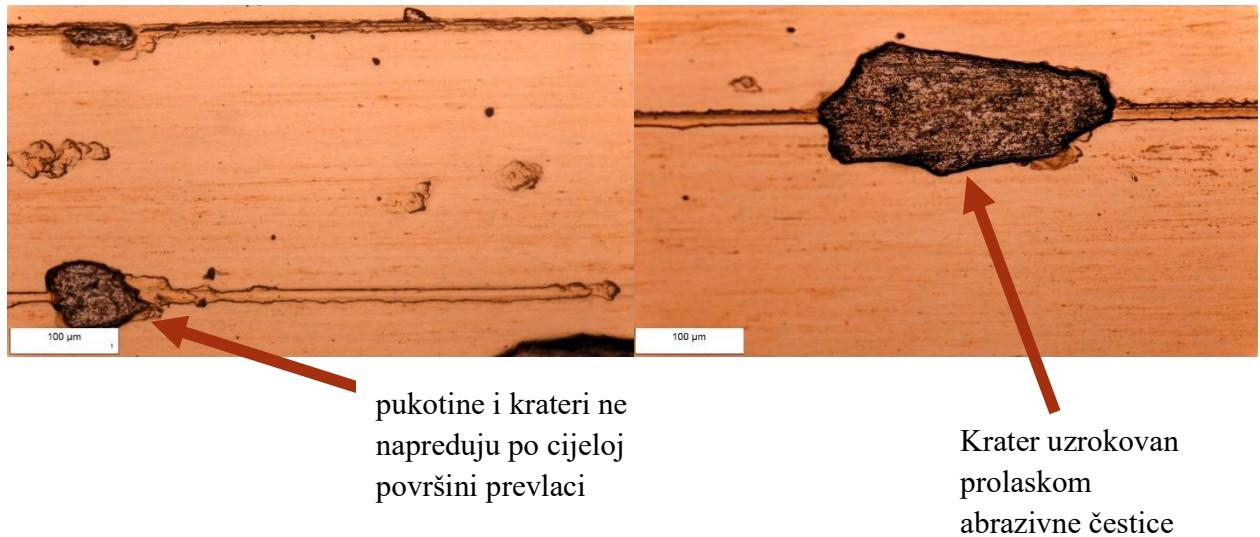
**Slika 10.18.** Alatni čelik K390 MC oznake C3 (TiN/TiBN prevlaka) na povećanju 200 puta
