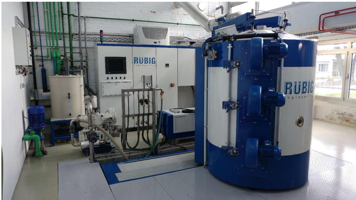
**Slika 8.2 Industrijska vakuumska peć Rübig GmbH type PC 70/90 [5]**
